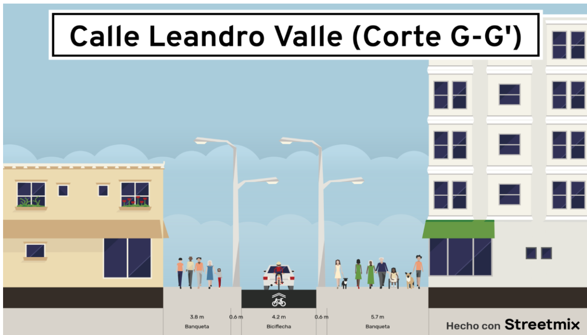
Figura 42. El corte G-G' de la calle Leandro Valle muestra el ensanchamiento de la banqueta por medio de orejas en su intersección con Av. 16 de Septiembre. (Elaboración propia con la herramienta Streetmix)
