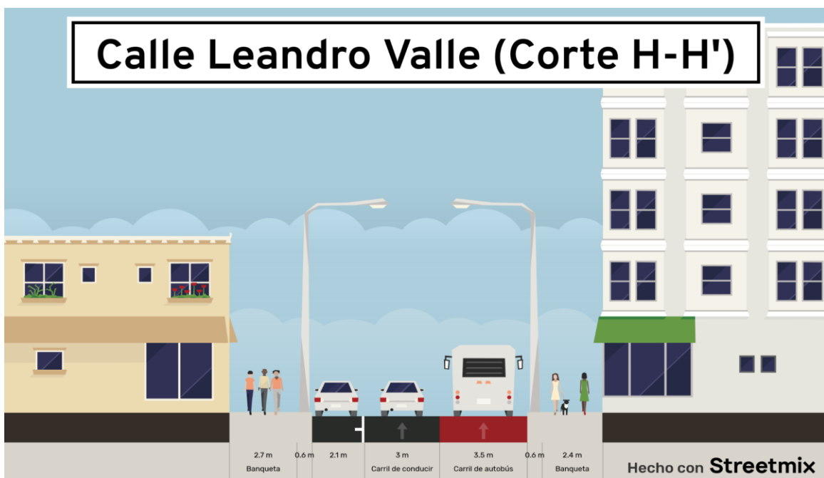
Figura 43. El corte H-H' de la calle Leandro Valle muestra la redistribución de los carriles para contemplar uno de estacionamiento, uno de circulación y otro para paradas de transporte público. (Elaboración propia con la herramienta Streetmix)
