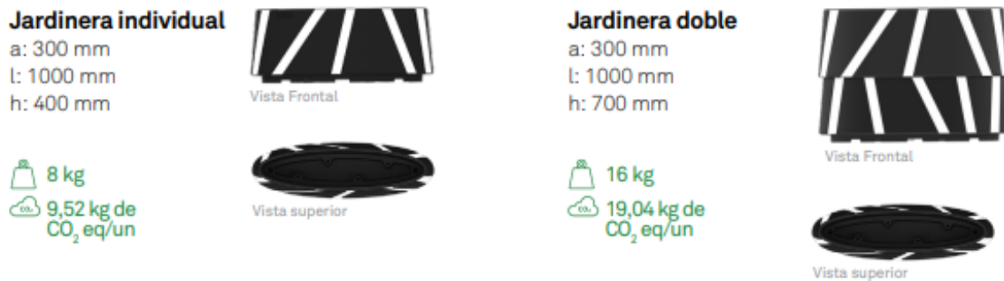
Figura 54. Dimensiones y especificaciones de separadores Zebra ® | Jardinera. (ZICLA, 2021)
