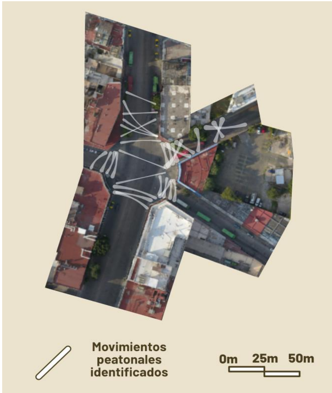
Figura 28. Movimientos peatonales identificados, incluyendo líneas de deseo. (Elaboración propia) (Foto tomada por grupo PAP Movilidad Urbana Sustentable Primavera 2021)
