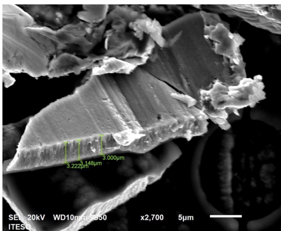
Figura 25, Muestra realizada por electrodeposición con 3.9 V durante 5 min.
