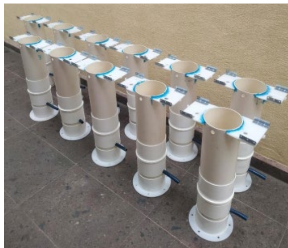
Figura 5. Pluviómetros terminados en aspecto mecánico.
