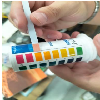
Figura 7. Medición con tiras de pH.
