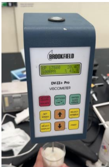
Figura 9. Display del viscosímetro BROOKFIELD en proceso de medición.
