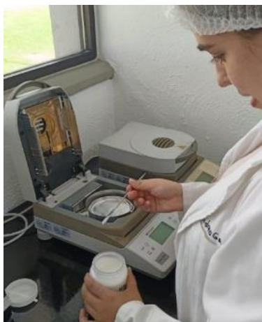
Figura 11. Medición de muestra de grafito blanco.
