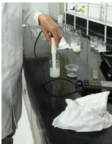
Figura 1. Medición de pH con potenciómetro de una solución.
