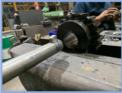
Imagen: Proceso de cuñero en mandriladora
