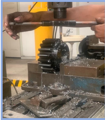
Imagen: Proceso de machuelado en engrane
