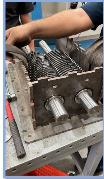
Armado de la máquina no es sencillo y se debe utilizar grúa para nivelar los ejes.
