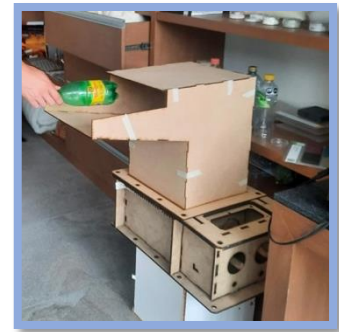
Imagen: Tolva superior propuesta 2, cortada en laser con MDF 3mm
