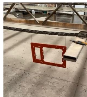
Pieza superior de la maquina pintado con anticorrosivo.
