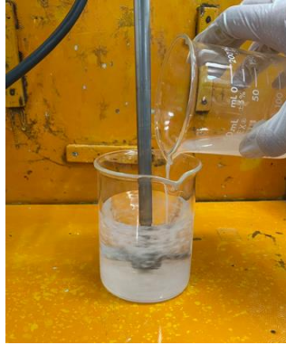
Figura 2. Incorporación de PLA en emulsión en agitación.
