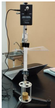
Figura 14. Sistema de mediciones elásticas
