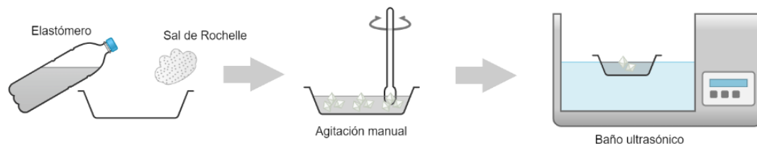
Figura 10. Diagrama de metodología de fabricación de compuesto piezoeléctrico
