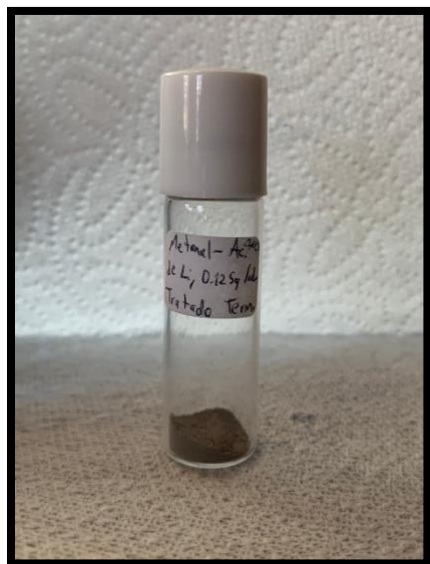
Figura 9. Muestra de carbonato de litio obtenida en el PAP primavera 2023, con una concentración de 0.125g/mL de acetato de litio y con tratado térmico.
