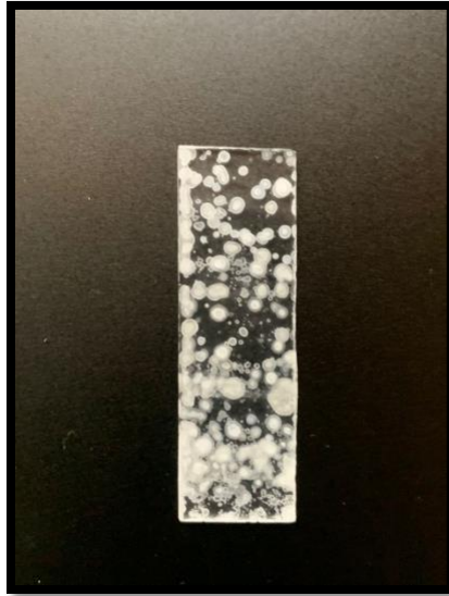
Figura 2. Muestra A final del sustrato de vidrio secado con mufla después de cada inmersión.
