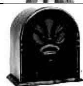
Consiste en un circuito eléctrico, diseñado de tal forma que permite filtrar o separar una corriente pequeñísima, que se genera en la antena, por efecto de las ondas electromagnéticas (inducción electromagnética) que llegan por
