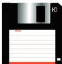
Un disquete o disco flexible (*floppy disk* o *diskette*) es un medio de almacenamiento o soporte de almacenamiento de datos formado por una pieza circular de material magnético, fina y flexible (de ahí su denominación) encerrada en una cubierta de plástico, cuadrada o rectangular, que se puede utilizar en una computadora o laptop.
