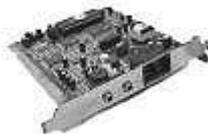
Un módem (Modulador Demodulador) es un dispositivo que sirve para enviar una señal llamada moduladora mediante otra señal llamada portadora. Los esfuerzos para el desarrollo de los primeros módems digitales tienen su origen en la necesidad de transmitir datos para de la defensa aérea de Estados Unidos durante la década de 1950.
