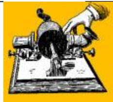
El dispositivo consistía en un tambor cilíndrico envuelto en papel de aluminio y montado en un eje roscado. Una boquilla unida a un diafragma estaba conectada a una aguja que graba patrones de vibración de una fuente de sonido en la lámina giratoria.
