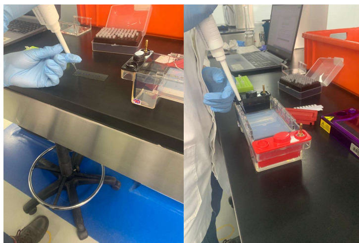
Figura 12. Preparación y carga de muestras para metodología de Electroforesis
