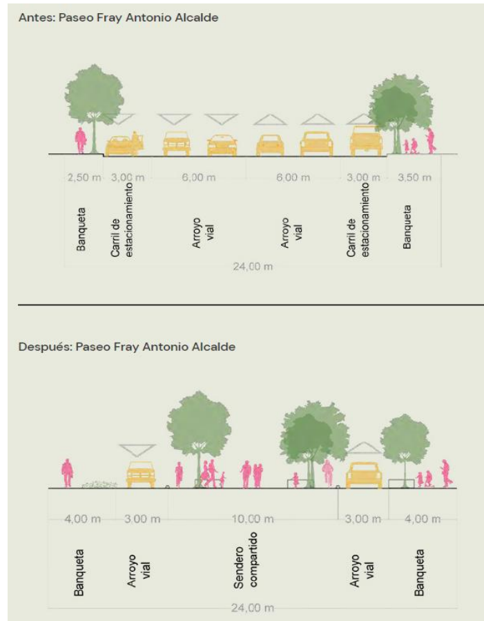
Figura 8. Comparativa de las secciones de corte transversal de Paseo Fray Antonio Alcalde. ITDP México. (2023)
