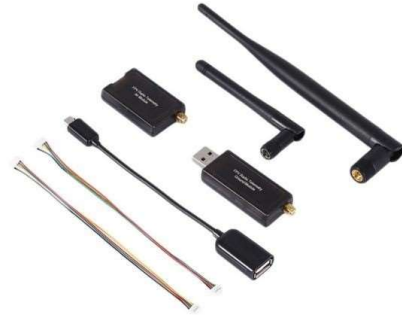
Figura 19 Antenas y módulo para telemetría
