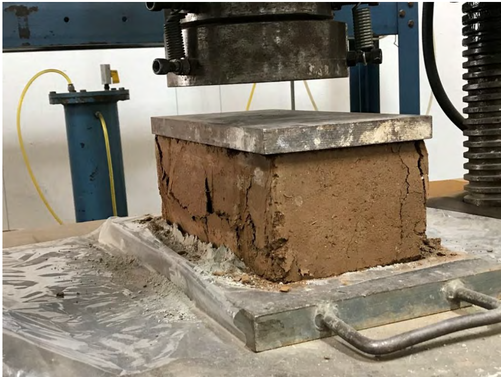
BTC (2)-2 ANTES DE LA PRUEBA A COMPRESIÓN.
