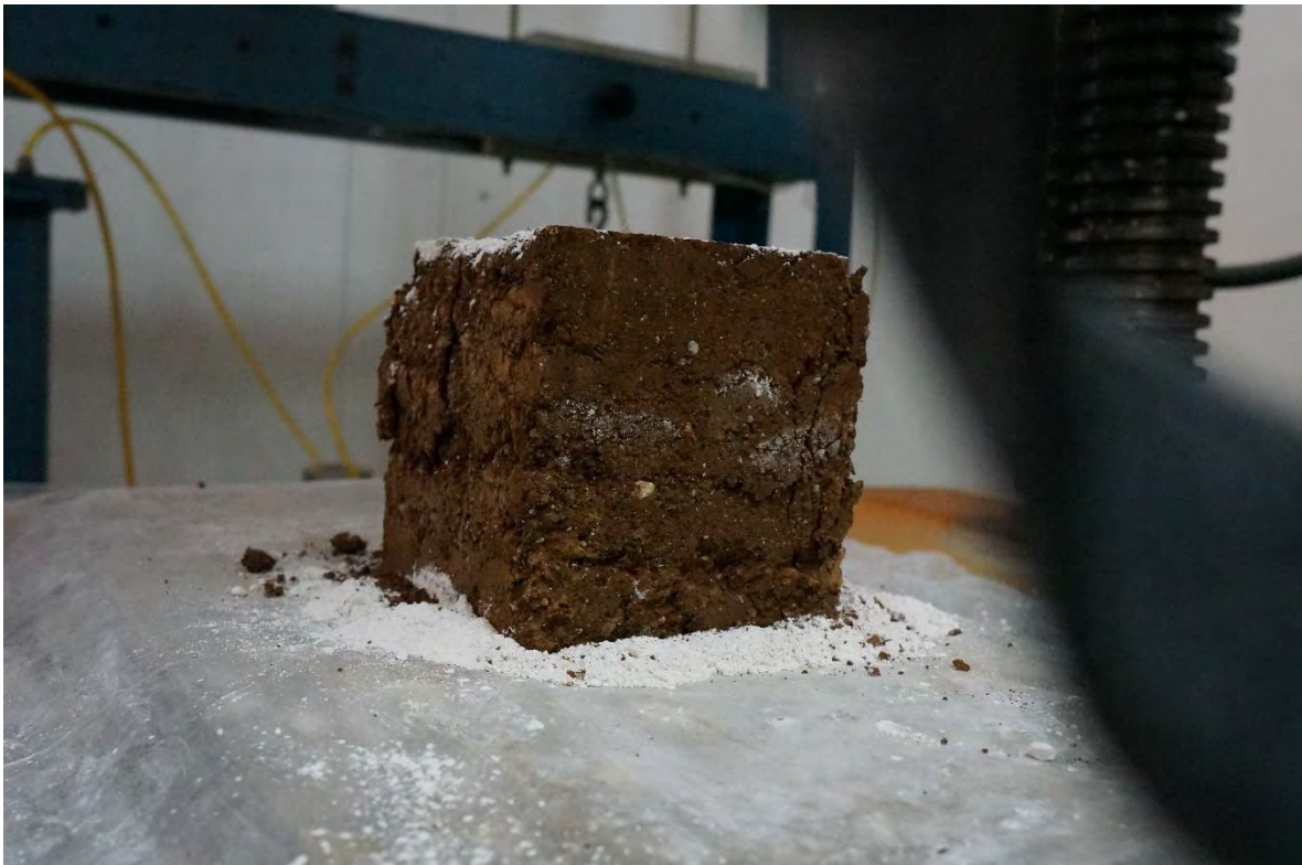
TAPIAL-3 DESPUÉS DE LA PRUEBA A COMPRESIÓN.
