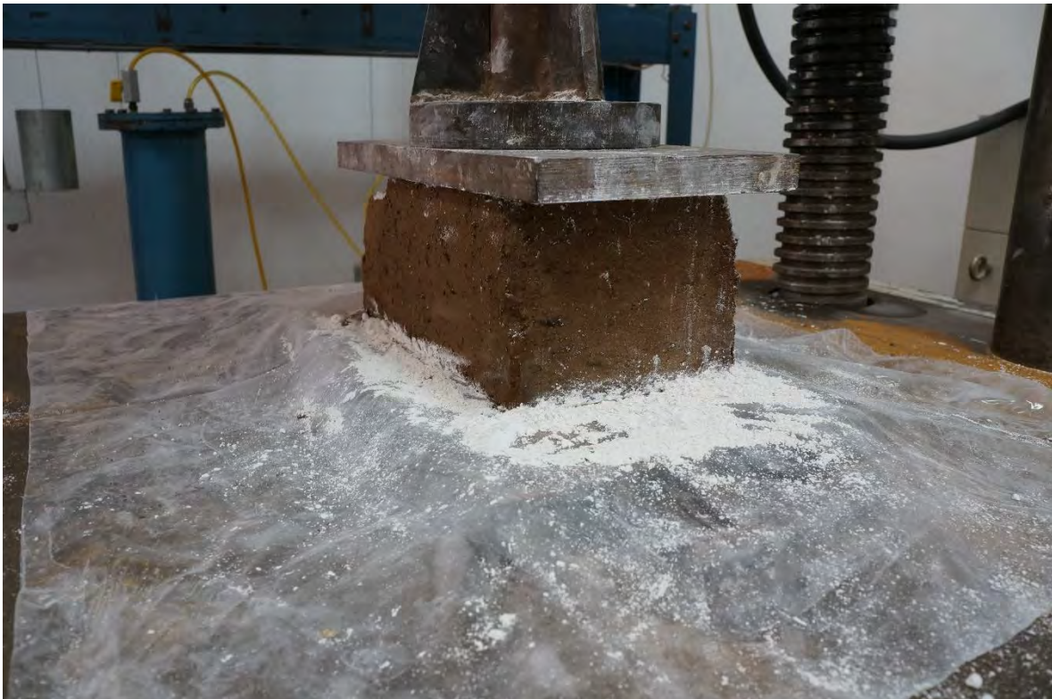
BTC-16 ANTES DE LA PRUEBA A COMPRESIÓN.
