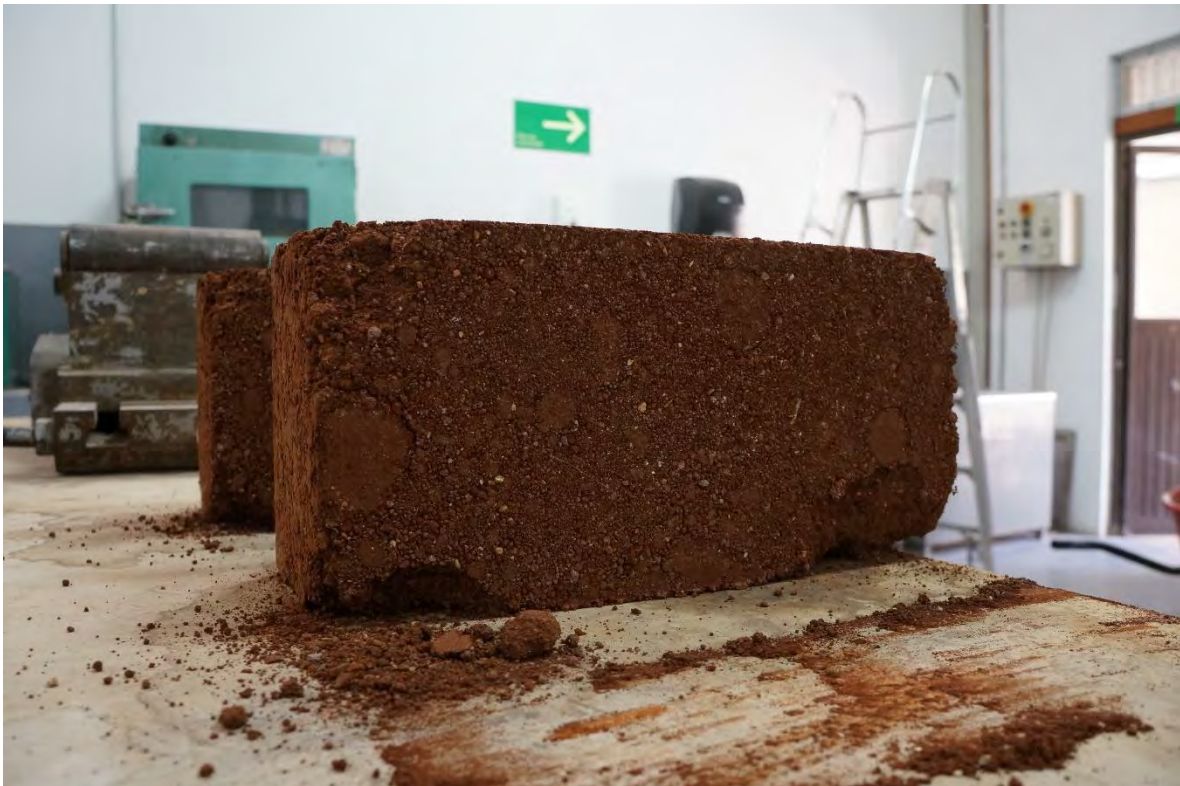
BTC-5 ANTES DE LA PRUEBA A COMPRESIÓN.
