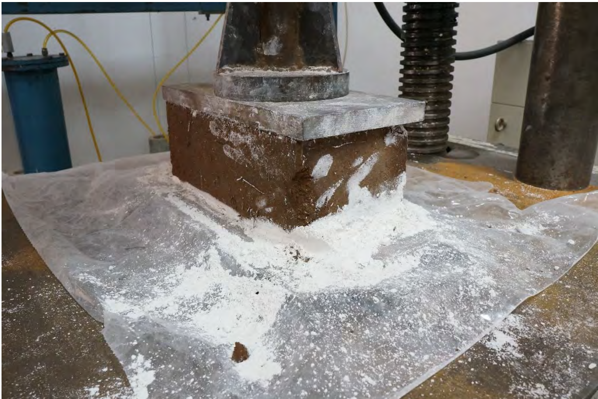
BTC-19 ANTES DE LA PRUEBA A COMPRESIÓN.
