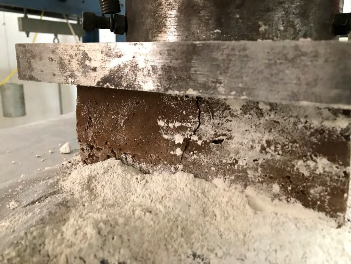
PISO DE TIERRA-2 DESPUÉS DE LA PRUEBA A COMPRESIÓN.
