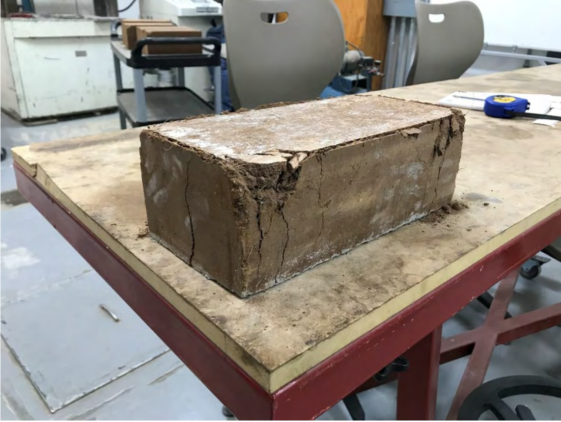
BTC (2)-1 ANTES DE LA PRUEBA A COMPRESIÓN.
