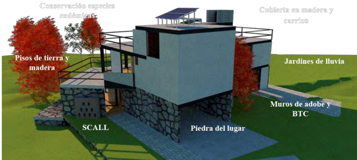
Figura 4.33. Perspectiva de Vivienda Experimental Sustentable Contemporáneo a partir de materiales endémicos. Fuente: Propia, en trabajo de campo 2021.
