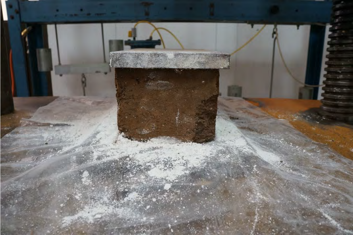
BTC-15 ANTES DE LA PRUEBA A COMPRESIÓN.
