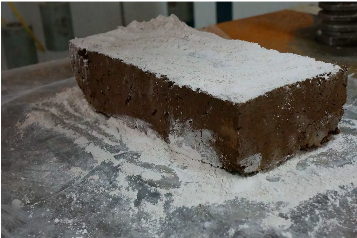
ADOBE-8 ANTES DE LA PRUEBA A COMPRESIÓN.
