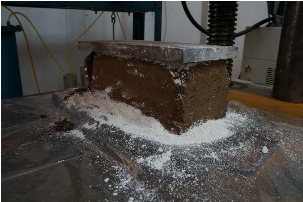
BTC-13 ANTES DE LA PRUEBA A COMPRESIÓN.
