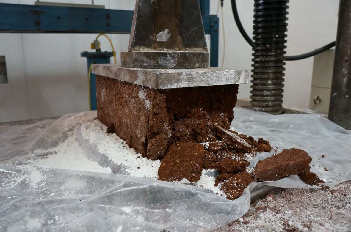
BTC-9 DESPUÉS DE LA PRUEBA A COMPRESIÓN.
