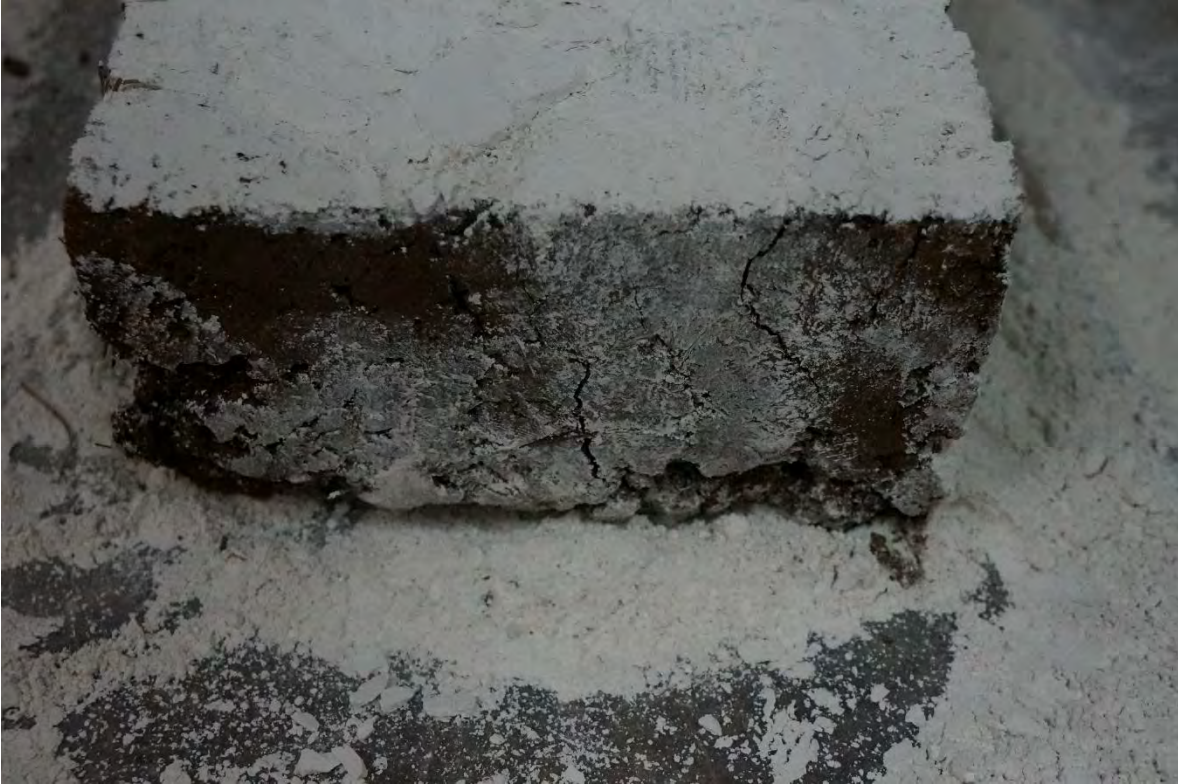
ADOBE-10 DESPUÉS DE LA PRUEBA A COMPRESIÓN.
