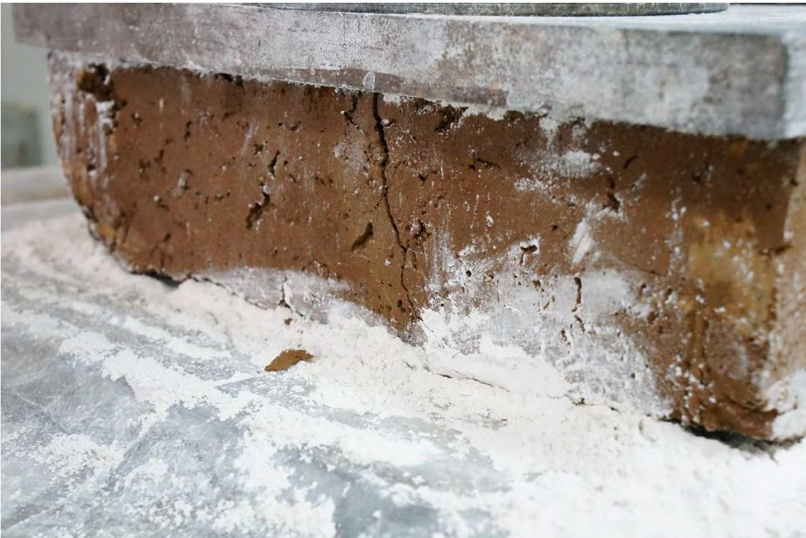
ADOBE-8 DESPUÉS DE LA PRUEBA A COMPRESIÓN.
