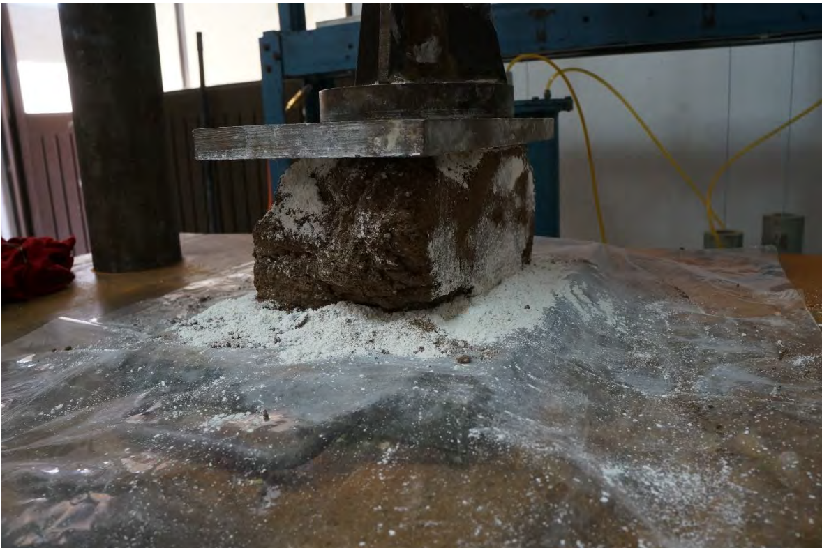
BTC-14 ANTES DE LA PRUEBA A COMPRESIÓN.
