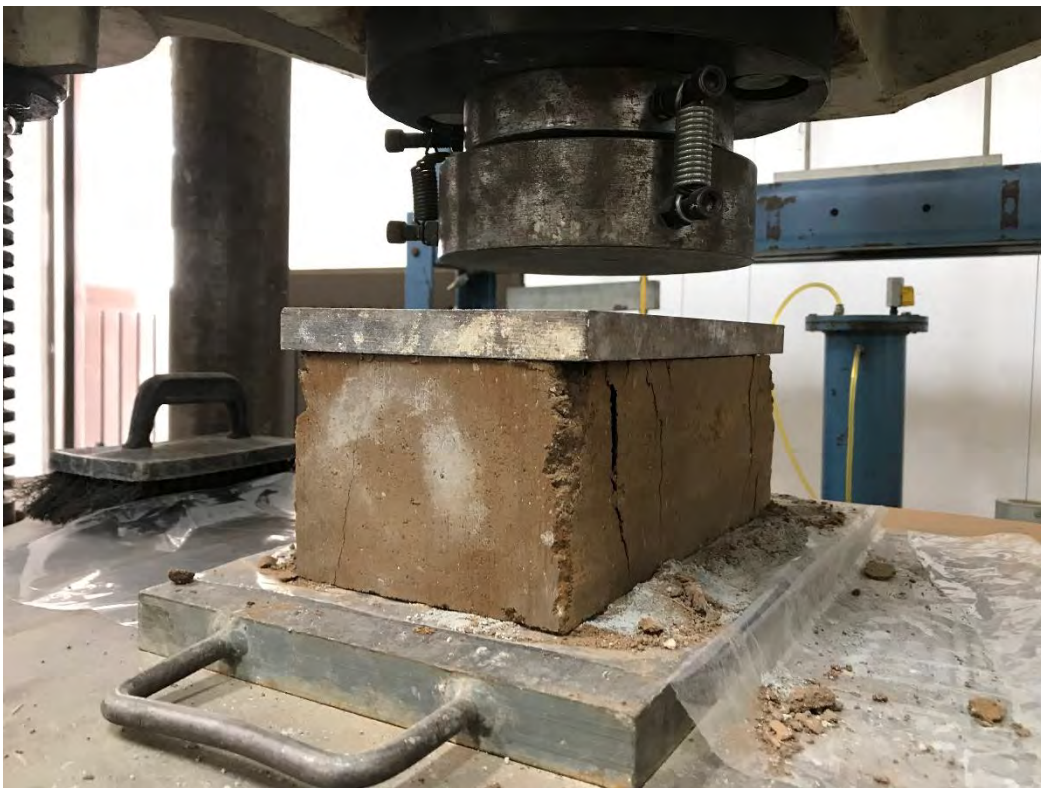
BTC (2)-3 DESPUÉS DE LA PRUEBA A COMPRESIÓN.
