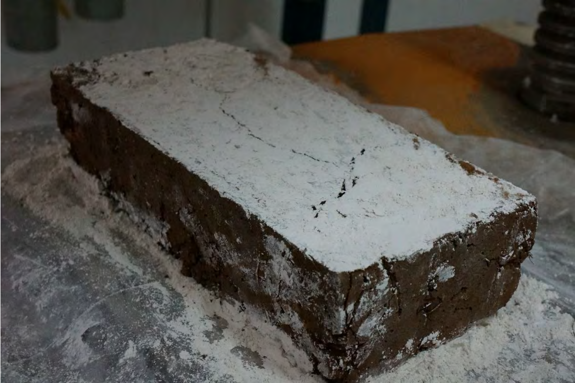
ADOBE-9 DESPUÉS DE LA PRUEBA A COMPRESIÓN.
