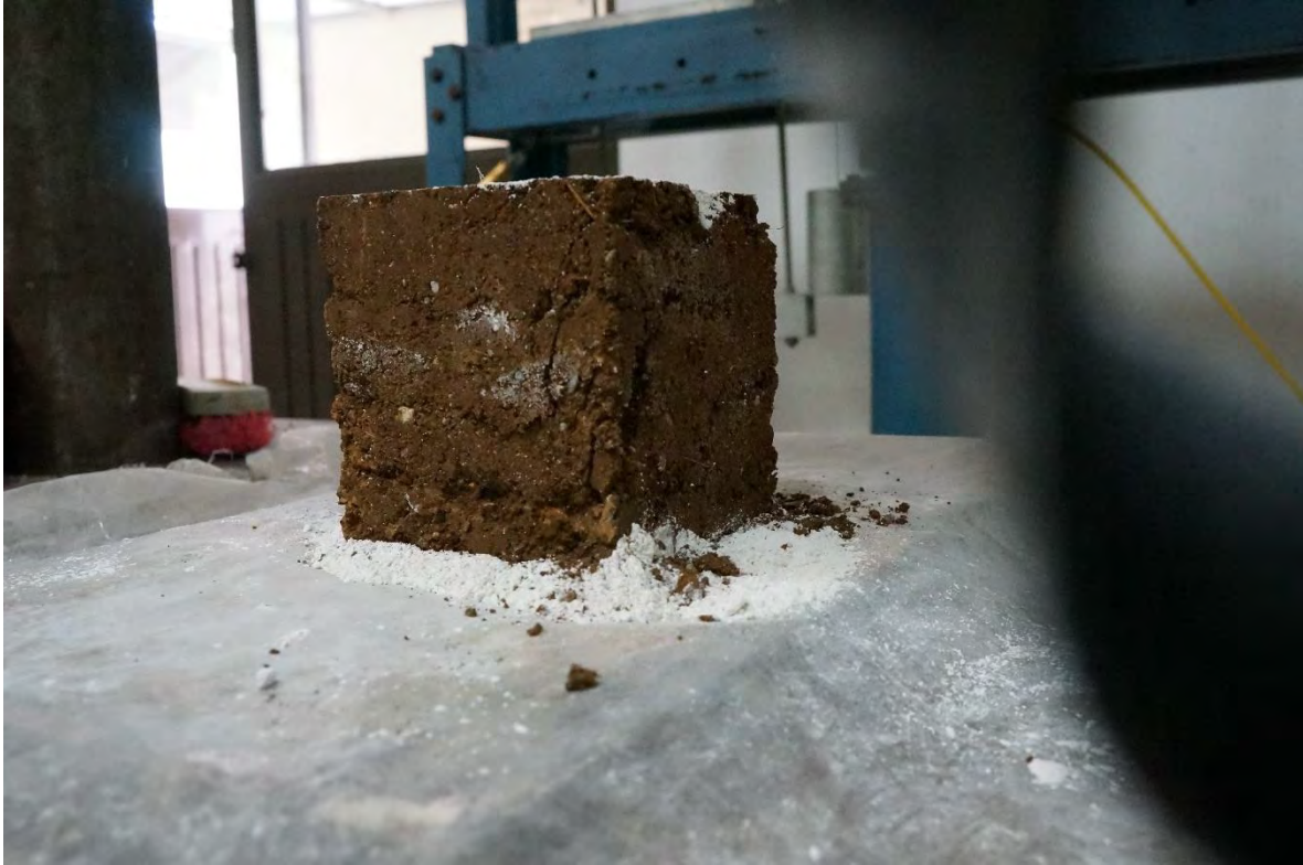
TAPIAL-3 DESPUÉS DE LA PRUEBA A COMPRESIÓN.
