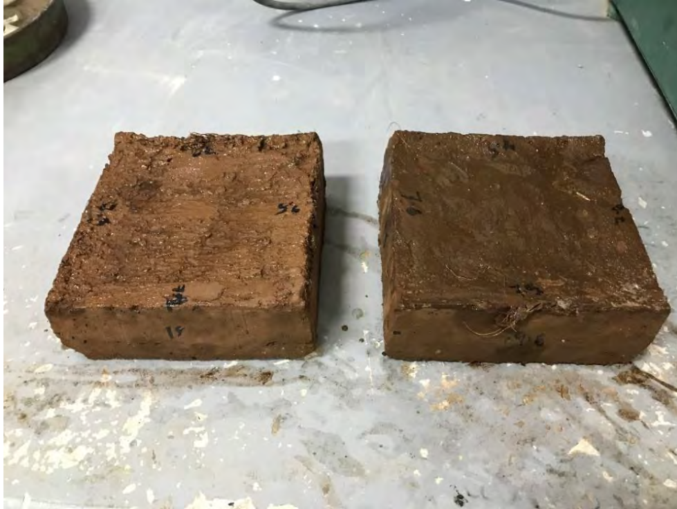
Figura 4.25. Especímenes de piso a temperatura ambiente, antes de la prueba. Fuente: Propia, en trabajo de campo 2021
