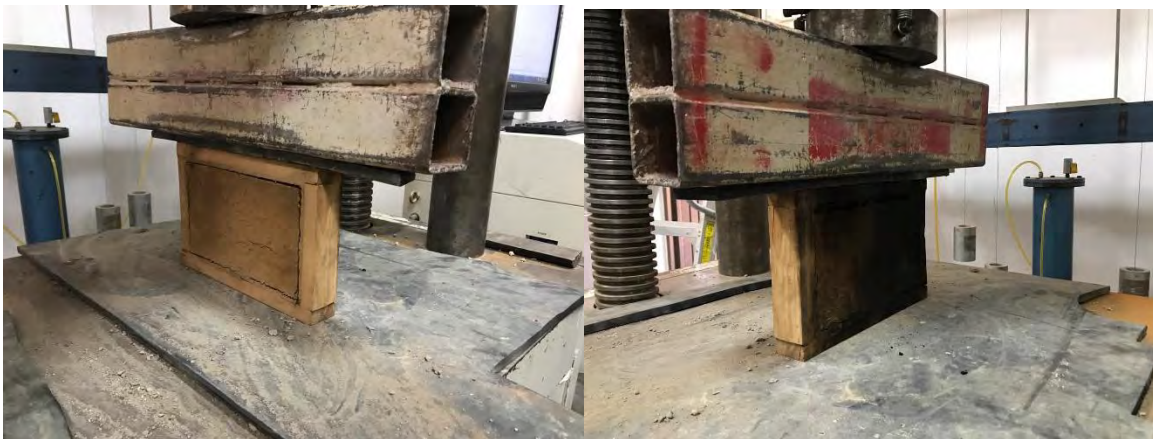
Figura 4.21. Prueba a compresión en prensa universal. Fuente: Propia, en trabajo de campo 2020.
