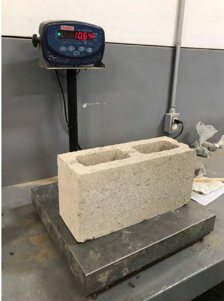
Figura 4.14. Bloque de concreto con el que se probó la cubierta. Fuente: Propia, en trabajo de campo 2021.
