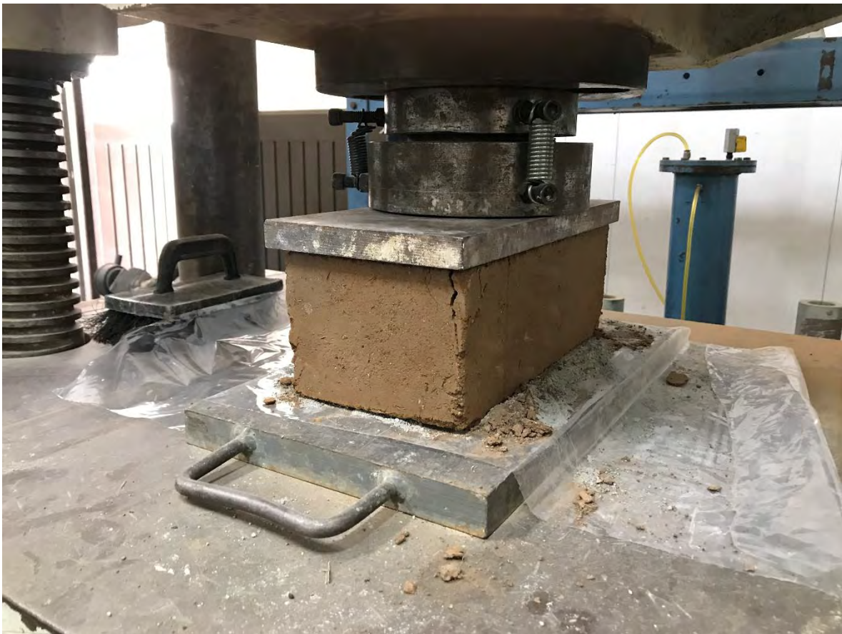
BTC (2)-2 ANTES DE LA PRUEBA A COMPRESIÓN.
