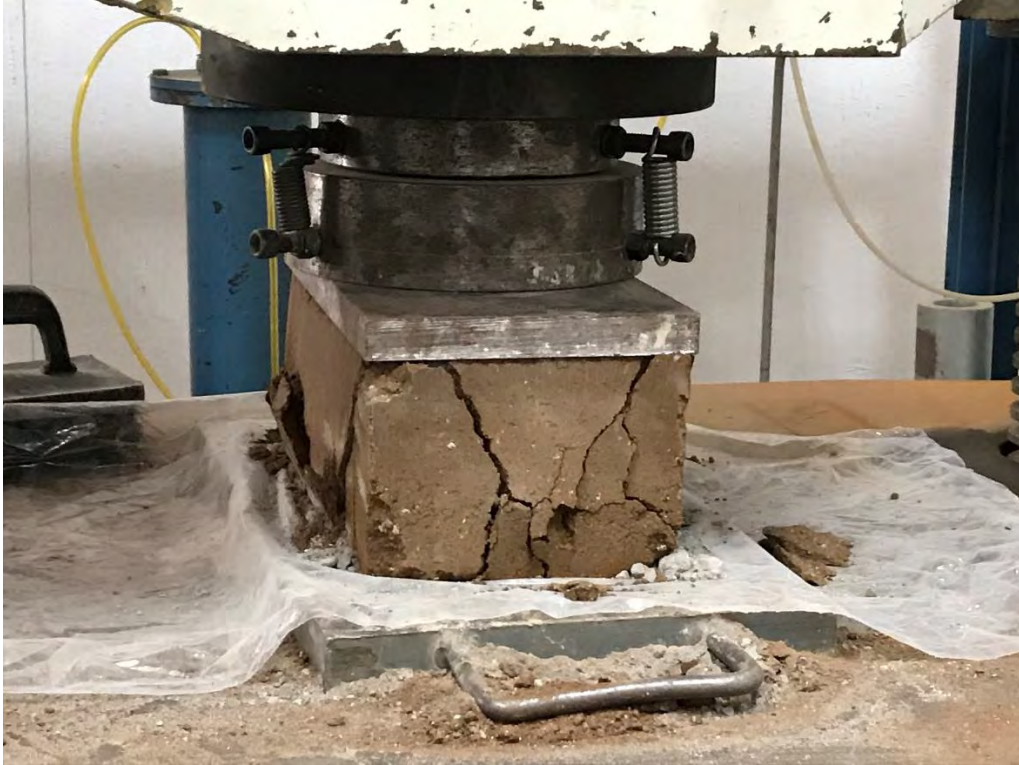
BTC (2)-6 DEPUÉS DE LA PRUEBA A COMPRESIÓN.
