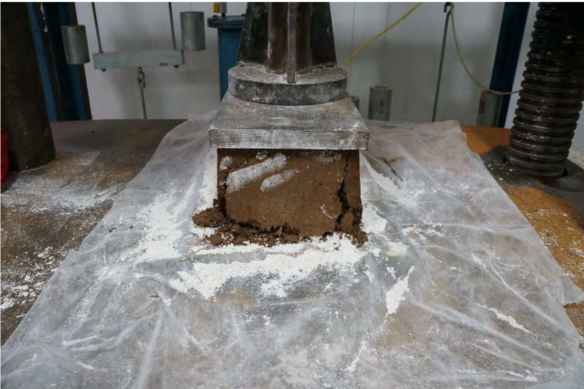
BTC-21 DESPUÉS DE LA PRUEBA A COMPRESIÓN
