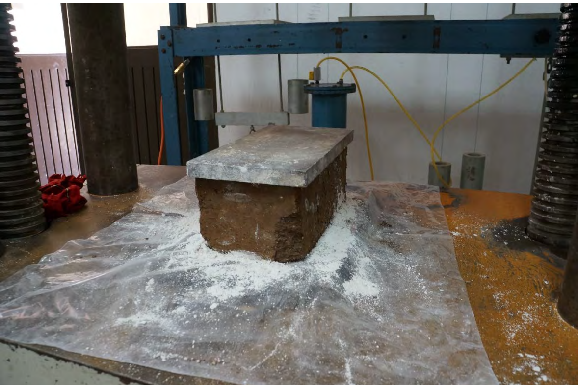
BTC-15 ANTES DE LA PRUEBA A COMPRESIÓN.
