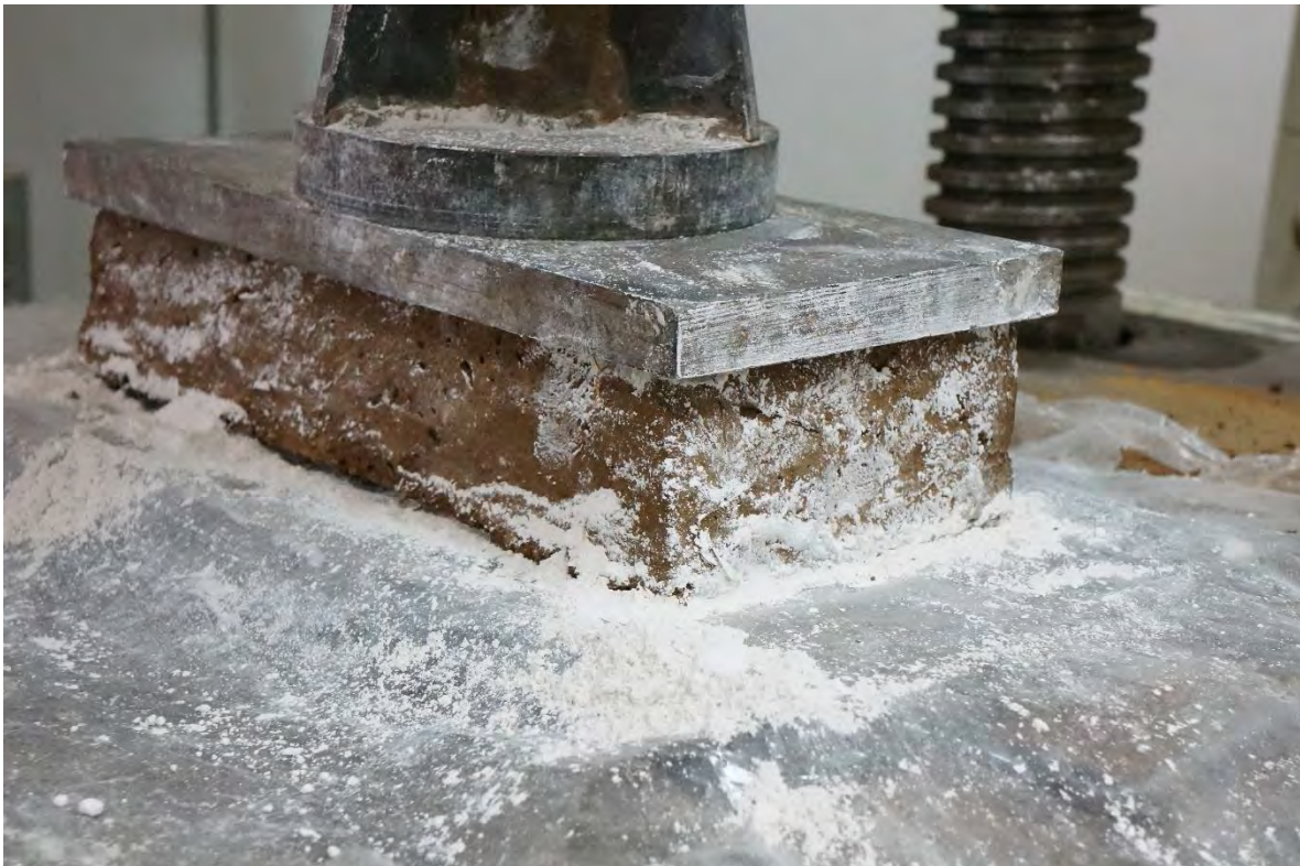
ADOBE-6 ANTES DE LA PRUEBA A COMPRESIÓN.
