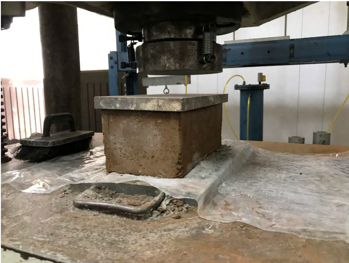
BTC (2)-5 ANTES DE LA PRUEBA A COMPRESIÓN.
