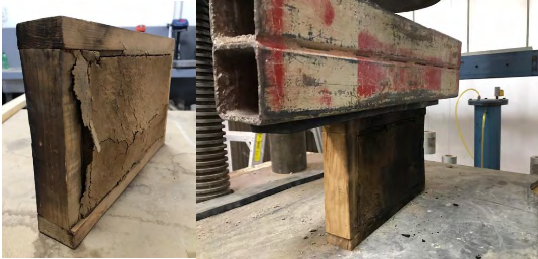
Figura 4.22. y 4.23. Prueba a compresión en prensa universal. Fuente: Propia, en trabajo de campo 2020.
