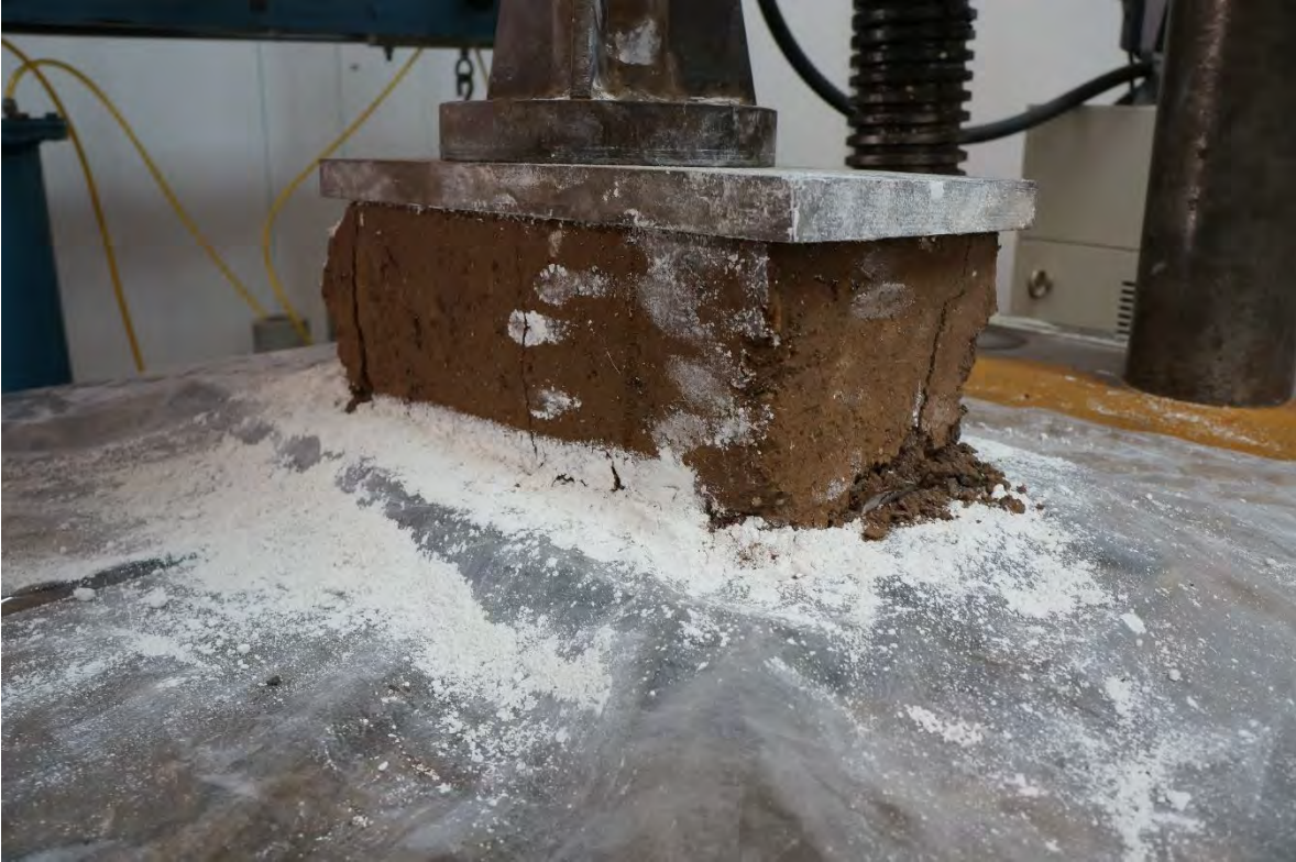
BTC-15 DESPUÉS DE LA PRUEBA A COMPRESIÓN.
