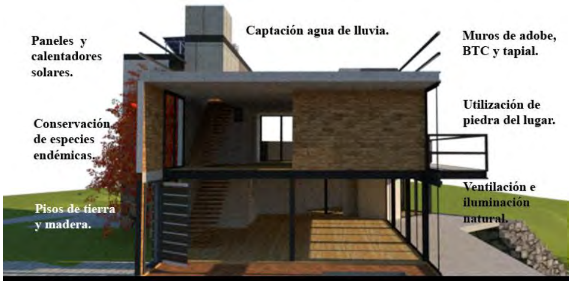
Figura 4.34. Esquema de Vivienda Experimental Sustentable Contemporáneo a partir de materiales endémicos. Fuente: Propia, en trabajo de campo 2021.
