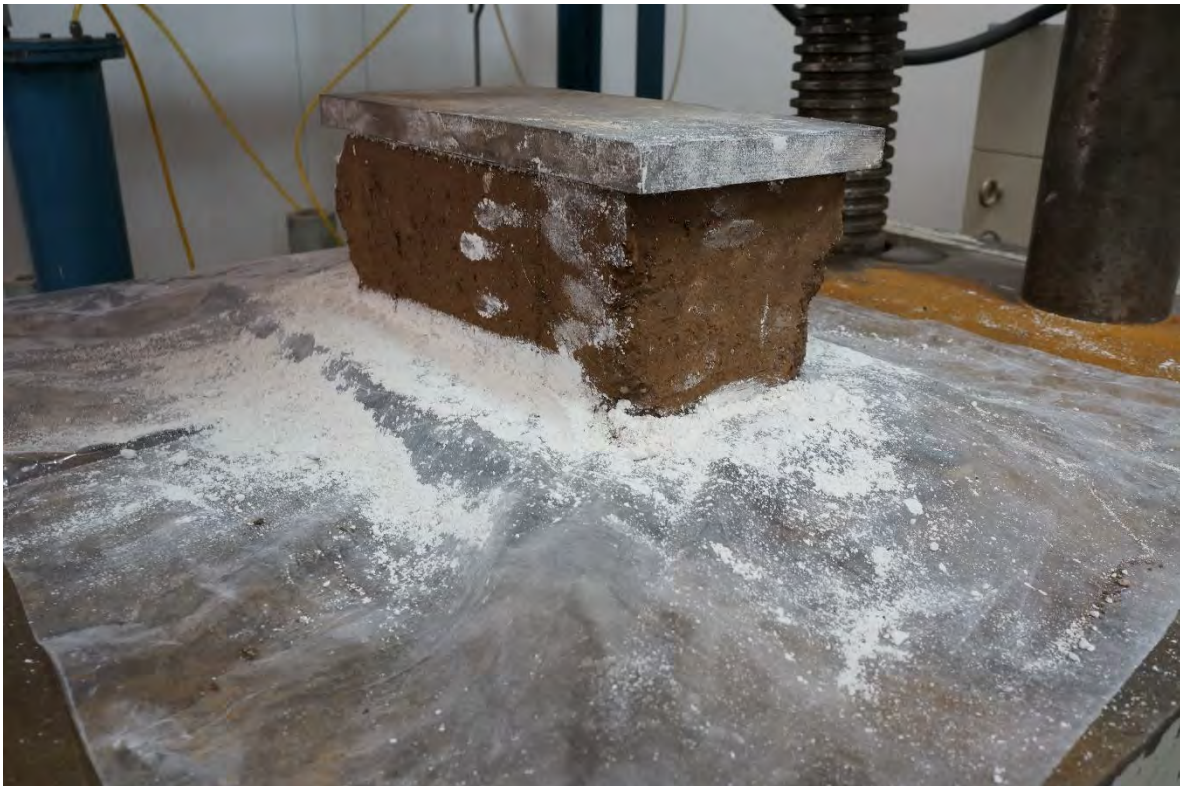
BTC-15 ANTES DE LA PRUEBA A COMPRESIÓN.
