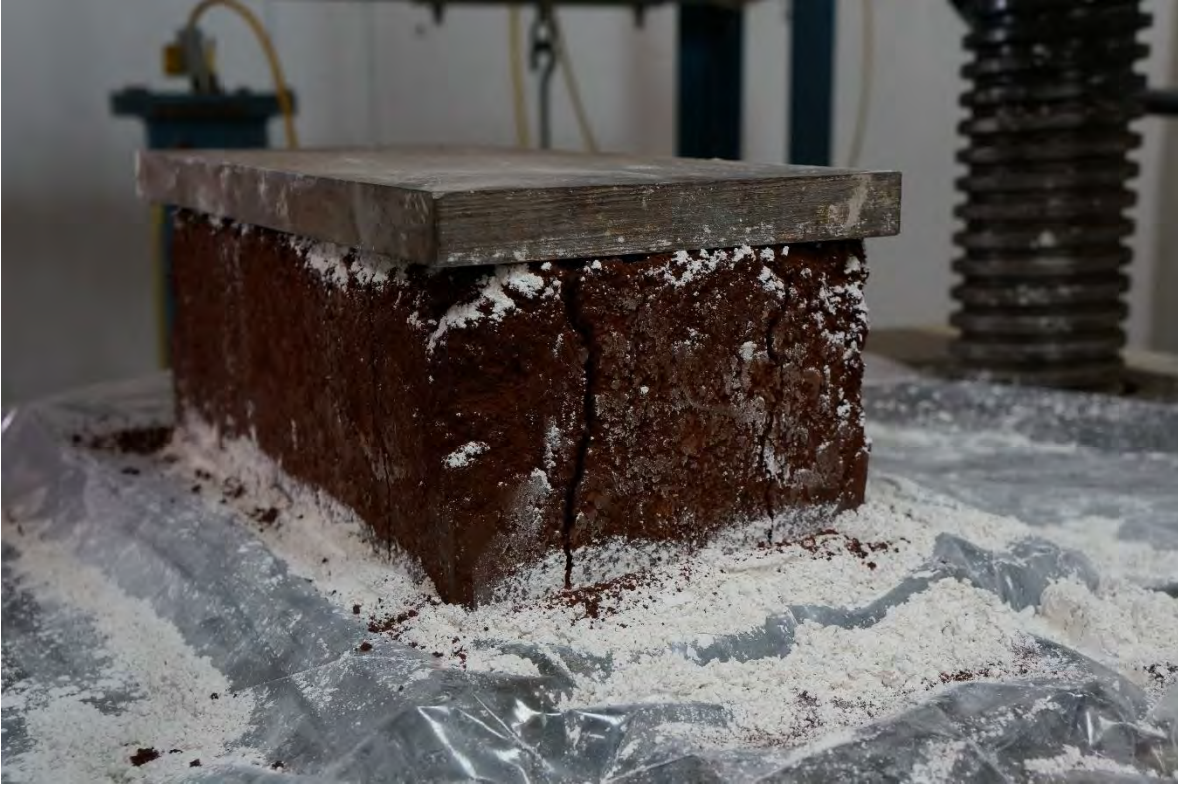
BTC-2 DESPUÉS DE LA PRUEBA A COMPRESIÓN.
