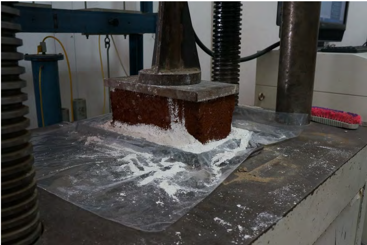
BTC-1 ANTES DE LA PUEBA A COMPRESIÓN.
