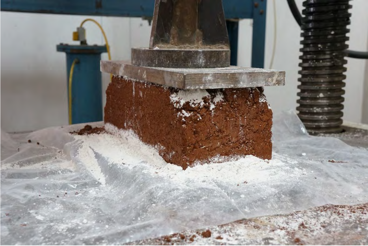
BTC-5 ANTES DE LA PRUEBA A COMPRESIÓN.
