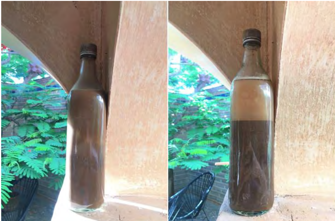
Figura 4.6. Prueba de granulometría. Fuente: Propia, en trabajo de campo 2020.
