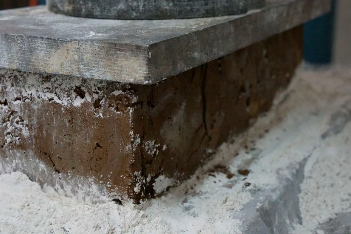
ADOBE-7 DESPUÉS DE LA PRUEBA A COMPRESIÓN.
