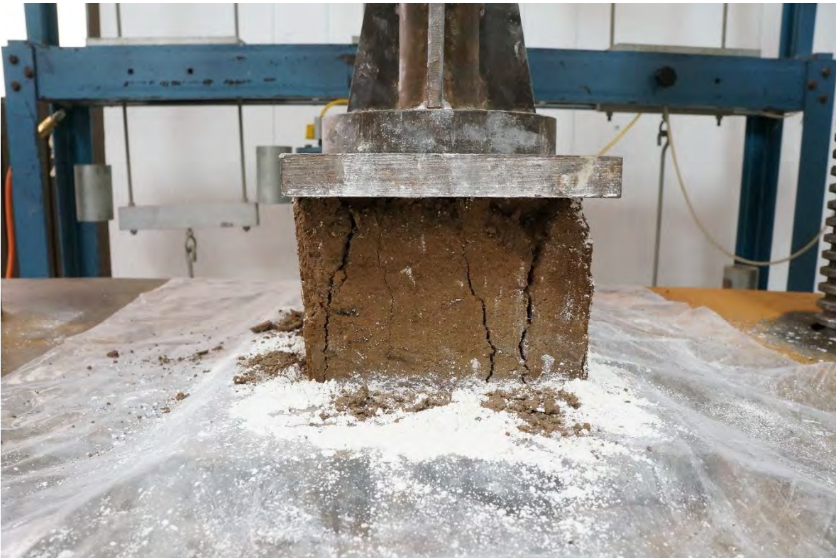
BTC-16 ANTES DE LA PRUEBA A COMPRESIÓN.
