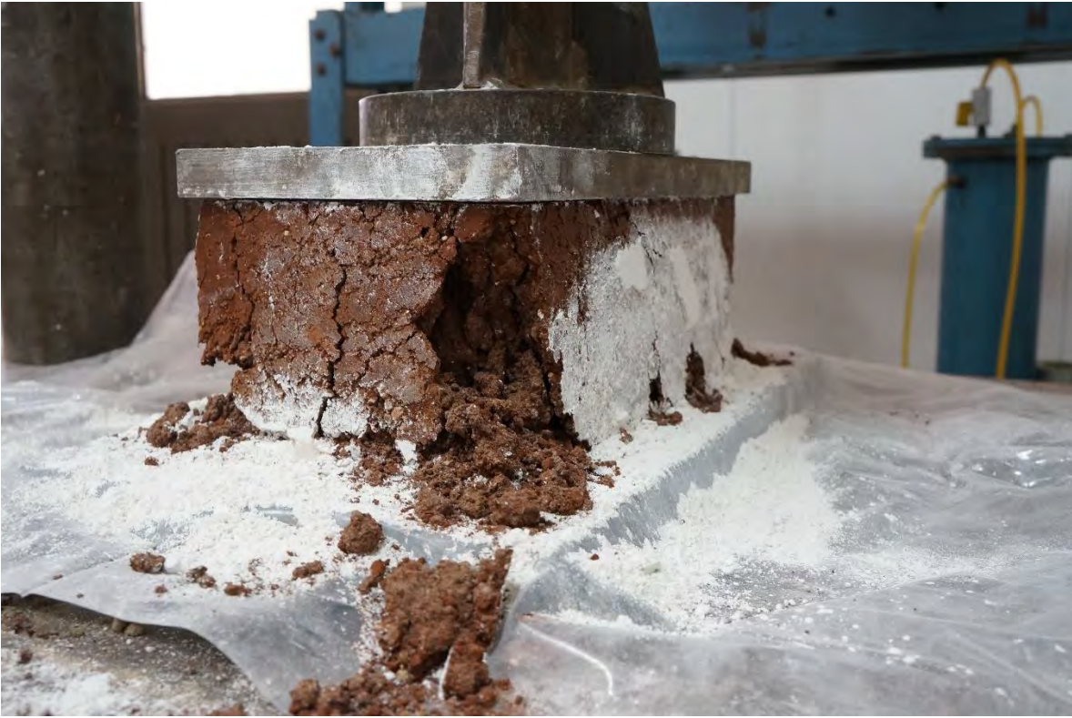
BTC-7 DESPUÉS DE LA PRUEBA A COMPRESIÓN.
