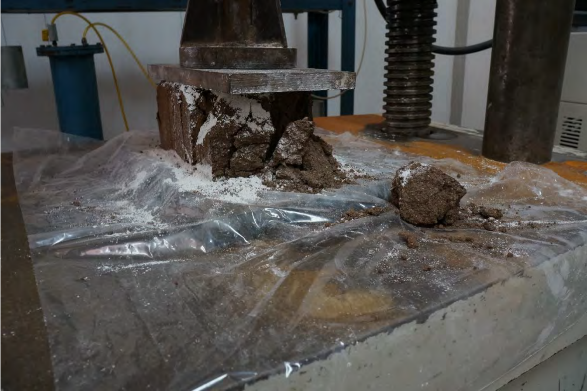
BTC-14 DESPUÉS DE LA PRUEBA A COMPRESIÓN.
