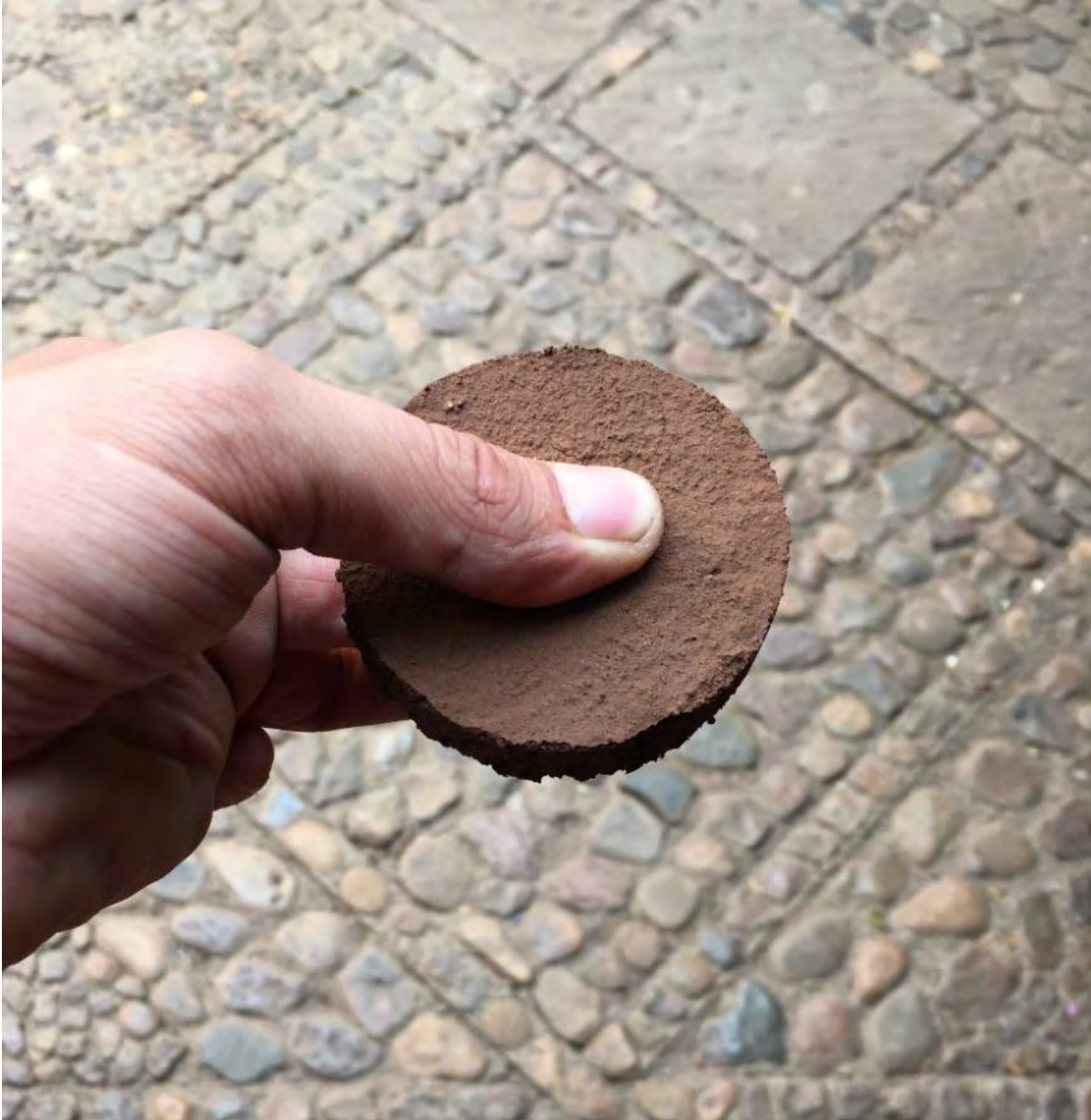
Figura 4.7. Prueba de cohesión, retracción y dureza. Fuente: Propia, en trabajo de campo 2020.
