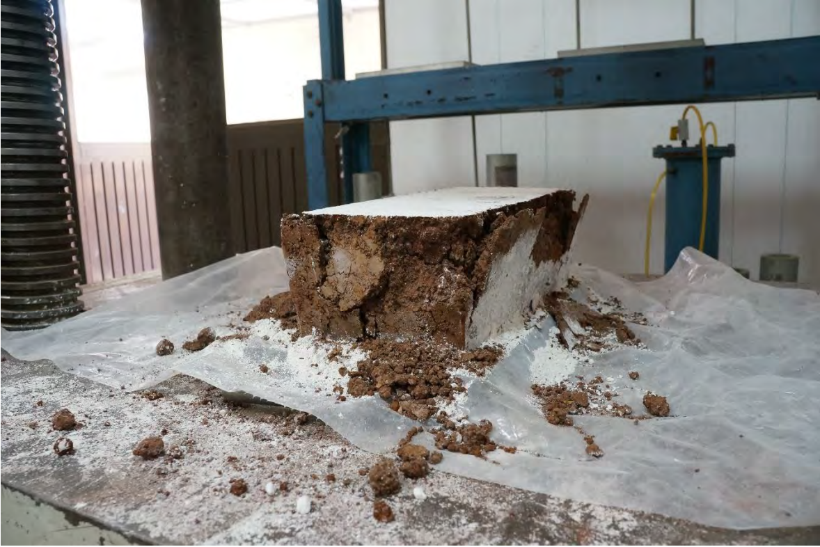
BTC-12 DESPUÉS DE LA PRUEBA A COMPRESIÓN.
