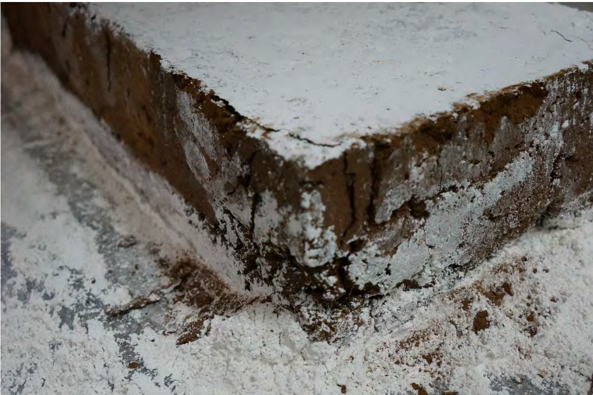
ADOBE-11 DESPUÉS DE LA PRUEBA A COMPRESIÓN.
