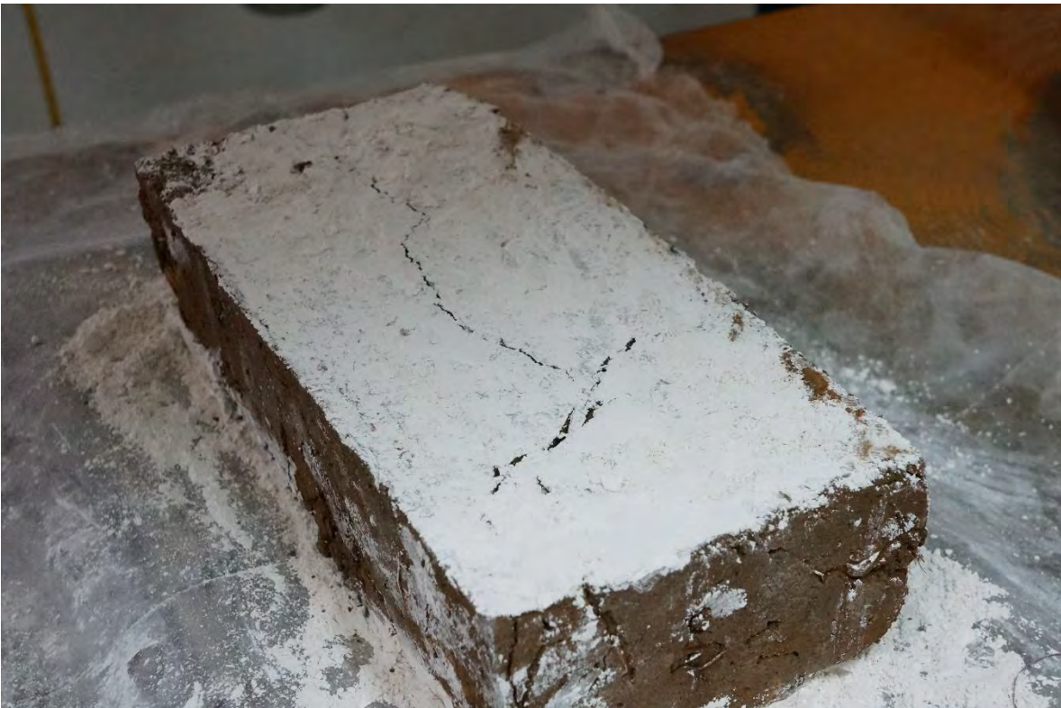
ADOBE-9 DESPUÉS DE LA PRUEBA A COMPRESIÓN.
