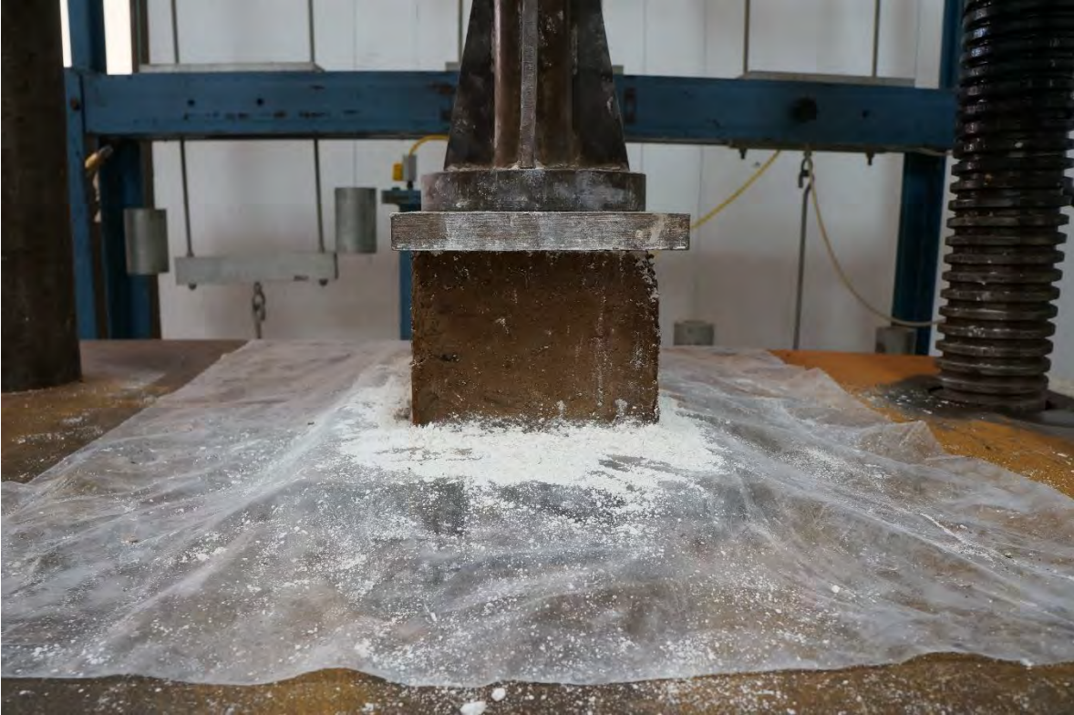
BTC-16 ANTES DE LA PRUEBA A COMPRESIÓN.
