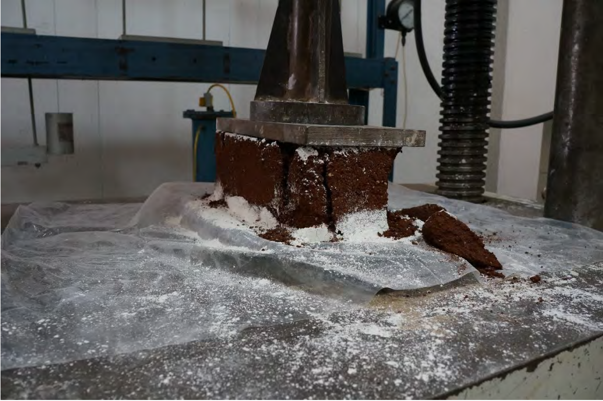
BTC-4 DESPUÉS DE LA PRUEBA A COMPRESIÓN.
