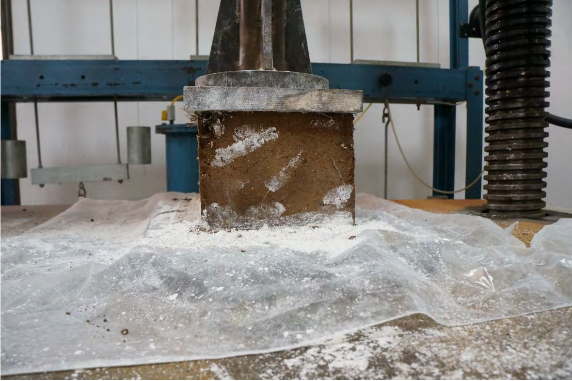
BTC-22 DESPUÉS DE LA PRUEBA A COMPRESIÓN.
