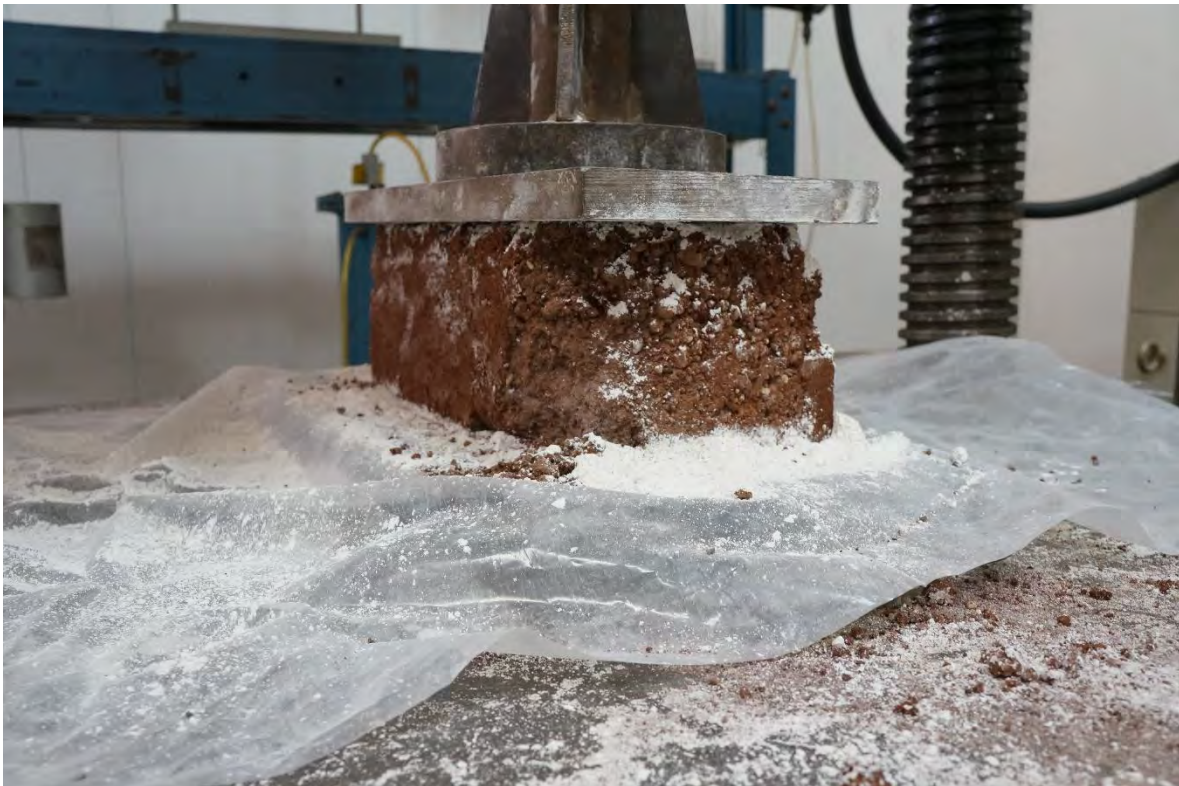
BTC-10 ANTES DE LA PRUEBA A COMPRESIÓN.
