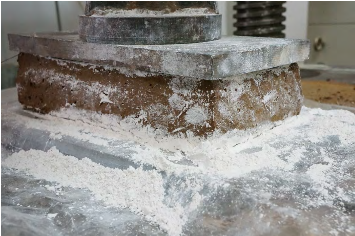
ADOBE-4 ANTES DE LA PRUEBA A COMPRESIÓN.
