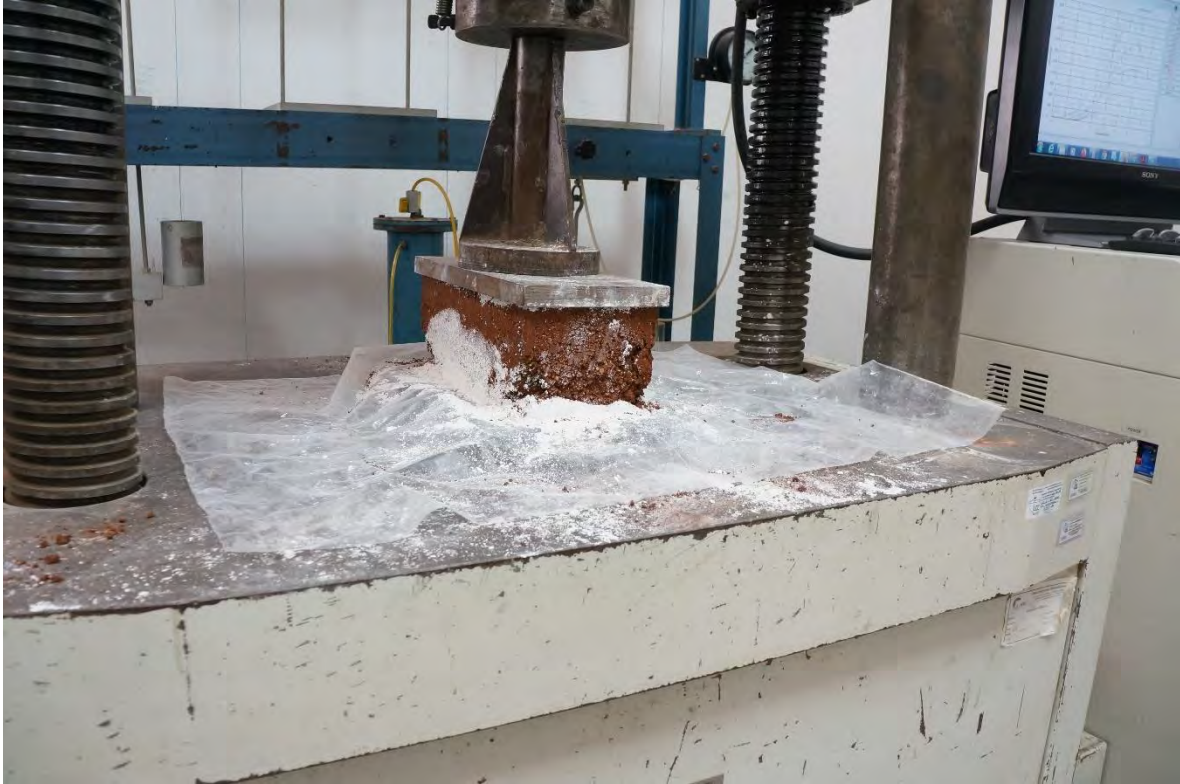
BTC-6 ANTES DE LA PRUEBA A COMPRESIÓN.
