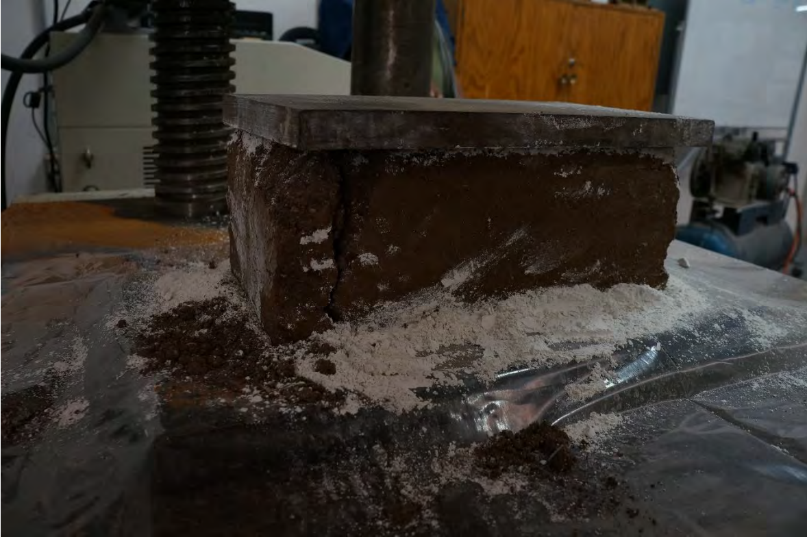
BTC-13 DESPUÉS DE LA PRUEBA A COMPRESIÓN.
