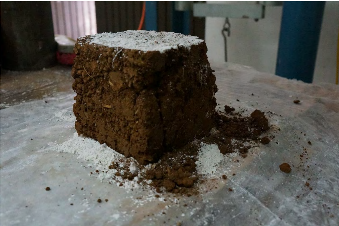
TAPIAL-2 DESPUÉS DE LA PRUEBA A COMPRESIÓN.
