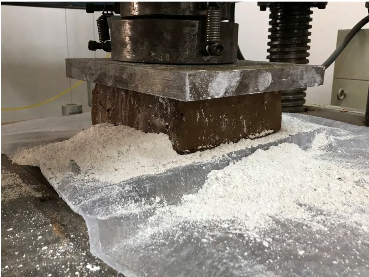
PISO DE TIERRA-2 ANTES DE LA PRUEBA A COMPRESIÓN.
