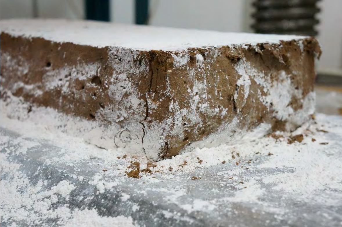
ADOBE-5 DESPUÉS DE LA PRUEBA A COMPRESIÓN.
