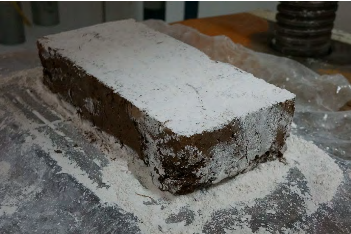
ADOBE-10 DESPUÉS DE LA PRUEBA A COMPRESIÓN.
