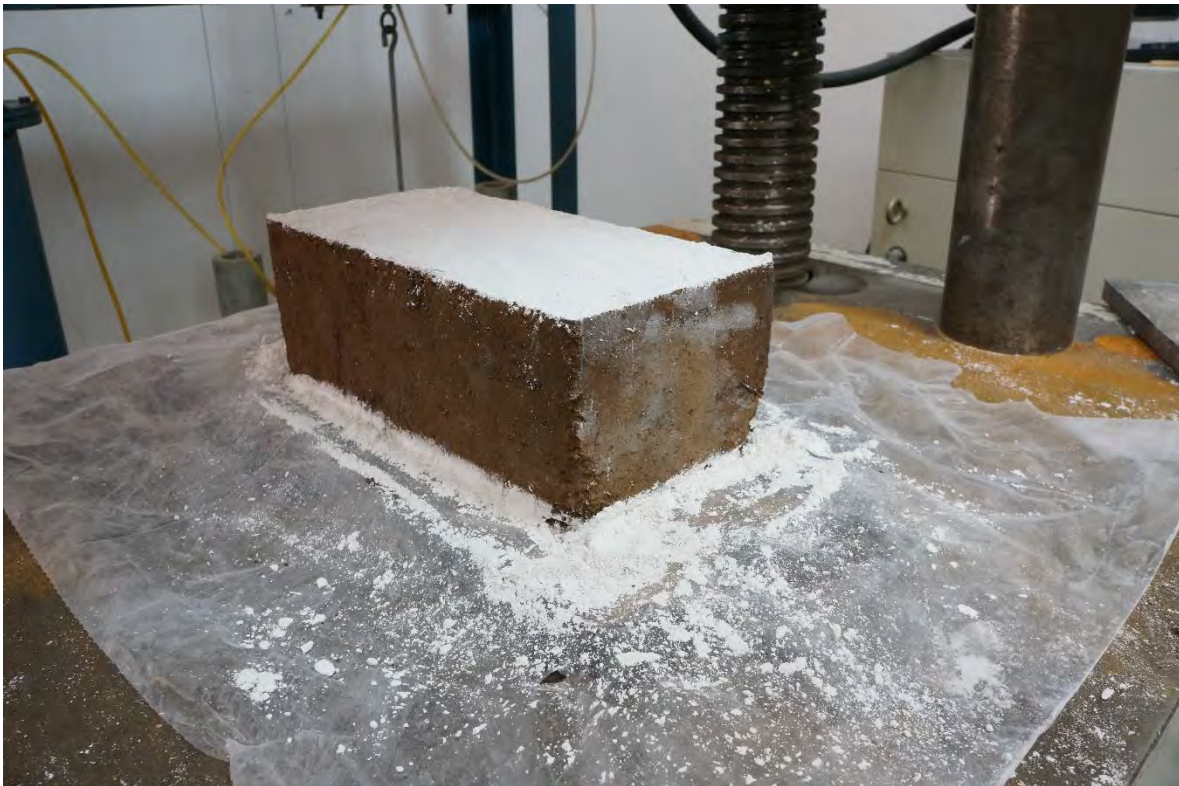
BTC-18 ANTES DE LA PRUEBA A COMPRESIÓN.
