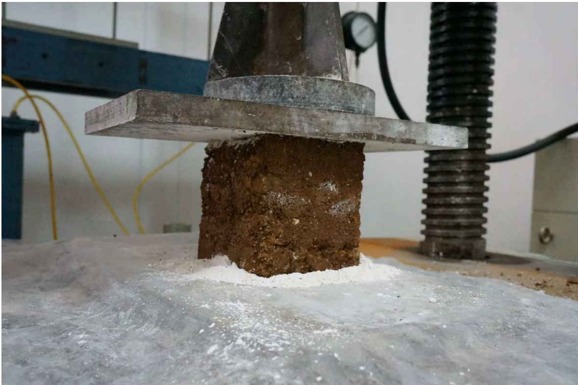
TAPIAL-3 ANTES DE LA PRUEBA A COMPRESIÓN.
