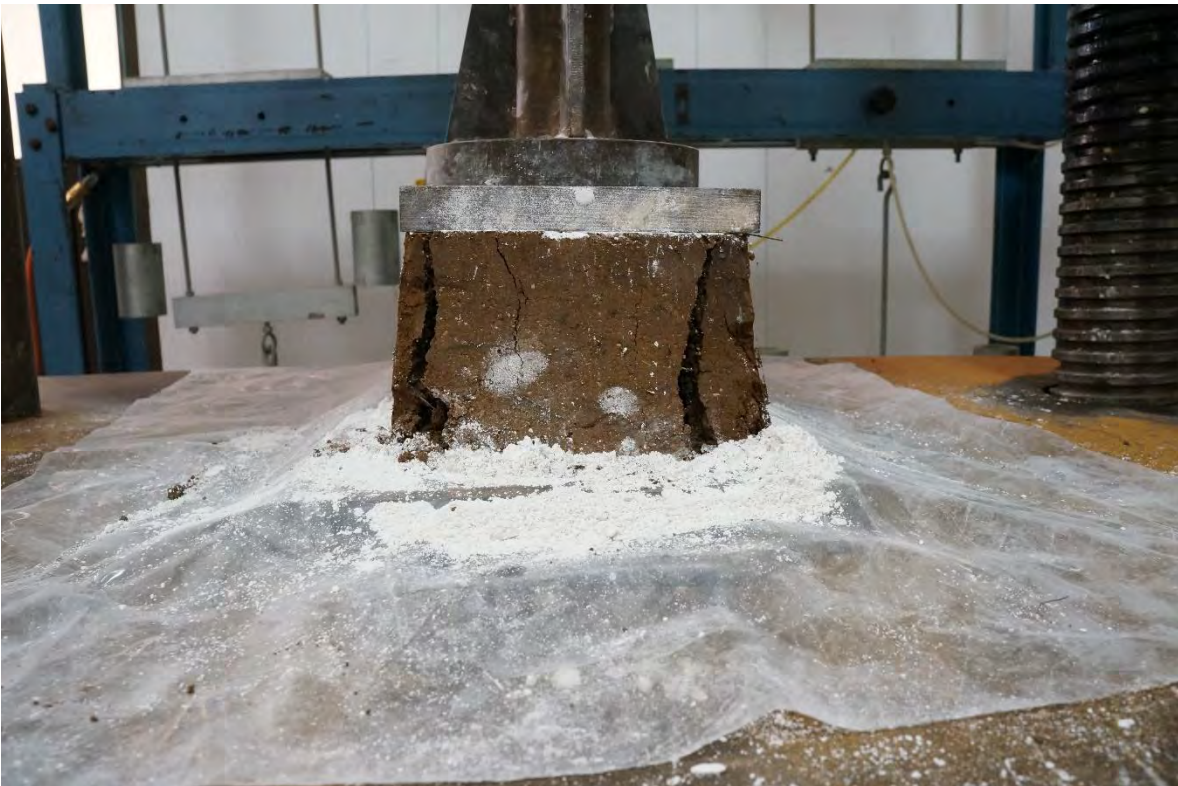
BTC-17 ANTES DE LA PRUEBA A COMPRESIÓN.
