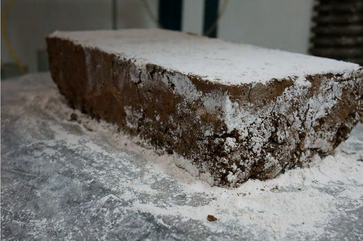
ADOBE-12 DESPUÉS DE LA PRUEBA A COMPRESIÓN.
