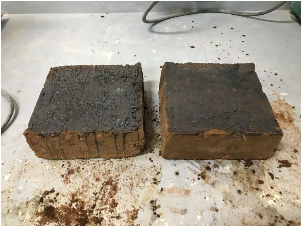
Figura 4.26. Especímenes de piso después de la prueba al ser sometidos a 300°C. Fuente: Propia, en trabajo de campo 2021.
