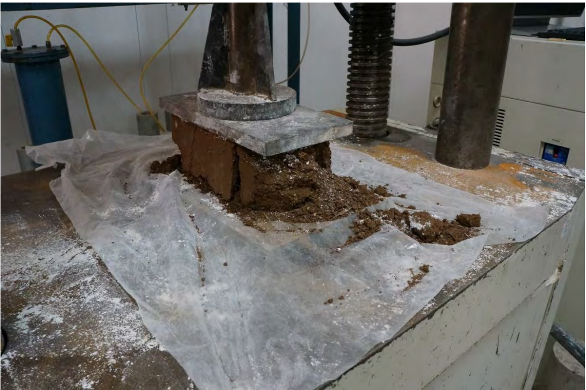
BTC-24 DESPUÉS DE LA PRUEBA A COMPRESIÓN.
