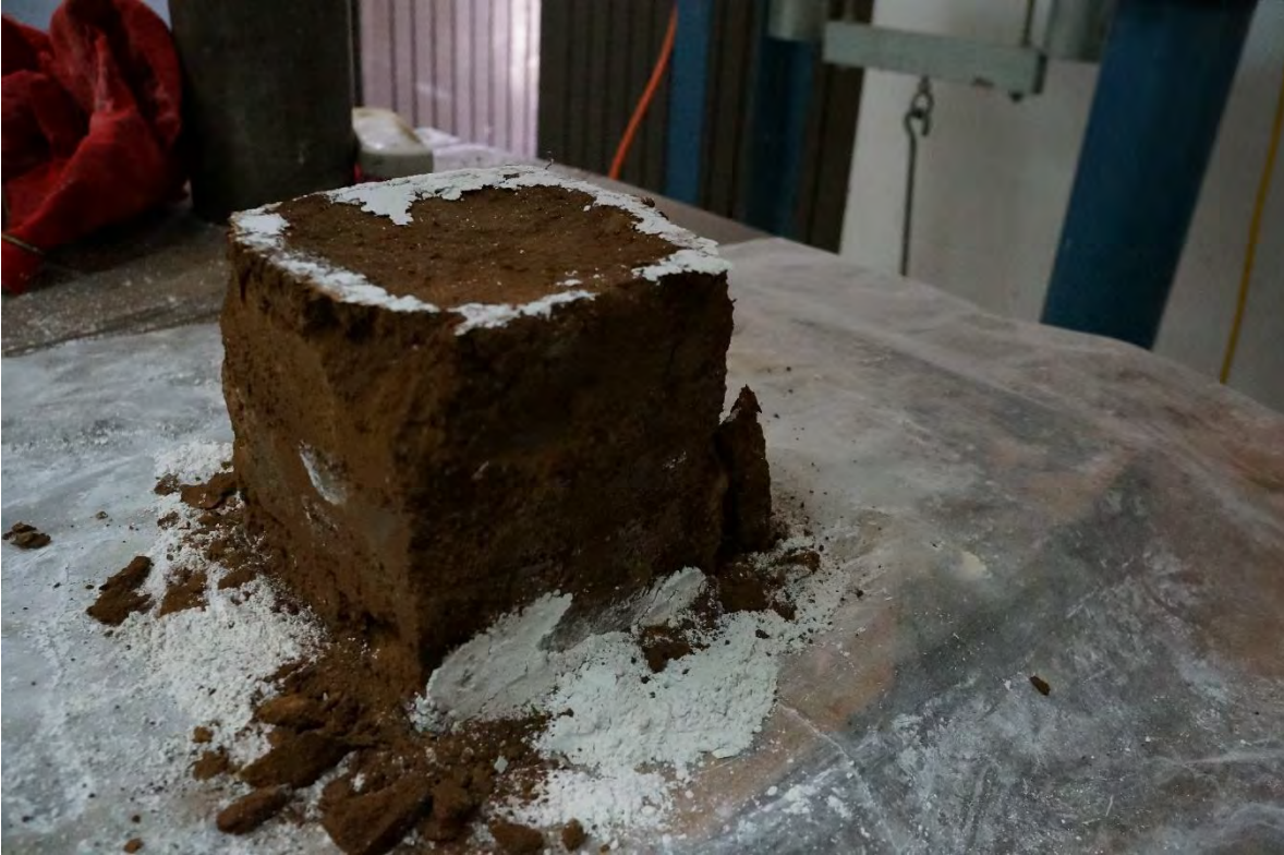
TAPIAL-1 DESPUÉS DE LA PRUEBA A COMPRESIÓN.
