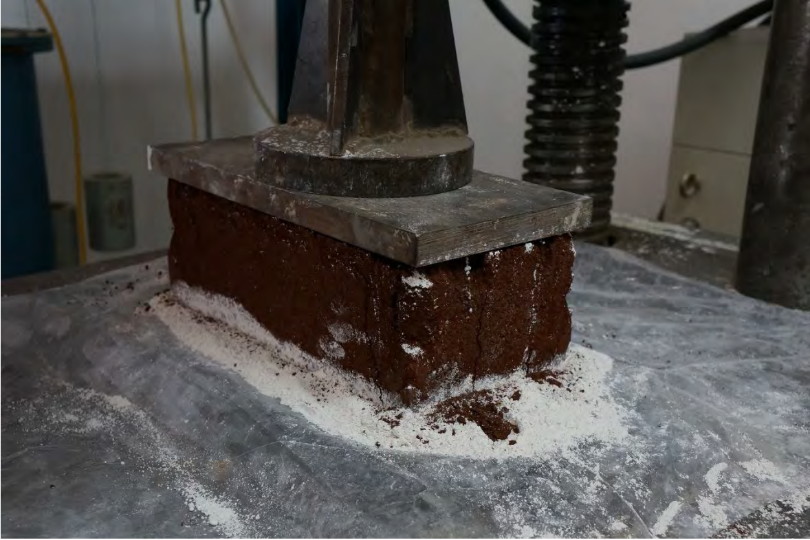
BTC-3 DESPUÉS DE LA PRUEBA A COMPRESIÓN.
