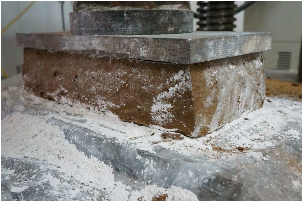
ADOBE-2 ANTES DE LA PRUEBA A COMPRESIÓN.
