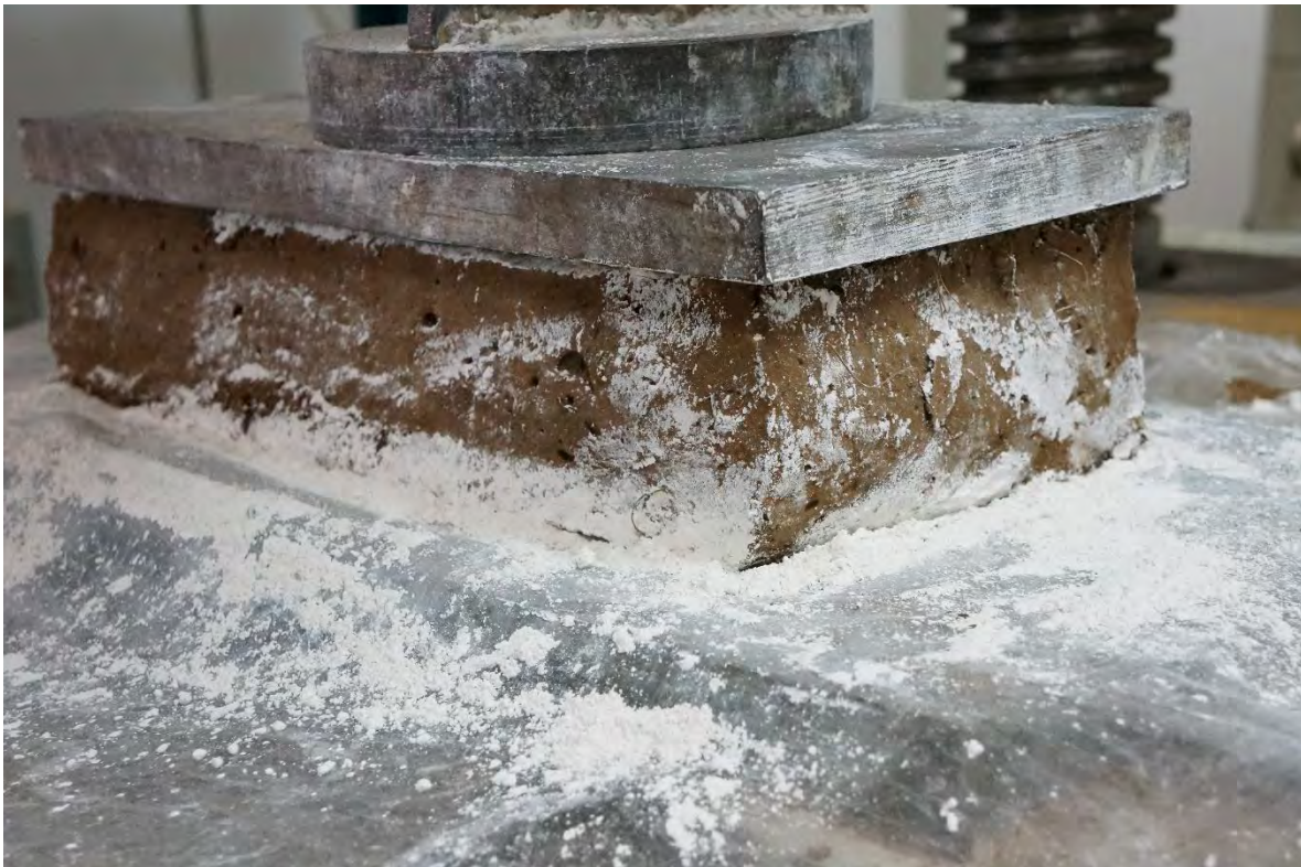
ADOBE-5 ANTES DE LA PRUEBA A COMPRESIÓN.
