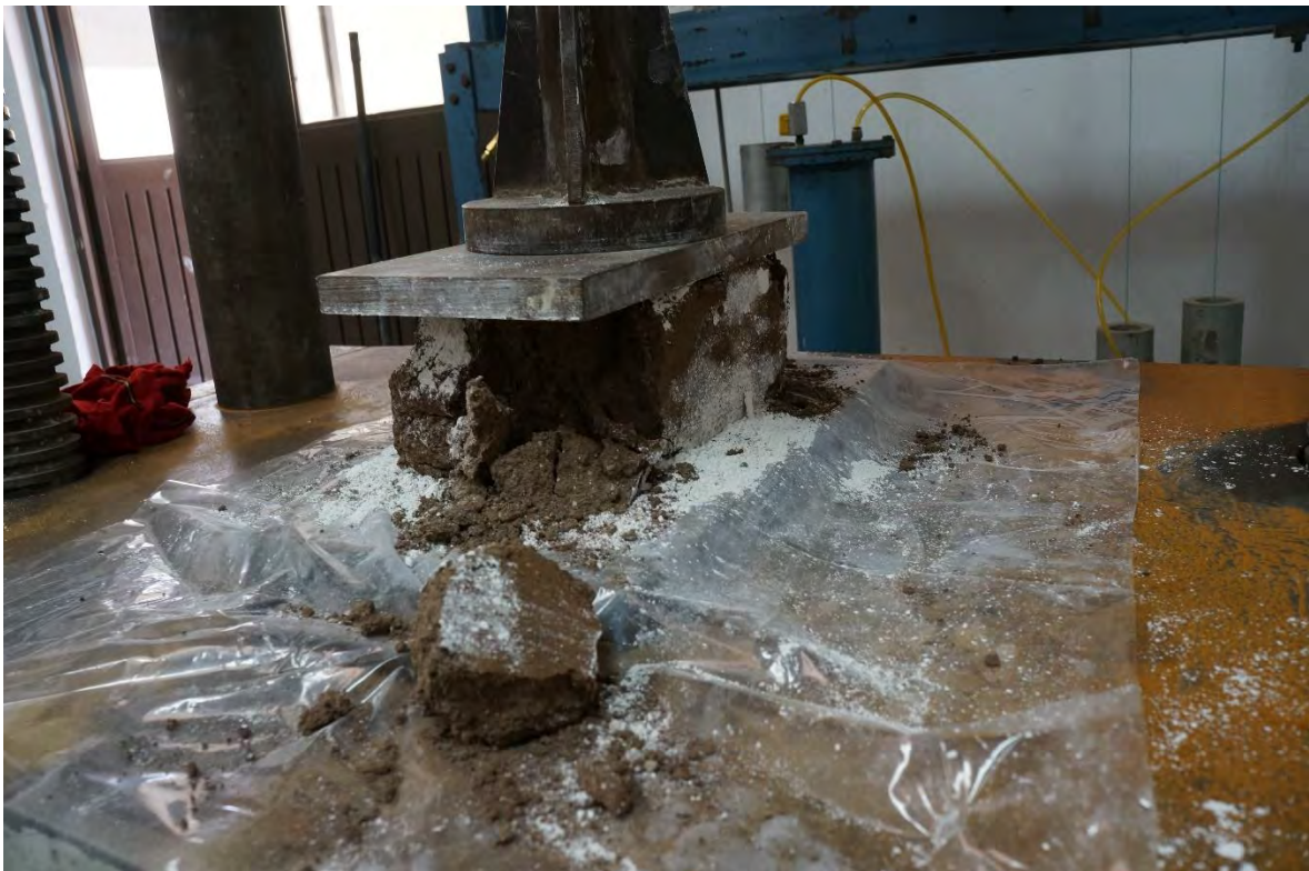
BTC-14 DESPUÉS DE LA PRUEBA A COMPRESIÓN.
