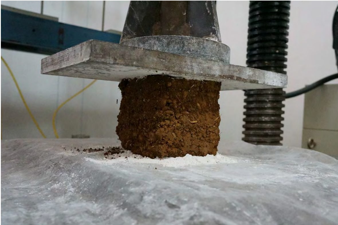
TAPIAL-2 ANTES DE LA PRUEBA A COMPRESIÓN.
