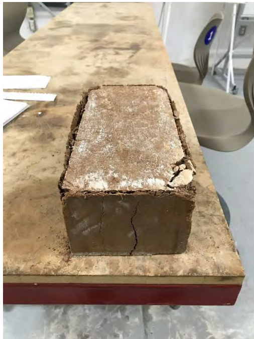
BTC (2)-1 DESPUÉS DE LA PRUEBA A COMPRESIÓN.
