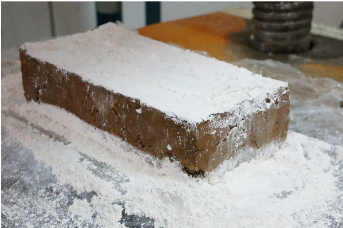
ADOBE-7 ANTES DE LA PRUEBA A COMPRESIÓN.
