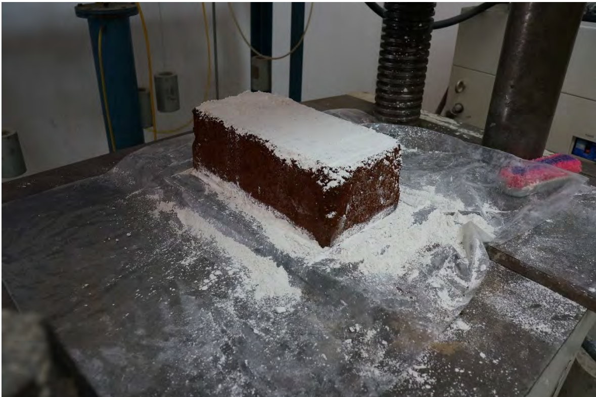
BTC-2 ANTES DE LA PRUEBA A COMPRESIÓN.
