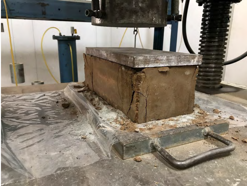
BTC (2)-4 DESPUÉS DE LA PRUEBA A COMPRESIÓN.
