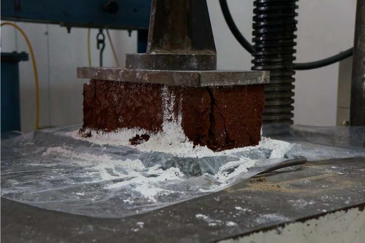
BTC-1 DESPUÉS DE LA PRUEBA A COMPRESIÓN.
