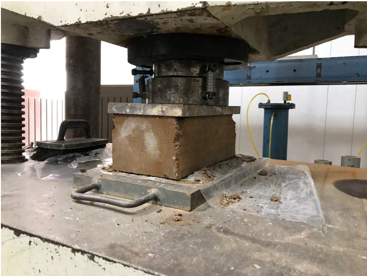
BTC (2)-3 ANTES DE LA PRUEBA A COMPRESIÓN.
