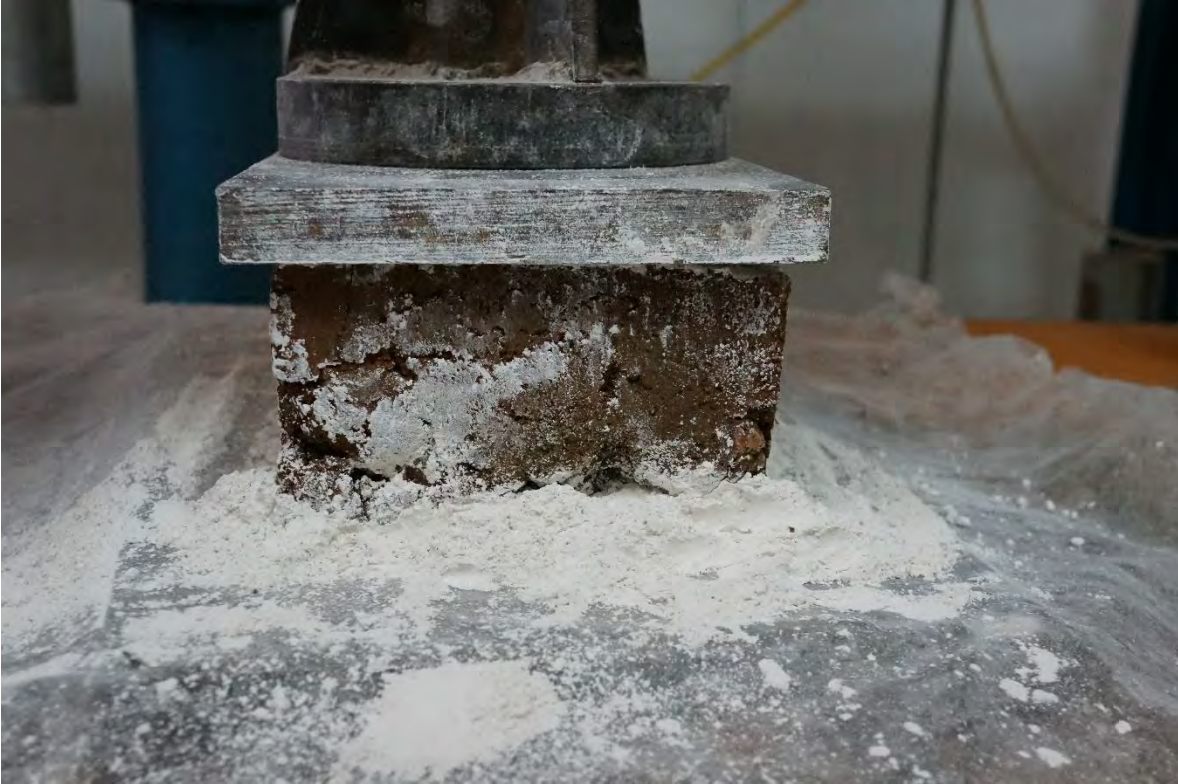
ADOBE-11 DESPUÉS DE LA PRUEBA A COMPRESIÓN.
