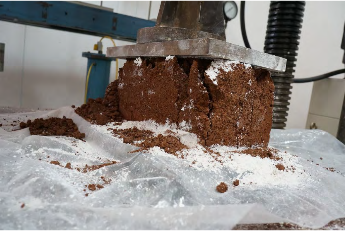
BTC-8 DESPUÉS DE LA PRUEBA A COMPRESIÓN.
