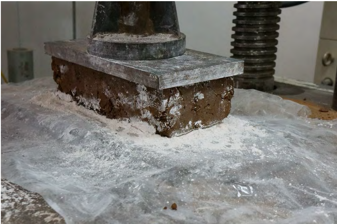
ADOBE-9 ANTES DE LA PRUEBA A COMPRESIÓN.
