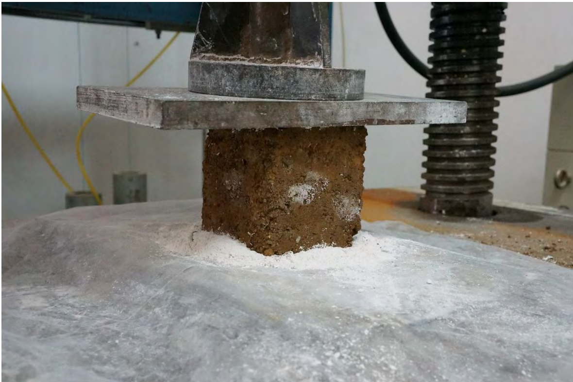
TAPIAL-4 ANTES DE LA PRUEBA A COMPRESIÓN.
