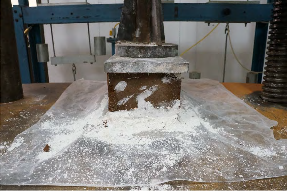
BTC-19 ANTES DE LA PRUEBA A COMPRESIÓN.
