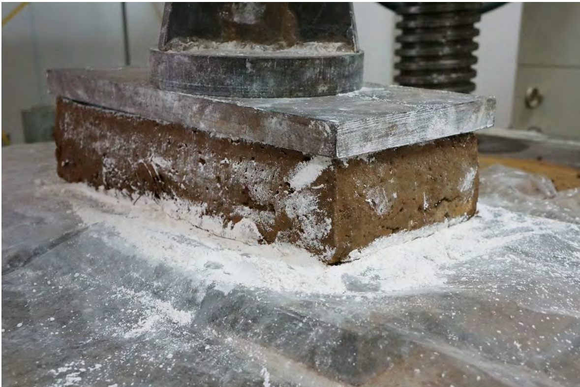
ADOBE-3 ANTES DE LA PRUEBA A COMPRESIÓN.
