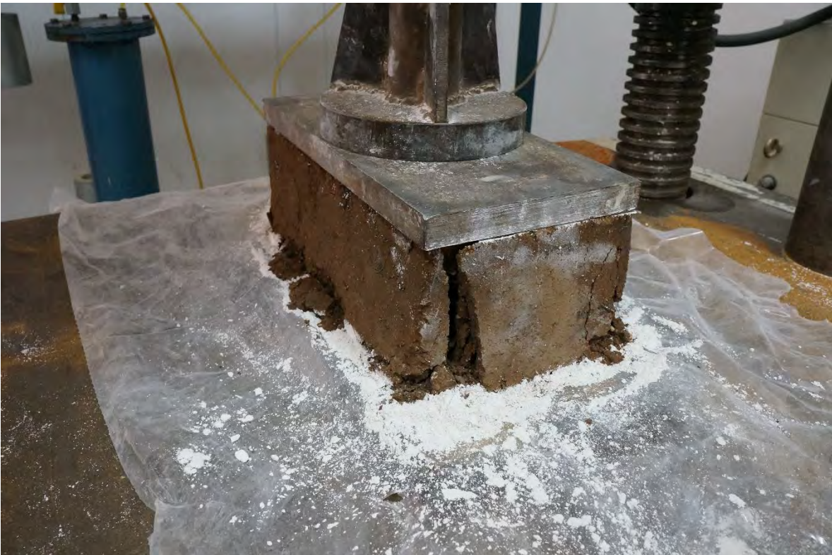
BTC-18 ANTES DE LA PRUEBA A COMPRESIÓN.
