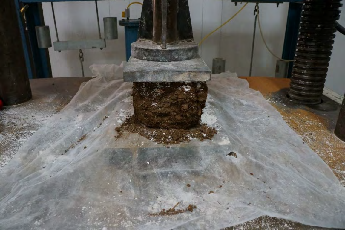
BTC-24 ANTES DE LA PRUEBA A COMPRESIÓN.
