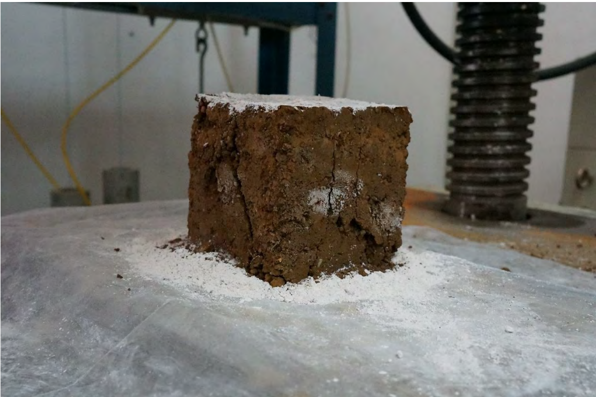
TAPIAL-4 DESPUÉS DE LA PRUEBA A COMPRESIÓN.
