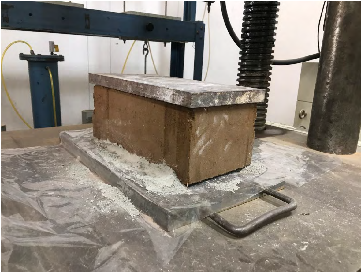
BTC (2)-1 ANTES DE LA PRUEBA A COMPRESIÓN.
