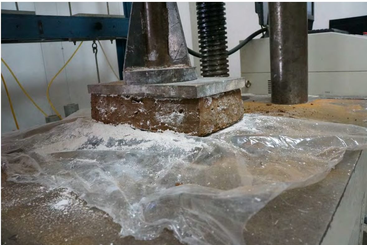
ADOBE-1 ANTES DE LA PRUEBA A COMPRESIÓN.
