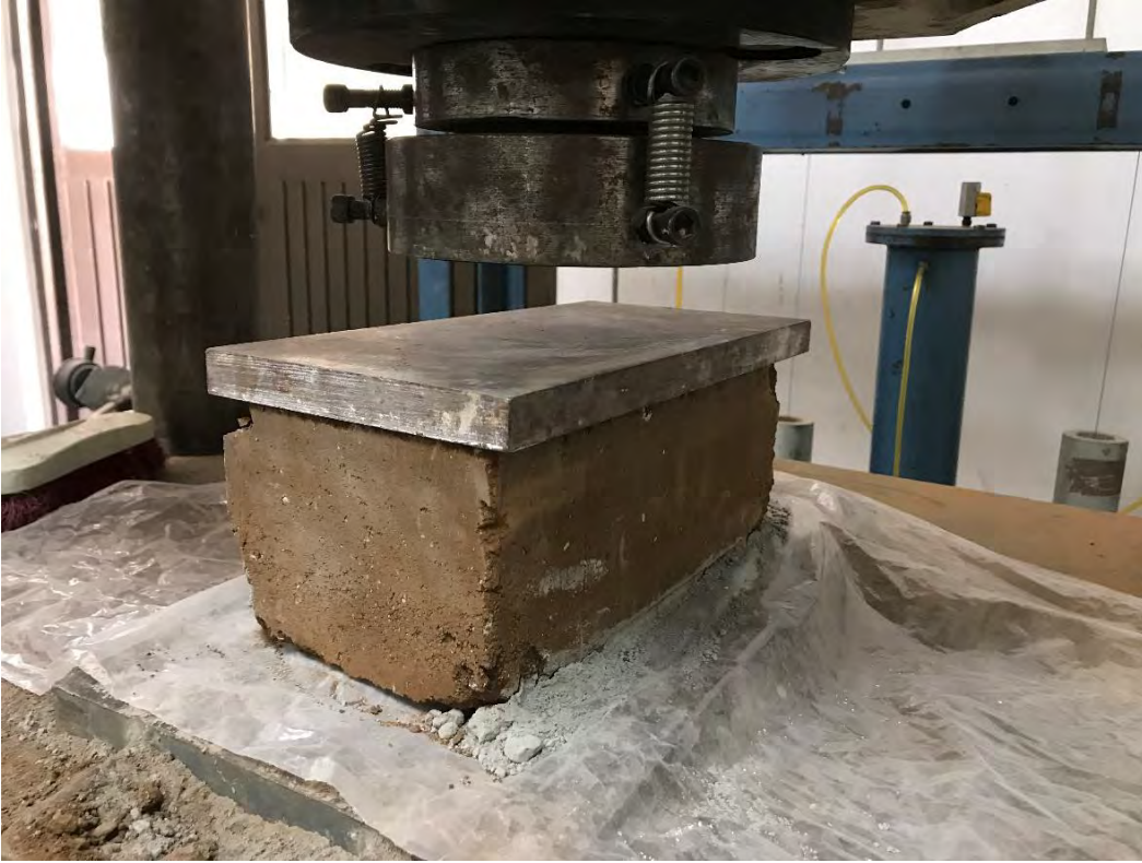
BTC (2)-6 ANTES DE LA PRUEBA A COMPRESIÓN.
