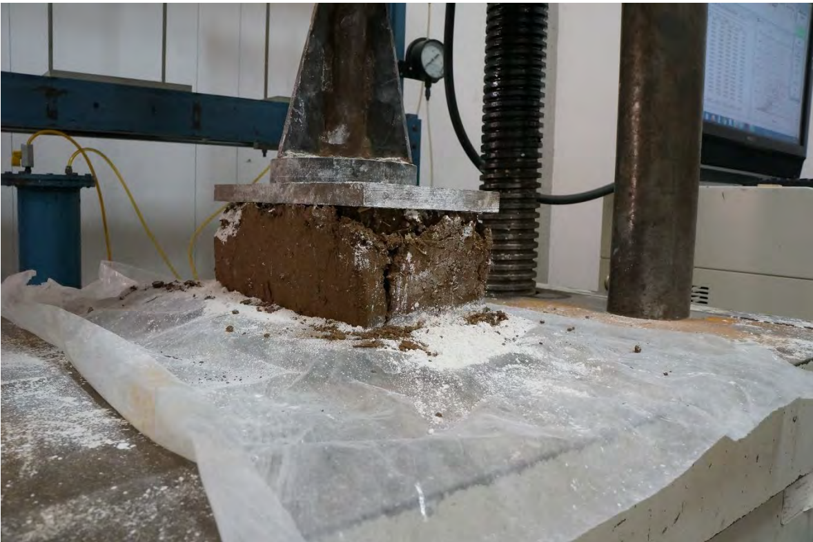
BTC-23 DESPUÉS DE LA PRUEBA A COMPRESIÓN.
