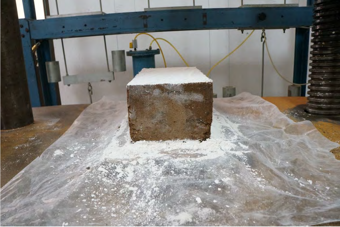
BTC-18 ANTES DE LA PRUEBA A COMPRESIÓN.
