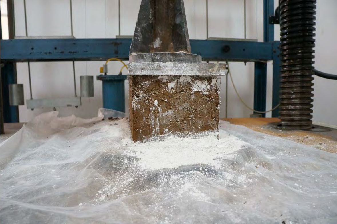
BTC-23 ANTES DE LA PRUEBA A COMPRESIÓN.
