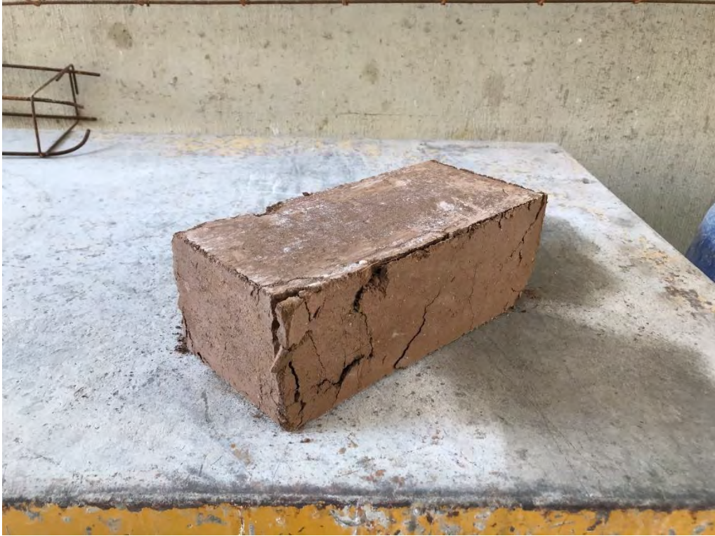
BTC (2)-2 DESPUÉS DE LA PRUEBA A COMPRESIÓN.
