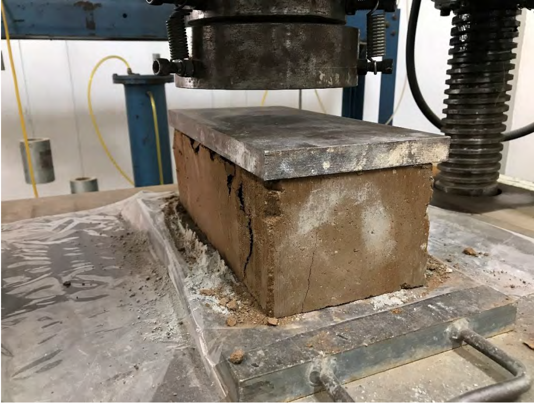
BTC (2)-3 DESPUÉS DE LA PRUEBA A COMPRESIÓN.
