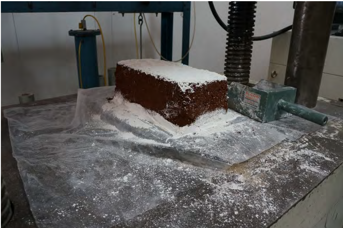
BTC-4 ANTES DE LA PRUEBA A COMPRESIÓN.
