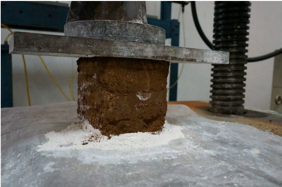
TAPIAL-1 ANTES DE LA PRUEBA A COMPRESIÓN.
