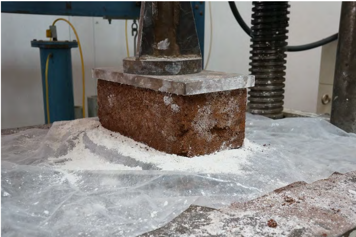
BTC-9 ANTES DE LA PRUEBA A COMPRESIÓN.
