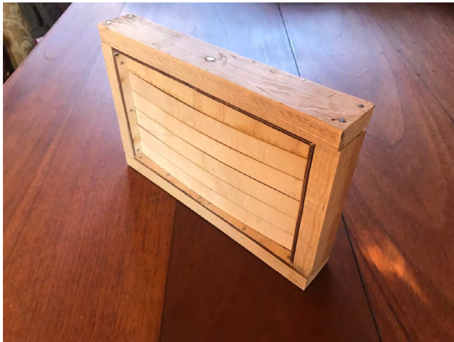
Figura 4.17. Maqueta de muro de bahareque, estructura de madera residual de pino. Fuente: Propia, en trabajo de campo 2020.
