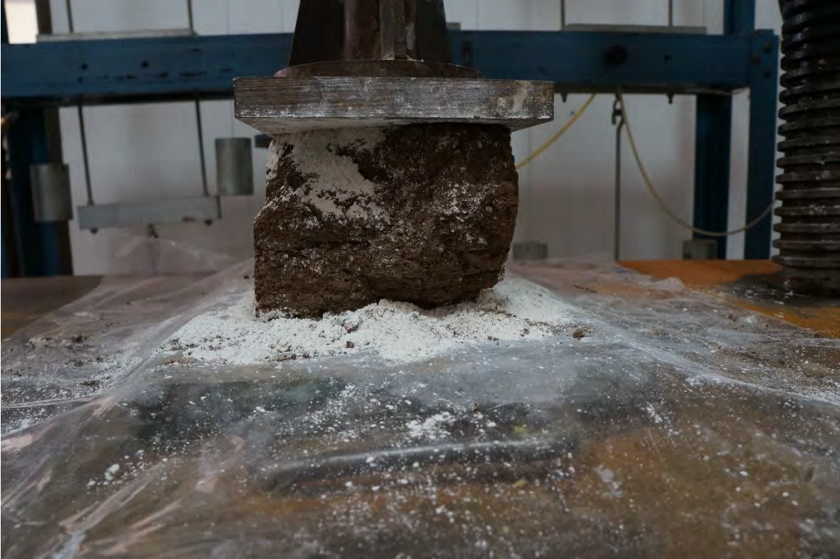
BTC-14 ANTES DE LA PRUEBA A COMPRESIÓN.
