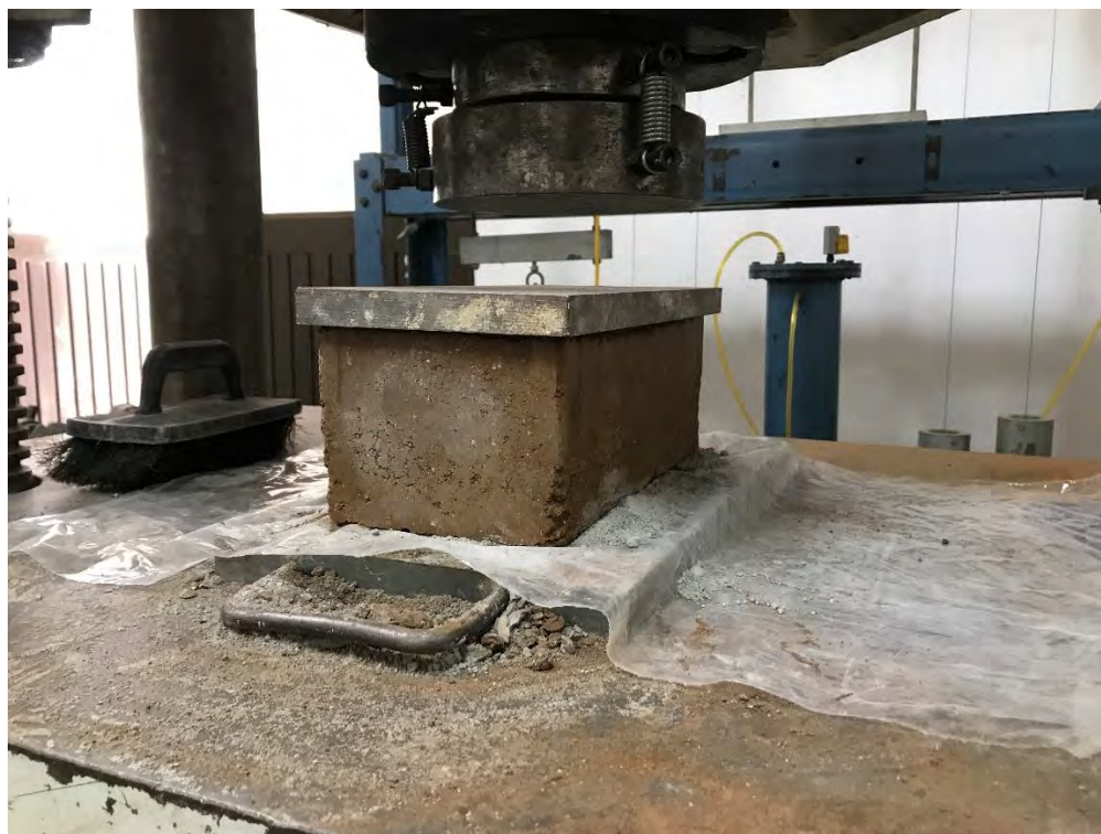
BTC (2)-5 ANTES DE LA PRUEBA A COMPRESIÓN.
