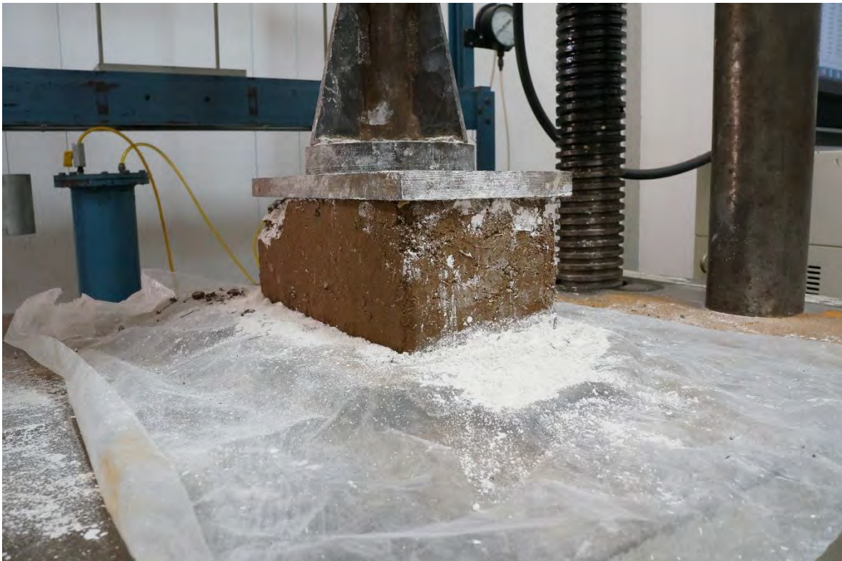
BTC-23 ANTES DE LA PRUEBA A COMPRESIÓN.
