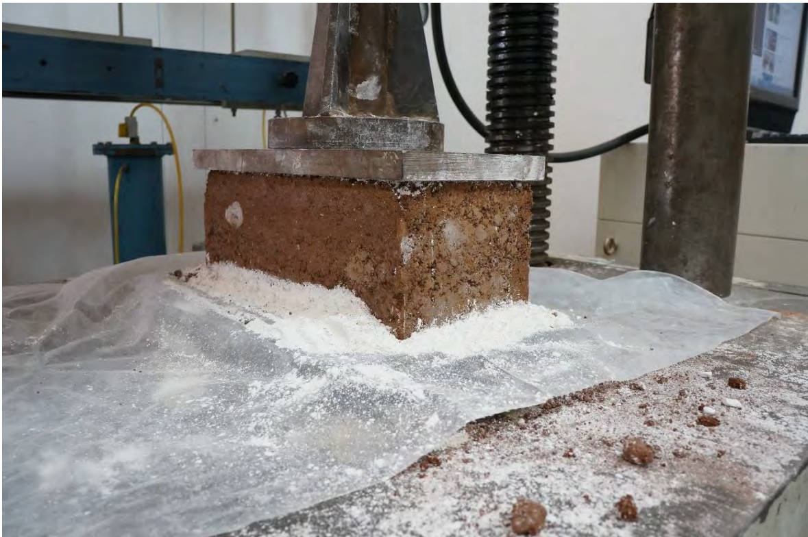
BTC-12 ANTES DE LA PRUEBA A COMPRESIÓN.
