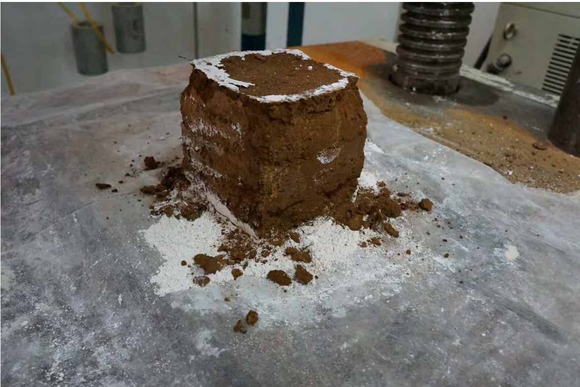
TAPIAL-1 DESPUÉS DE LA PRUEBA A COMPRESIÓN.
