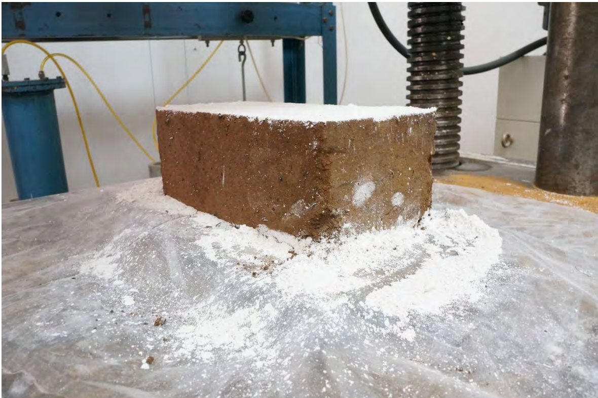
BTC-17 ANTES DE LA PRUEBA A COMPRESIÓN.
