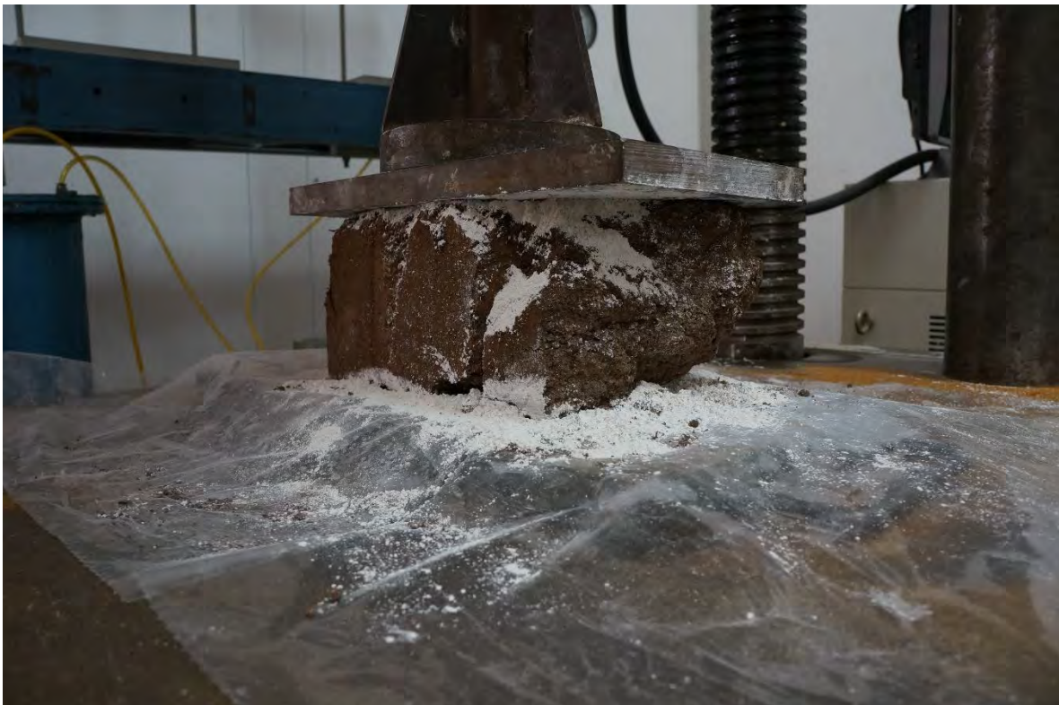
BTC-14 ANTES DE LA PRUEBA A COMPRESIÓN.
