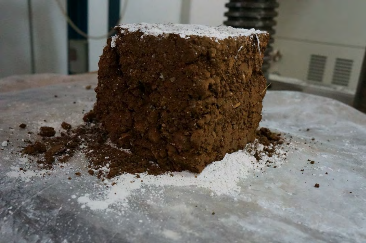
TAPIAL-2 DESPUÉS DE LA PRUEBA A COMPRESIÓN.
