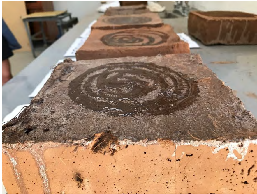
Figura 4.28. Prueba hidrofóbica en piso con sellador a base de jabón. Fuente: Propia, en trabajo de campo 2021.
