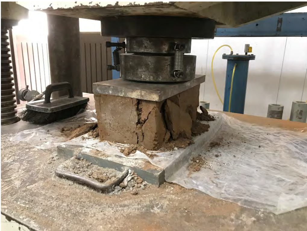
BTC (2)-5 DEPUÉS DE LA PRUEBA A COMPRESIÓN.
