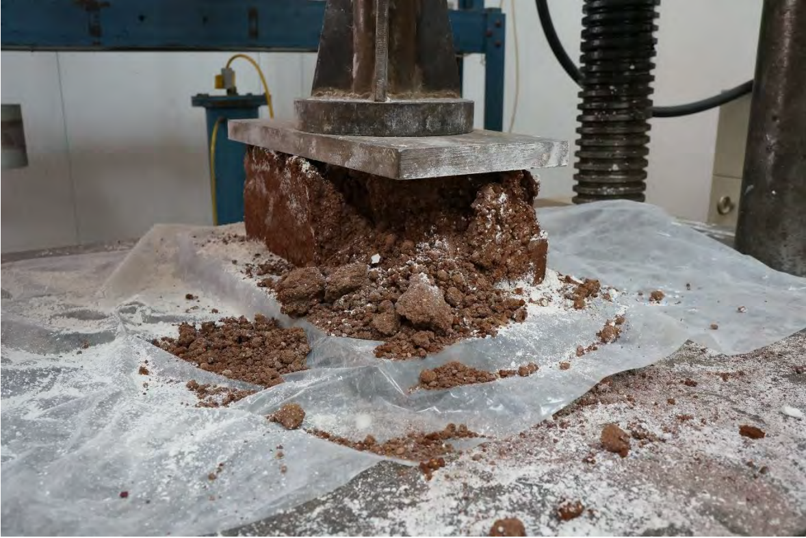
BTC-10 DESPUÉS DE LA PRUEBA A COMPRESIÓN.
