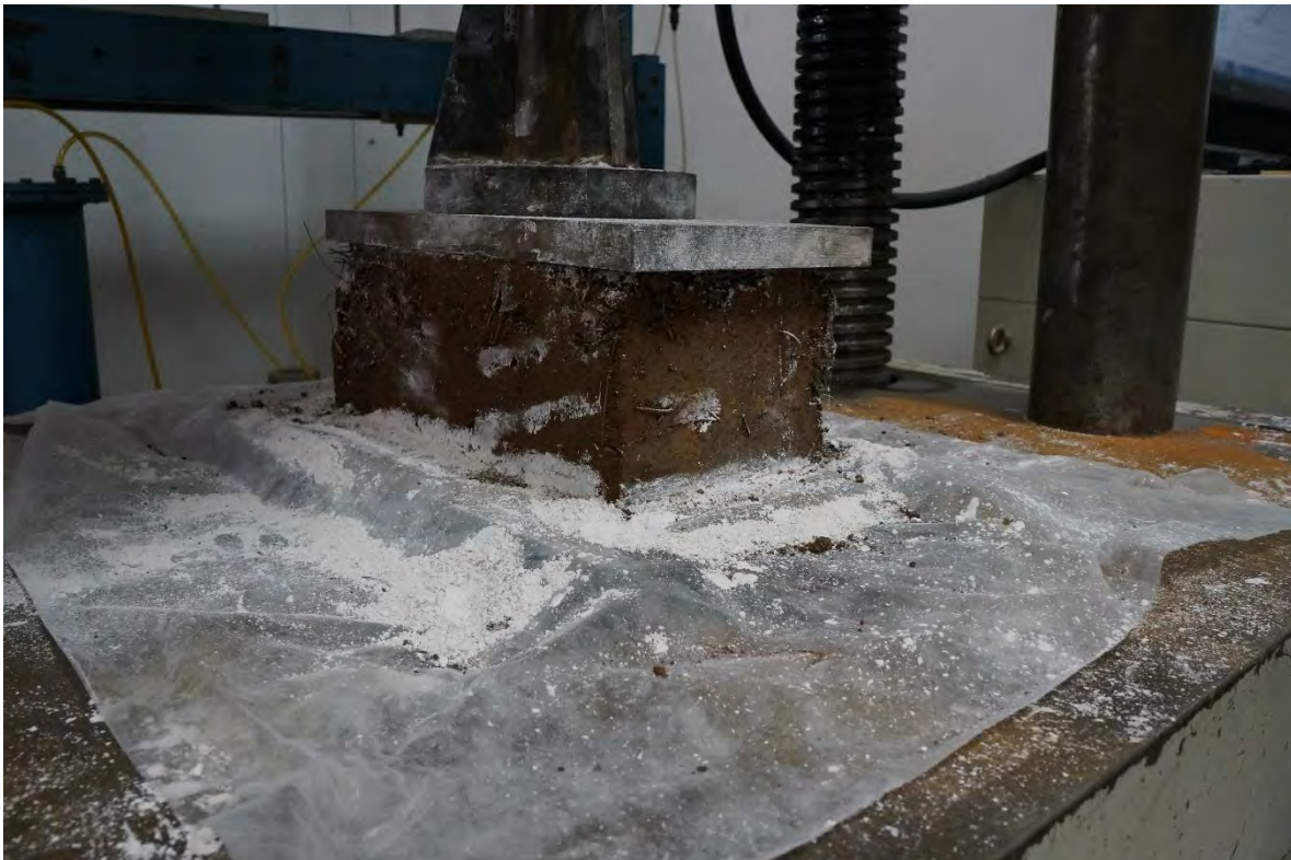
BTC-20 ANTES DE LA PRUEBA A COMPRESIÓN.
