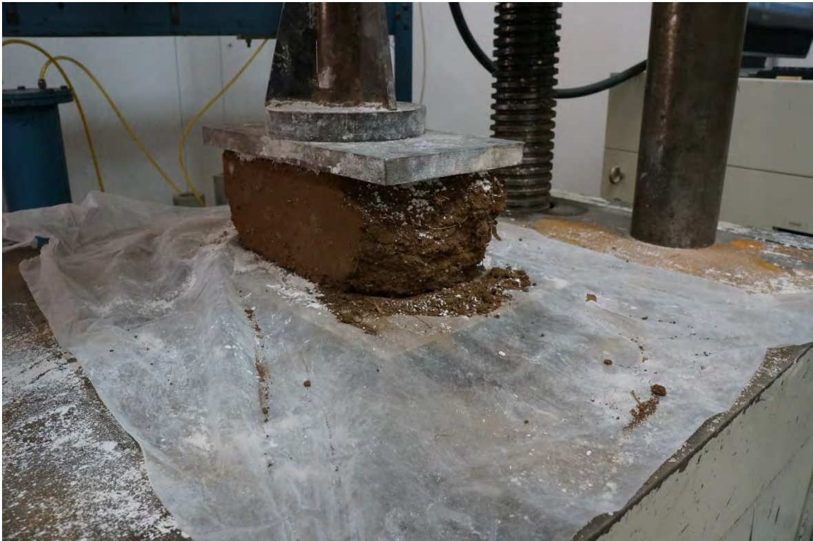
BTC-24 ANTES DE LA PRUEBA A COMPRESIÓN.
