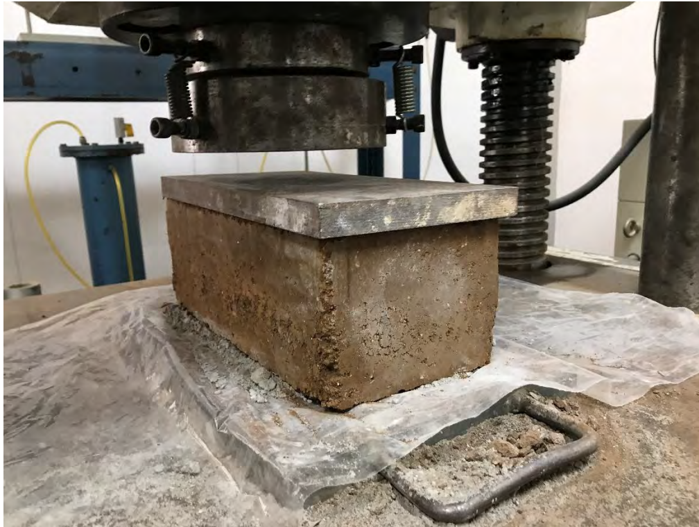
BTC (2)-5 ANTES DE LA PRUEBA A COMPRESIÓN.
