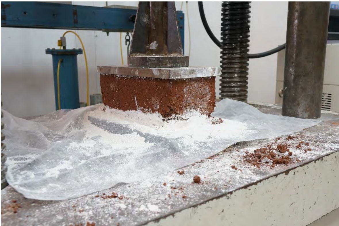
BTC-7 ANTES DE LA PRUEBA A COMPRESIÓN.
