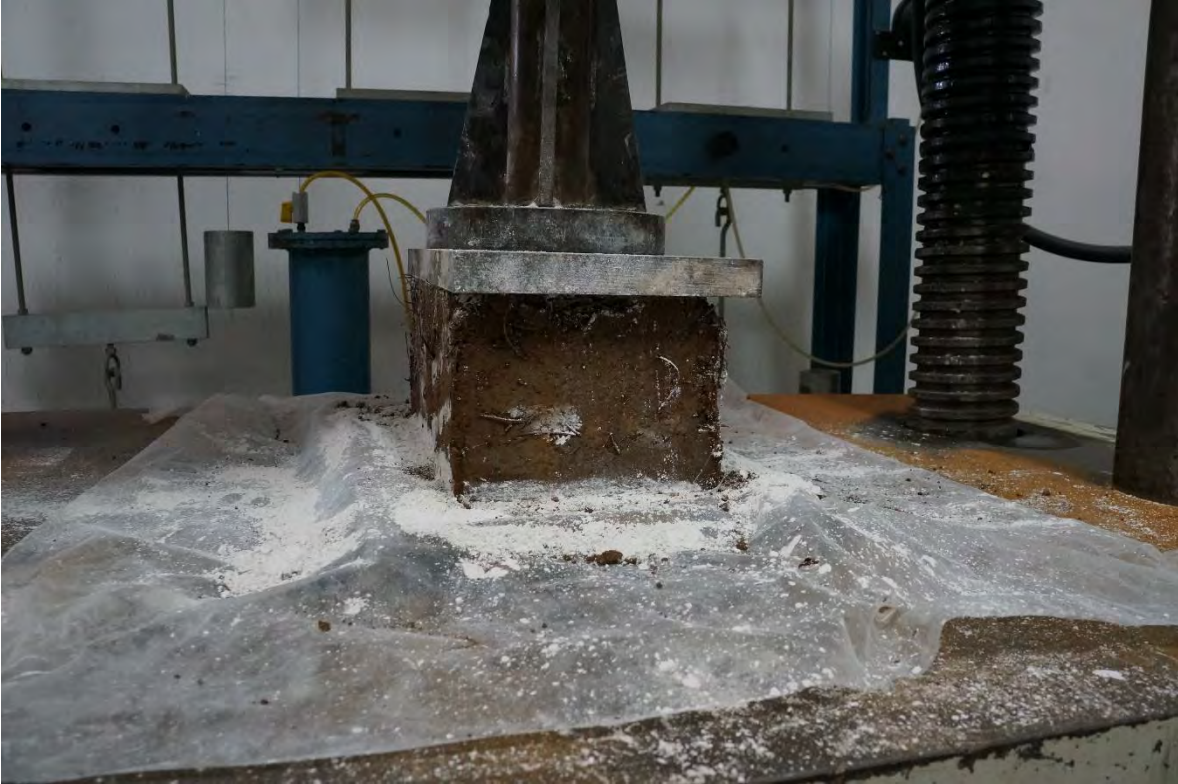
BTC-20 ANTES DE LA PRUEBA A COMPRESIÓN.
