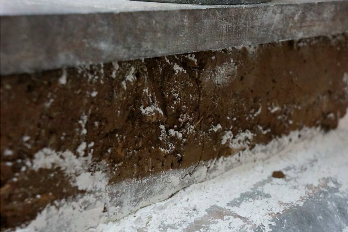
ADOBE-8 DESPUÉS DE LA PRUEBA A COMPRESIÓN.
