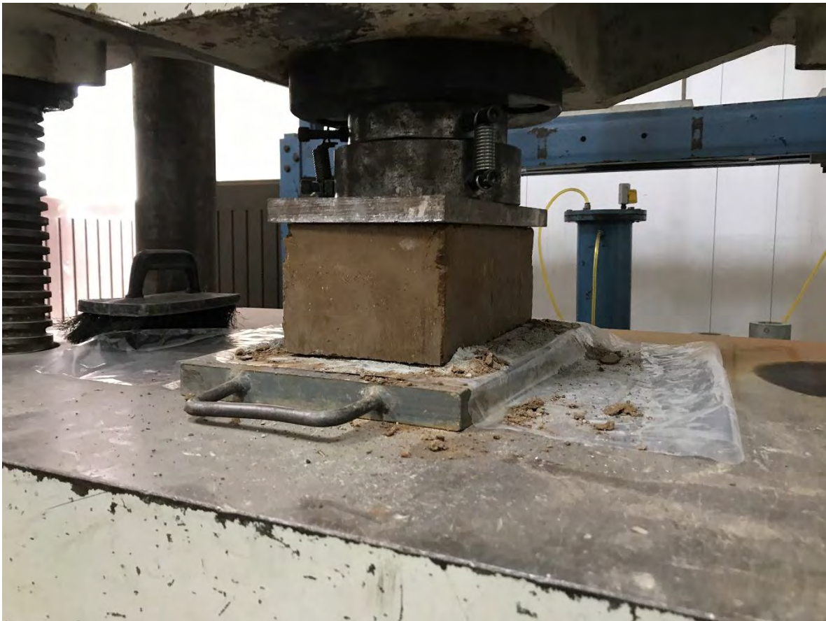
BTC (2)-4 ANTES DE LA PRUEBA A COMPRESIÓN.
