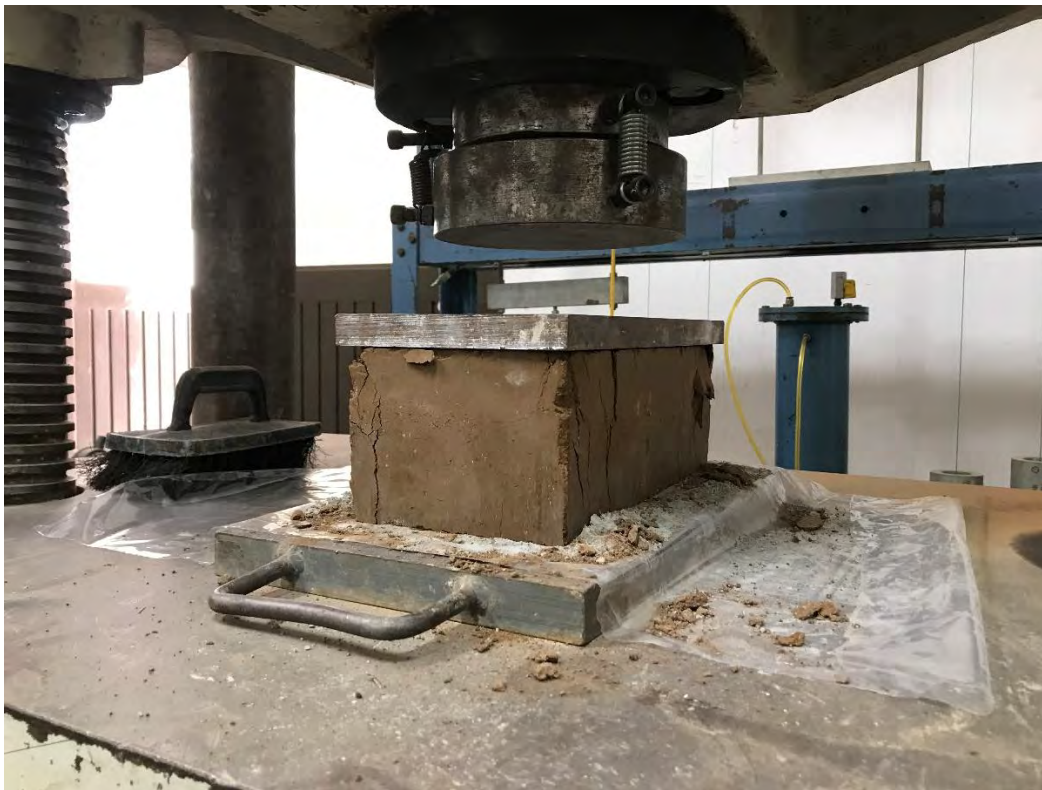
BTC (2)-4 DESPUÉS DE LA PRUEBA A COMPRESIÓN.
