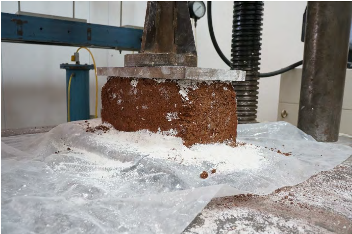
BTC-8 ANTES DE LA PRUEBA A COMPRESIÓN.
