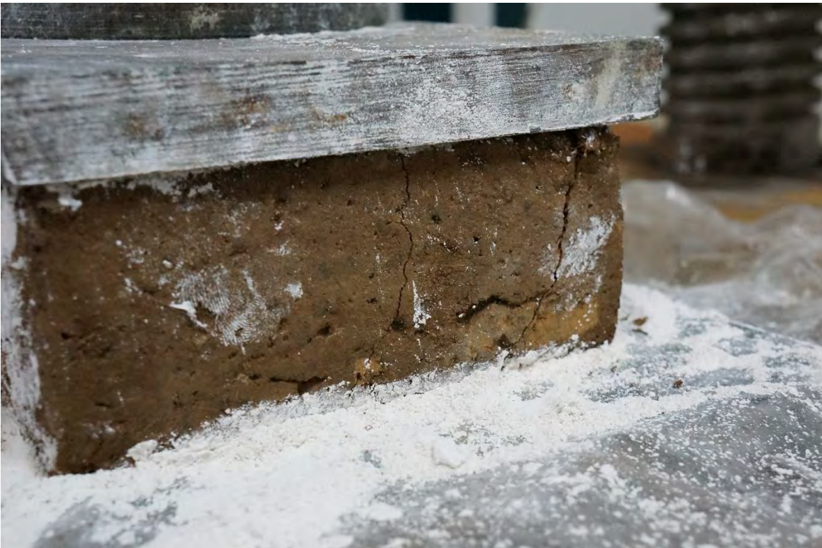
ADOBE-3 DESPUÉS DE LA PRUEBA A COMPRESIÓN.
