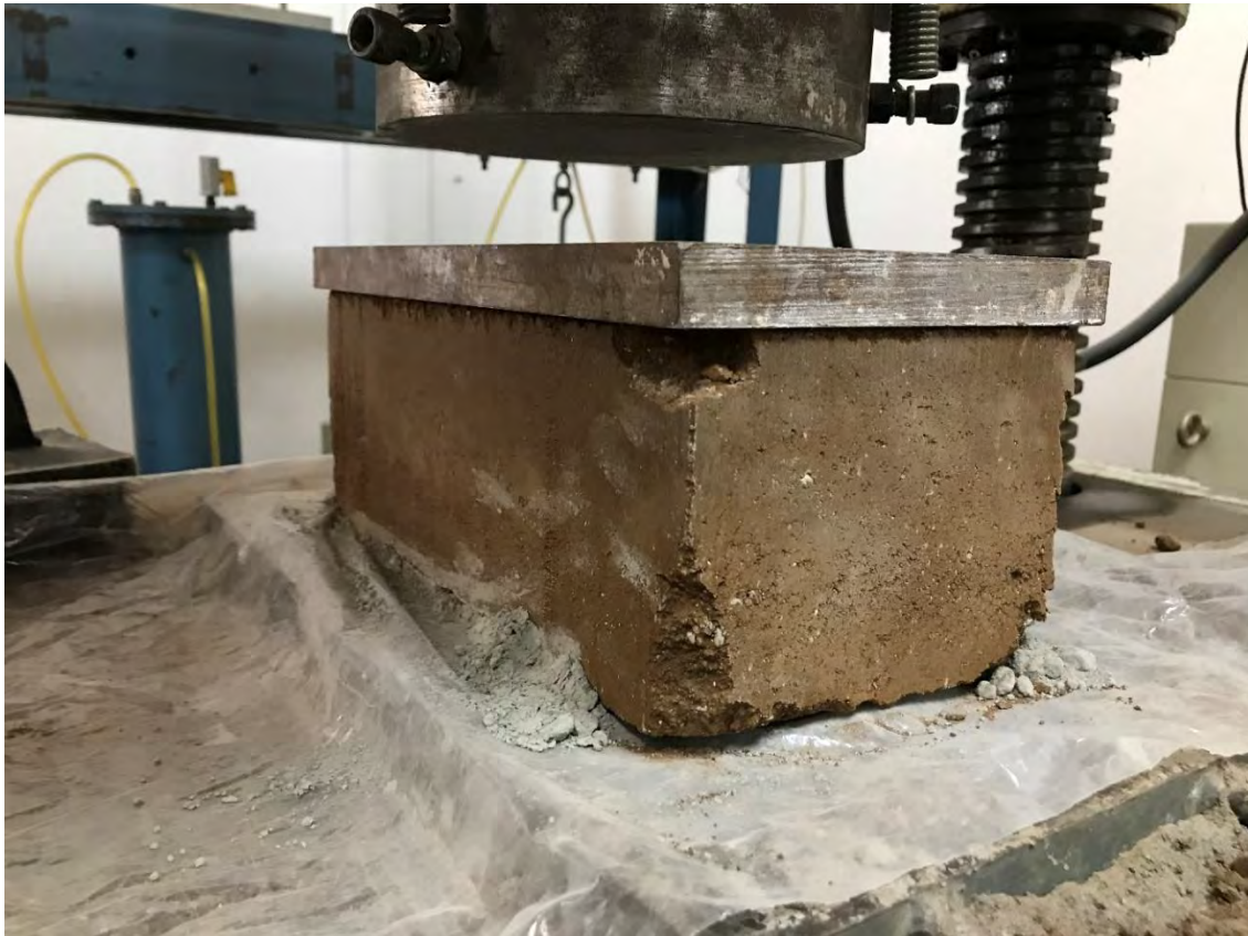
BTC (2)-6 ANTES DE LA PRUEBA A COMPRESIÓN
