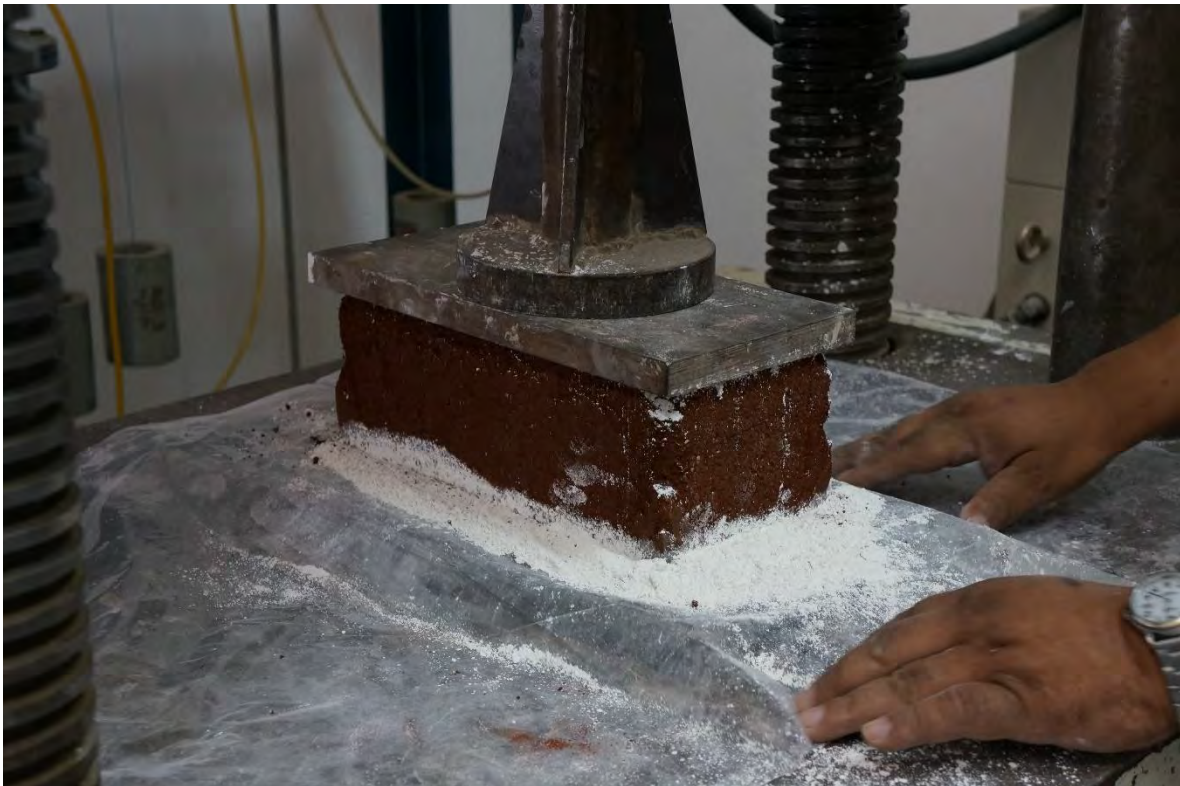
BTC-3 ANTES DE LA PRUEBA A COMPRESIÓN.
