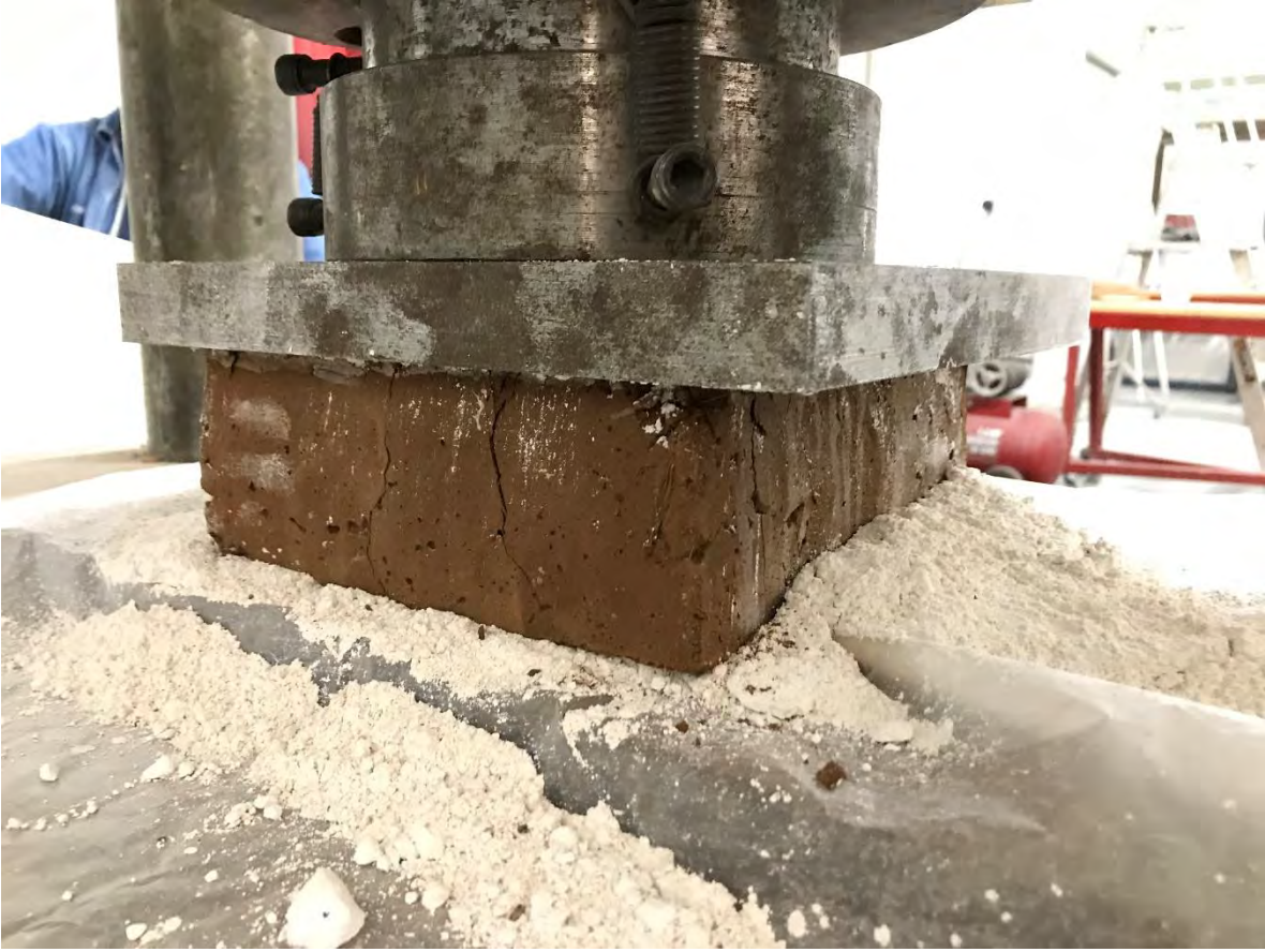
PISO DE TIERRA-3 DESPUÉS DE LA PRUEBA A COMPRESIÓN.
