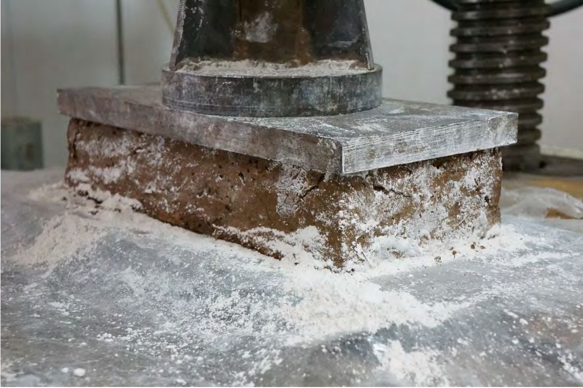
ADOBE-6 DESPUÉS DE LA PRUEBA A COMPRESIÓN.
