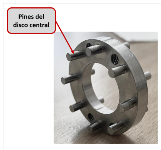
Figura 21 – Disco central maquinado en una sola pieza.
