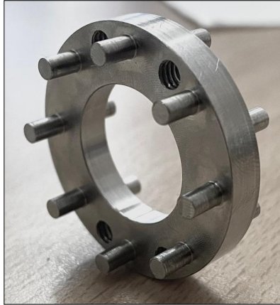
Figura 7 – Disco central maquinado en una sola pieza.
