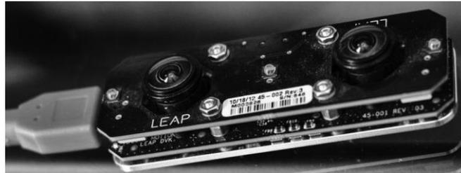
**Figura 2. Se muestran los 2 lentes de las cámaras monocromáticas en conjunto con los 3 LEDs infrarrojos.**
