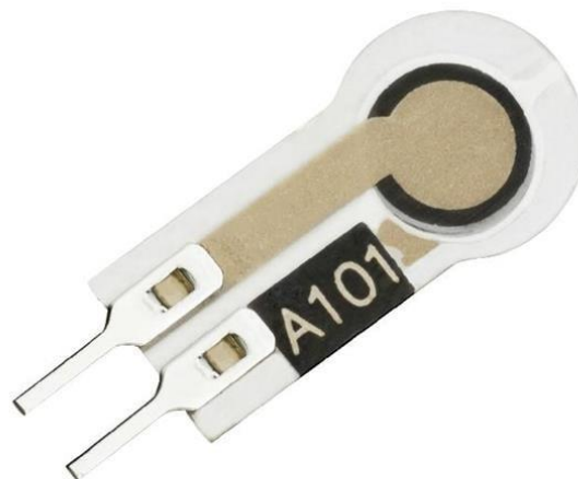
Figura 14. Sensor de presión Flexiforce A101 conectado al Arduino UNO.
