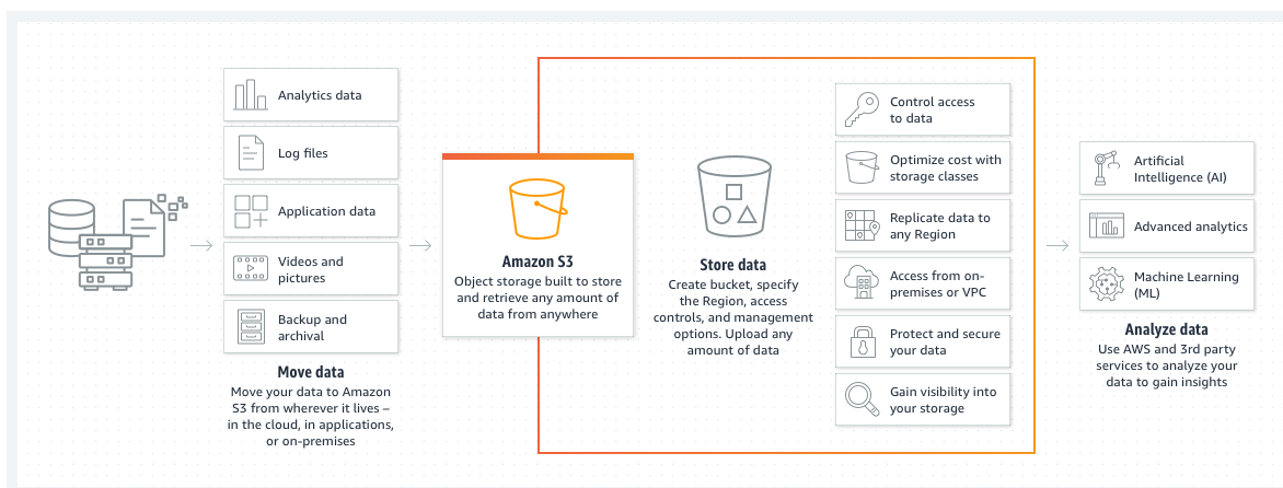
Ilustración 6, Funcionamiento S3 Bucket
