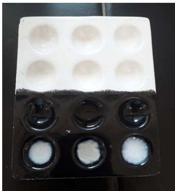
Ilustración 21: Prueba cualitativa positiva de presencia de estaño.
