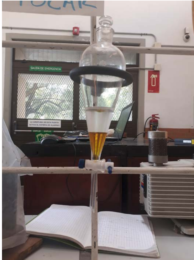
Ilustración 22: Extracción de carbamato de cobre.
