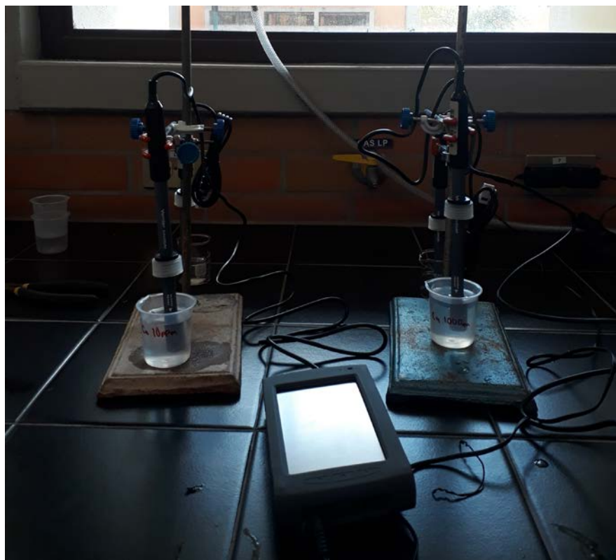
Ilustración 25: Pruebas de ISE vernier de \text{Ca}^{2+} y \text{Cl}^- .
