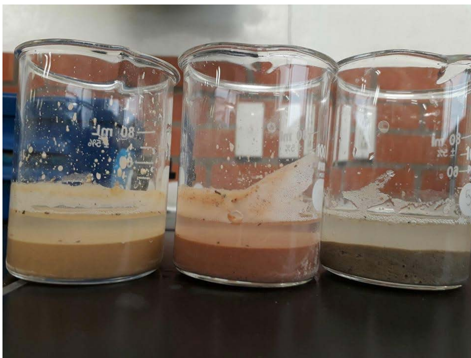
Ilustración 16: : Extracción con solución extractora de Carolina del Norte
