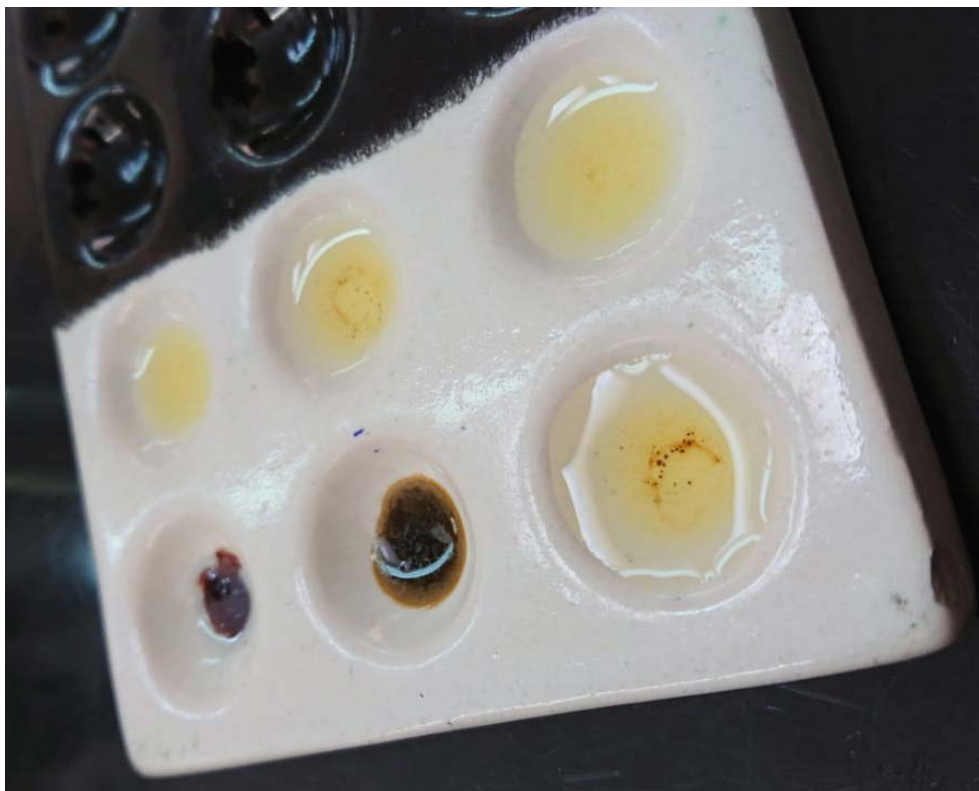
Ilustración 23: Prueba cualitativa positiva de presencia de cobre
