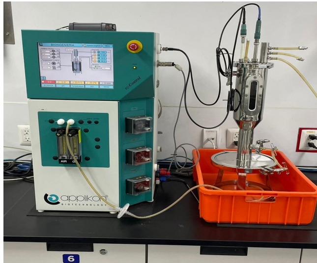
Figura 12. Experimento de escalamiento en biorreactor tipo airlift de 2 L.
