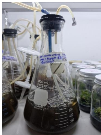
Figura 6. Montaje de biorreactores para la propagación de C. vulgaris en 600 mL de medios con FBA.
