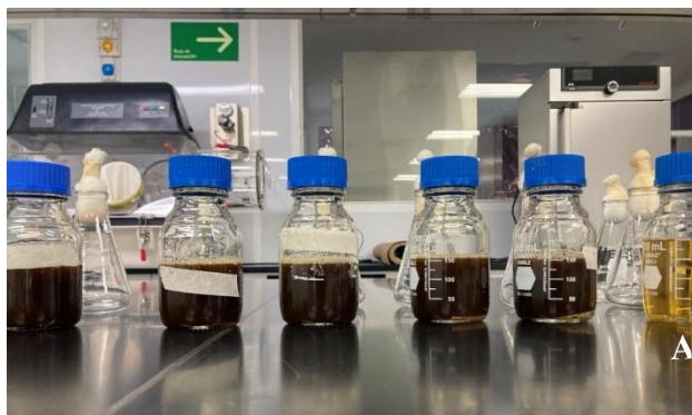
Figura 1. Medios de cultivo formulados con FBA y diferentes concentraciones de peptona y glucosa, así como el caldo MRS (A) en frasco Schott de 250 mL.
