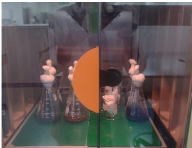
Figura 2. Incubación de medios de tratamientos con L. plantarum a 37^{\circ}\text{C} y 160 rpm en incubadora con agitación mecánica Infors HT Ecotron Incubator.
