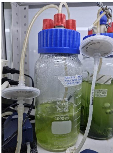
Figura 5. Montaje de biorreactor para la propagación de C. vulgaris en 400 mL de medio basal Bold.
