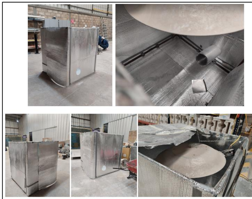
Figura 19 Construcción de la cabina de calentamiento. Fabricación propia dentro de las instalaciones de la planta de botellas.
