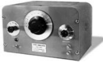
Figura 3 “Oscilador de audio sintonizado por resistencia 200 ª ”, Fuente: (A real gem: HP's audio oscillator patent turns 60, 2002)
