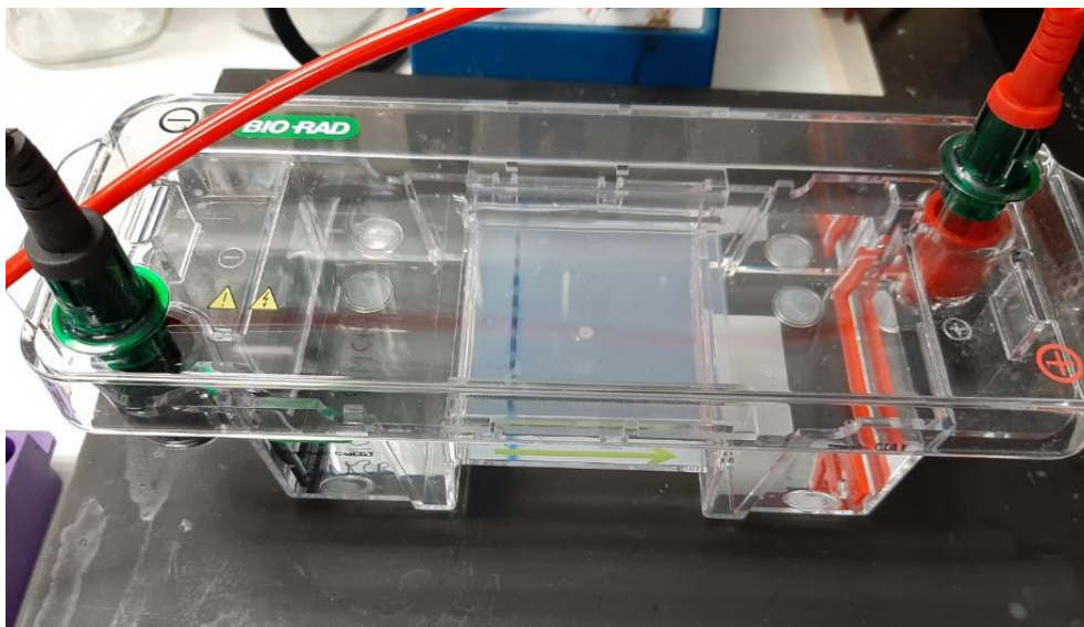
Figura 20 Cámara de electroforesis de 30 ml de la marca BioRad, con gel de agarosa al 0.8%.
