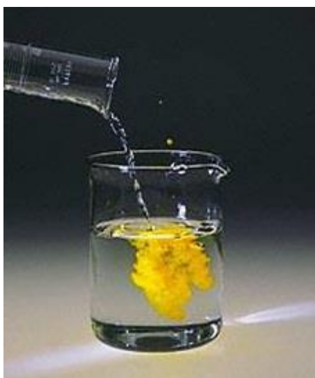
Figura 16 Reacción de precipitación del yoduro de plomo II (tomada de Zamora Plata, s/f)
