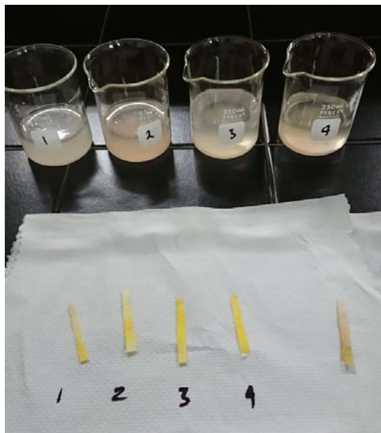
Ilustración 7 Prueba cualitativa para detección de boratos.
