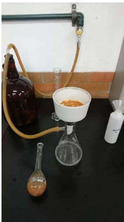
Ilustración 6. Sistema de vacío.
