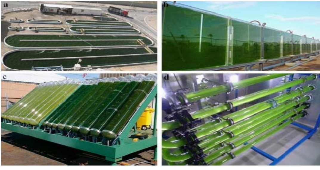
Figura 13. Configuraciones de fotobiorreactores (a.raceway, b.placas planas, c.cilíndricos, d.tubulares horizontales) (Soriano, 2014)
