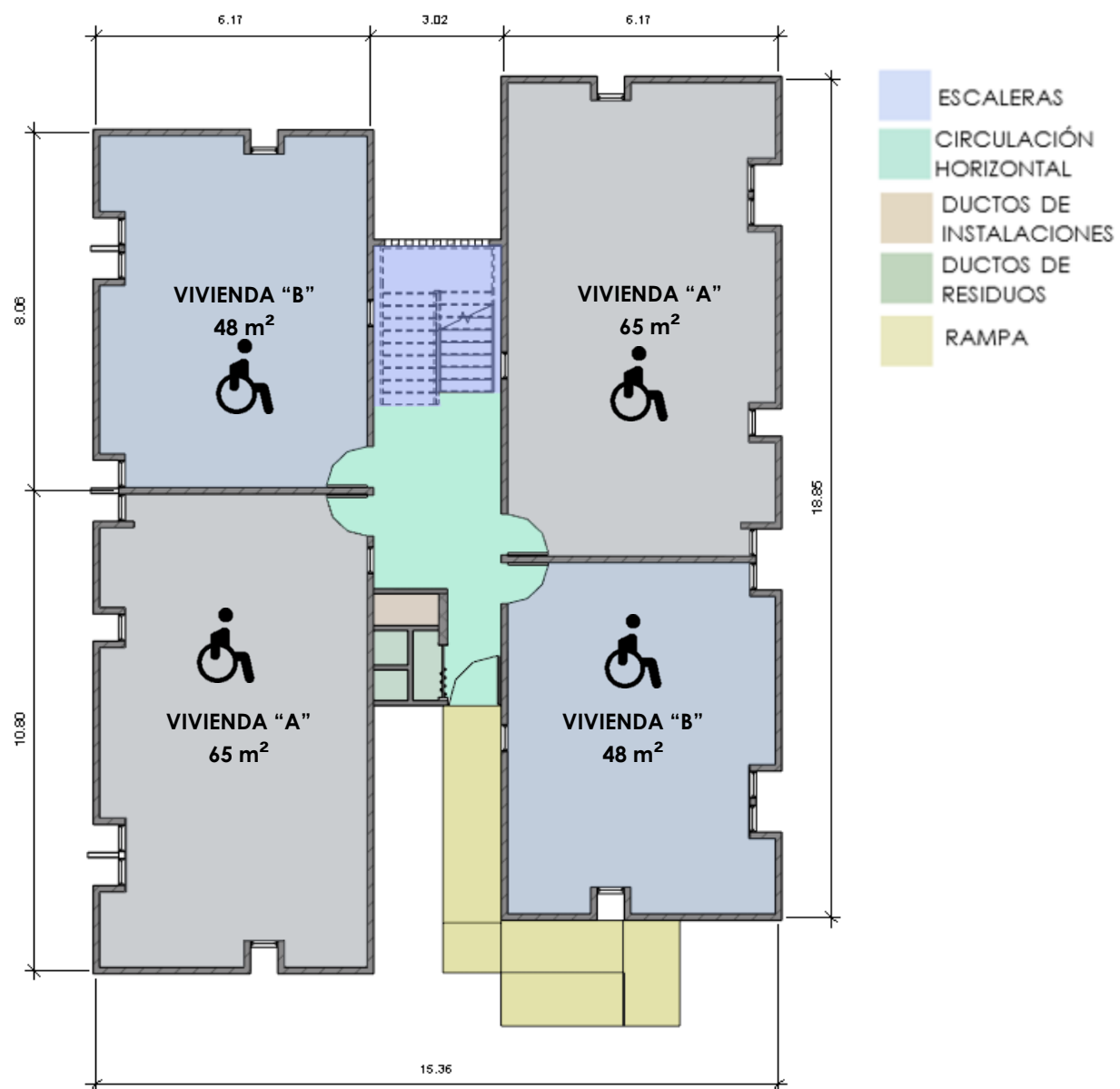
Ilustración 32. Edificio Vivienda Compacta, Planta Baja.
