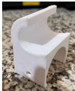
Fig.48 Prototipo pieza “stop”impresa en 3D.
