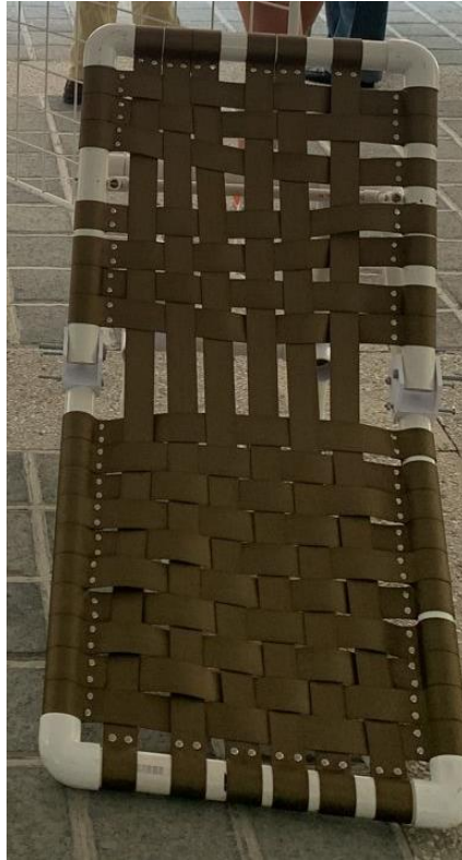
Fig.50 Silla ducha abatible recubierta con tiras de poliéster remachadas sobre los tubulares de PVC.
