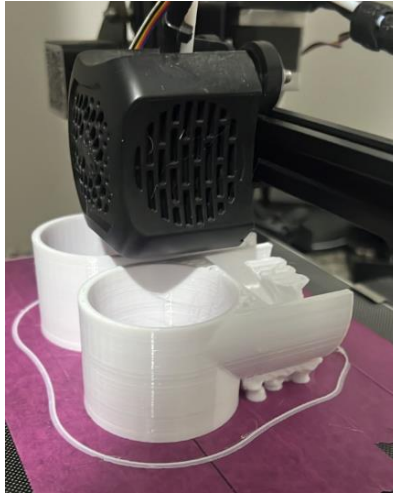
Fig.46 Proceso de impresión de pieza “T”
