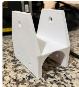
Fig.47. Prototipo pieza “Base de respaldo” impresa en 3D.
