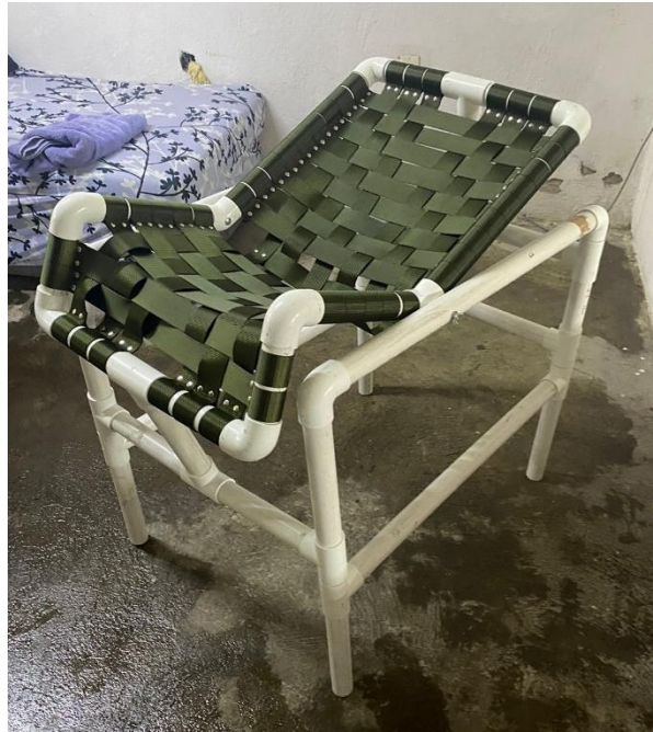
Fig.1 Prototipo de silla ducha de PAP 4D08 primavera 2023
