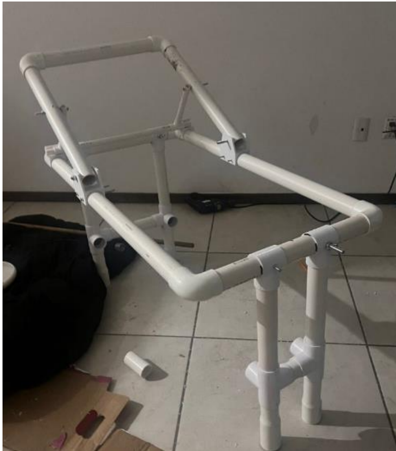
Fig.49 Silla ducha abatible modular ensamblada
