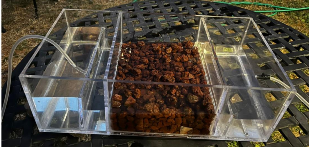
Figura 27 Instalación Final del Humedal
