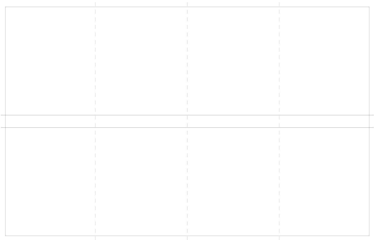
Figura 38. Suaje con guías de corte –continuas– y de doblez –discontinuas–.
