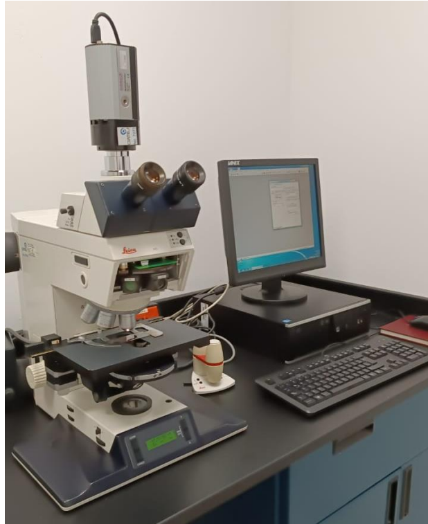
Figura 45. Microscopio de fluorescencia utilizado para observar las laminillas. Se encontraba acoplado a una computadora.
