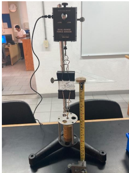
Figura 14.- Ensayo mecánico de elasticidad para muestra realizada con el elastómero PDMS
