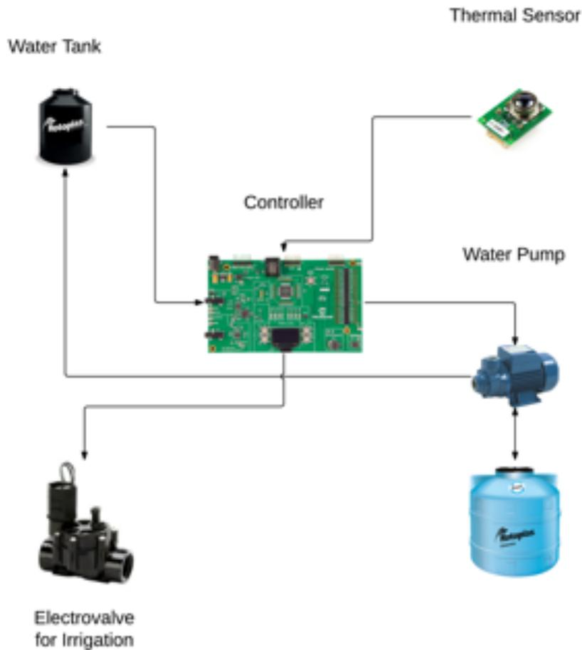
*Fig. 5 Diagrama a Bloques del Sistema de Riego*
