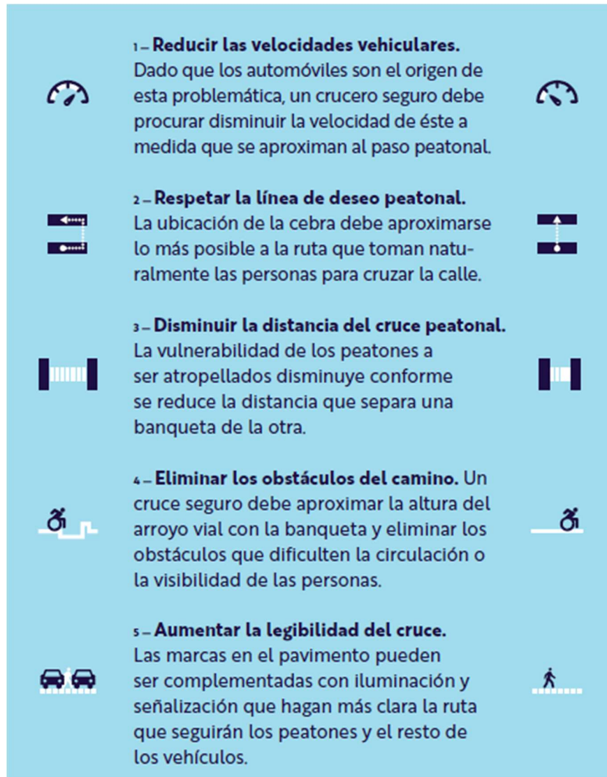
Ilustración 8. Condiciones de un cruce peatonal seguro.
