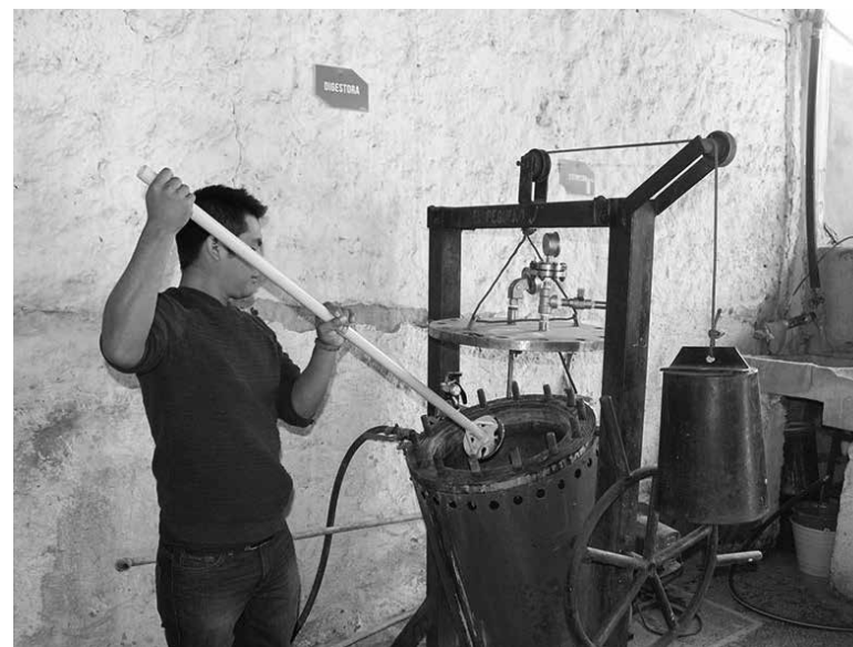
Se fabricó un compactador para mejorar la cargada de la fibra en la digestora.
