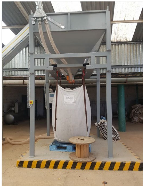
Figura 32, Tolva para el proceso de embolsado del pellet (Biointra 2022).
