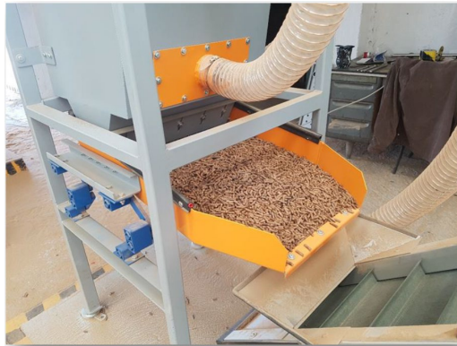
Figura 31, Tolva para el proceso de enfriamiento del pellet (Biointra 2022).
