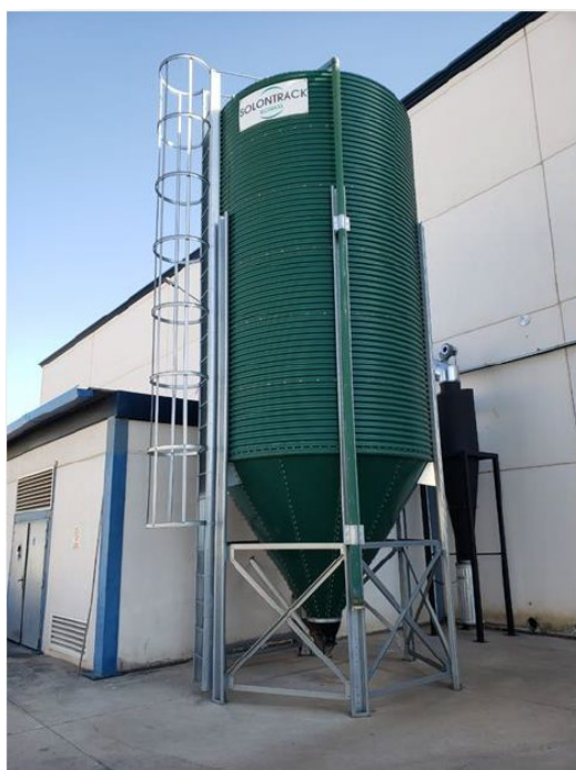
Figura 33, Tolva para el proceso de almacenaje del pellet (Biointra 2022).
