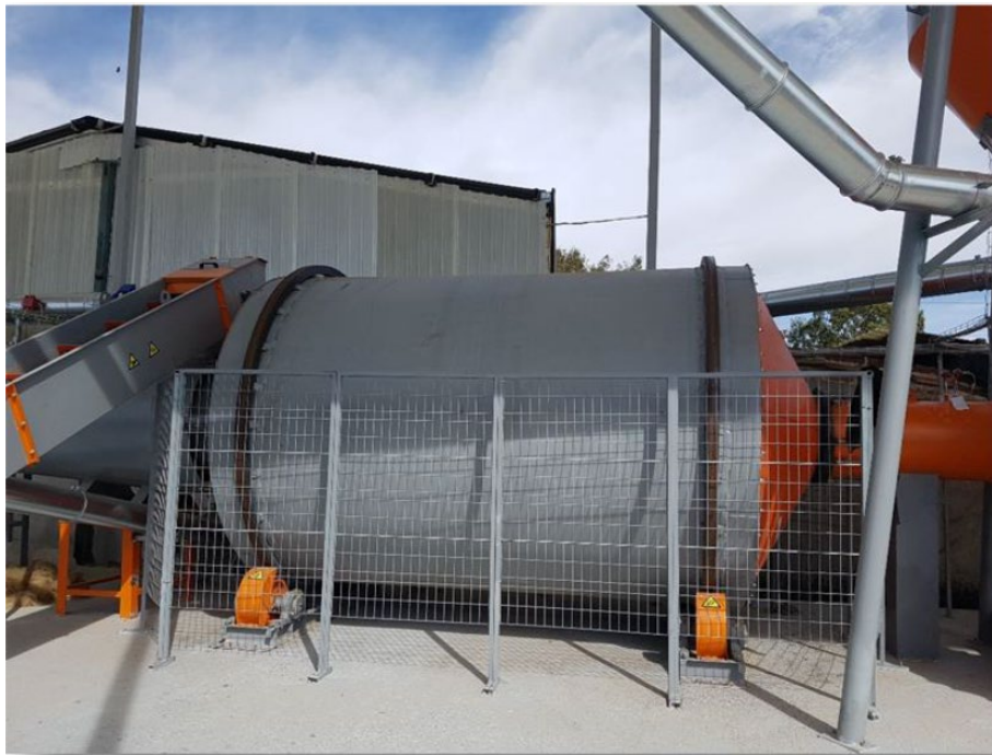
Figura 28, Trombell de secado de tres pasos de la marca Novapellet (Biointra 2022).
