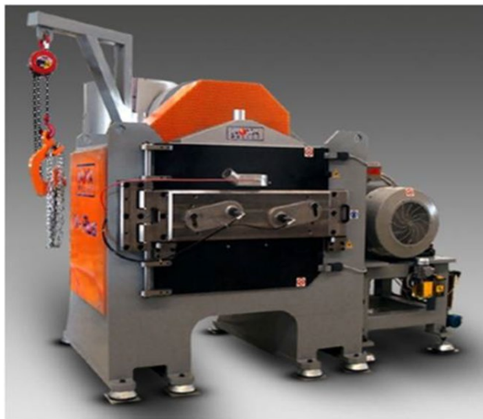
Figura 30, Peletizadora de diferentes capacidades N-Plus (Biointra 2022).
