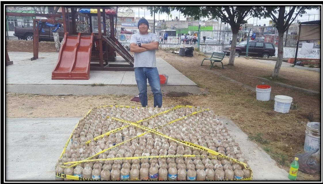
Fotografía 26, Preparación para inmovilizar las muestras para el fraguado.
