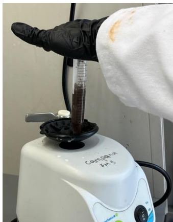
Figura 6. Muestra en vortex para lograr homogeneidad
