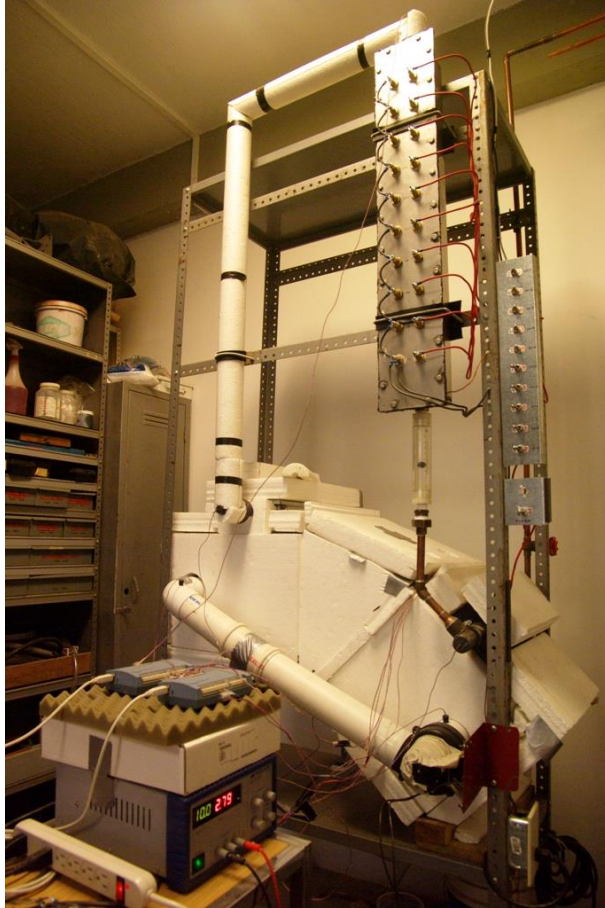
Figura 3.7. El prototipo desalinizador en funcionamiento experimental.
