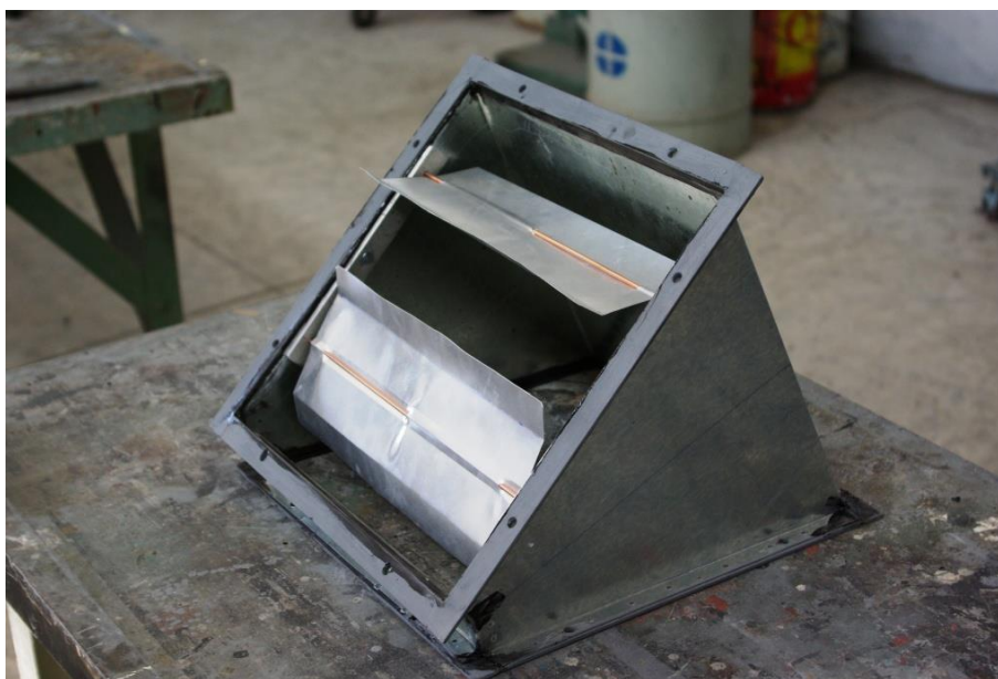
Figura A-VIII.7. El "codo" de 45° que se empleó para inclinar el condensador. La imagen muestra también la primera versión de los "agitadores savonius" que se intentó emplear, sin resultados positivos.
