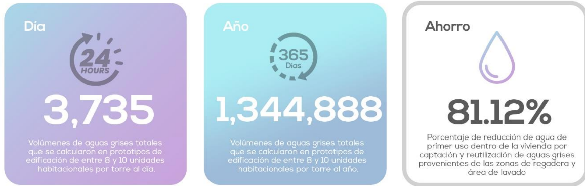
Figura 6.4 Resumen de aguas grises captadas y tratadas dentro de una edificación de 10 unidades
