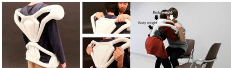
Figura 1 Imagen recuperada del paper “A Review of Exoskeletons Considering Nurses” donde se muestra un exoesqueleto hidráulico que asiste y transfiere a pacientes.
