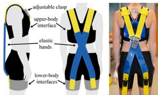
Figura 2 Imagen recuperada del paper “A Review of Exoskeletons Considering Nurses” Se muestra un prototipo bio-mecánico de asistencia mediante bandas elásticas.
