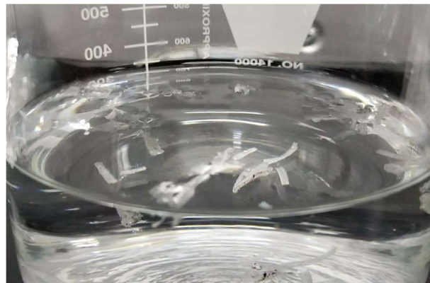
Figura 9. Pellets de almidón termoplástico con sales inmovilizadas.
