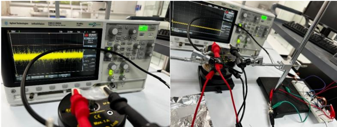
Figura 8 Pruebas fallidas hechas con el piezoelectrico en laboratorio de OPTIMA
