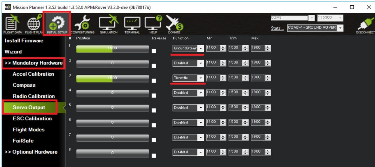
2.1 Configurar el transmisor con el pixhawk: se conectaron el motor y servo respetando los mismos canales del pixhawk siendo la parte de salida principal canal 1 y 3 para poder manipular lo que recibe del receptor R3008SB siendo en modo manual y modo autónomo.
