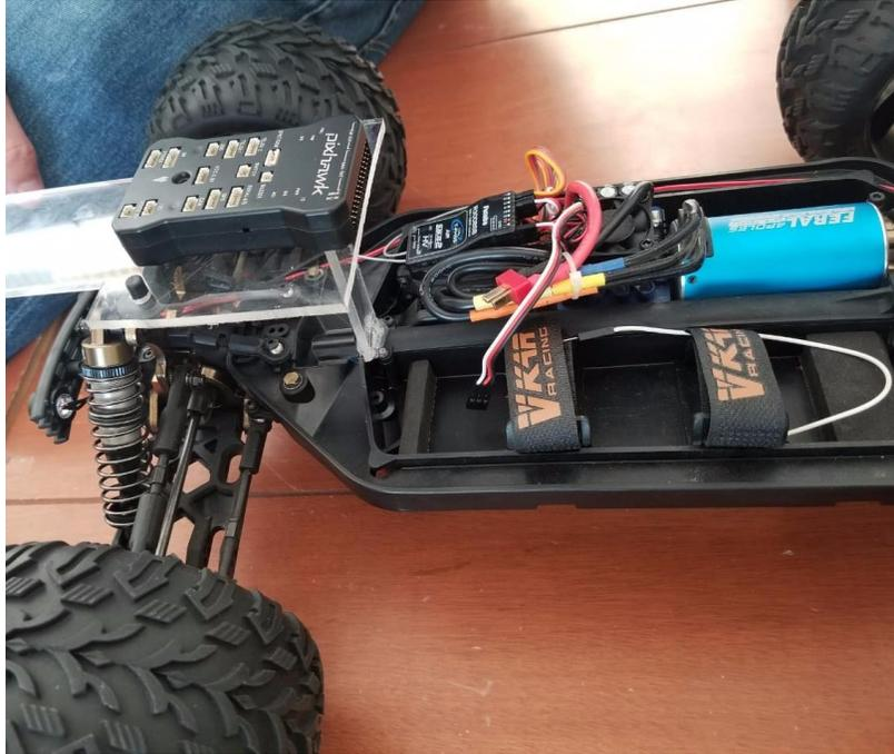
Se hicieron modificaciones poniéndole una placa para amortiguar las vibraciones que podría tener el vehículo, se agregó el buzzer en la parte inferior de la base de acrílico, la antena se colocó a un costado de pixhawk, la base para el GPS se colocó en la parte de enfrente de la base.
