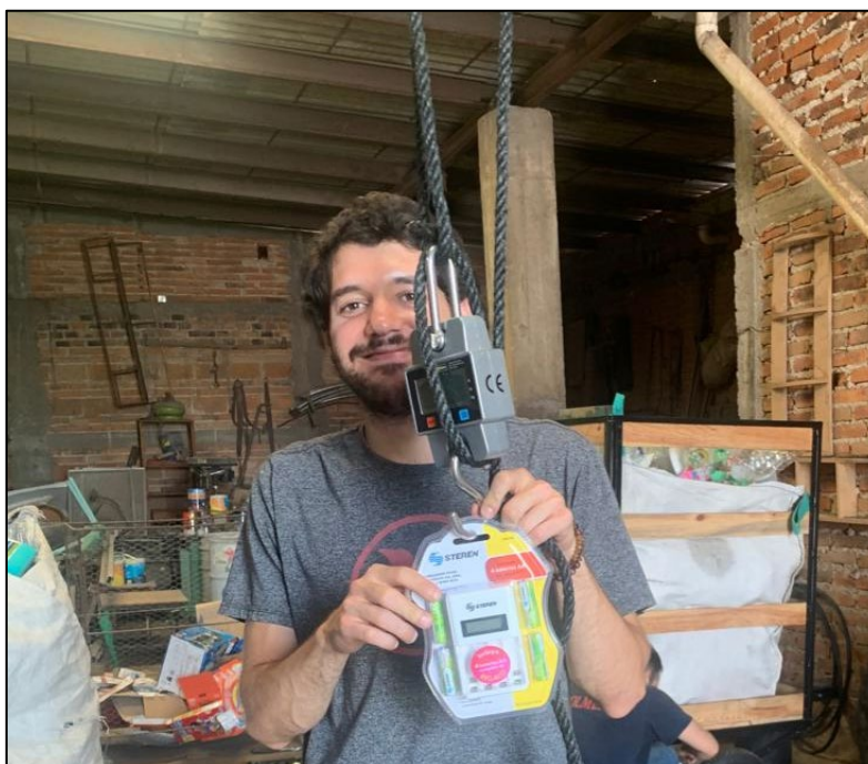
Ilustración 73. Báscula con pilas recargables instalada en el CCARM.
