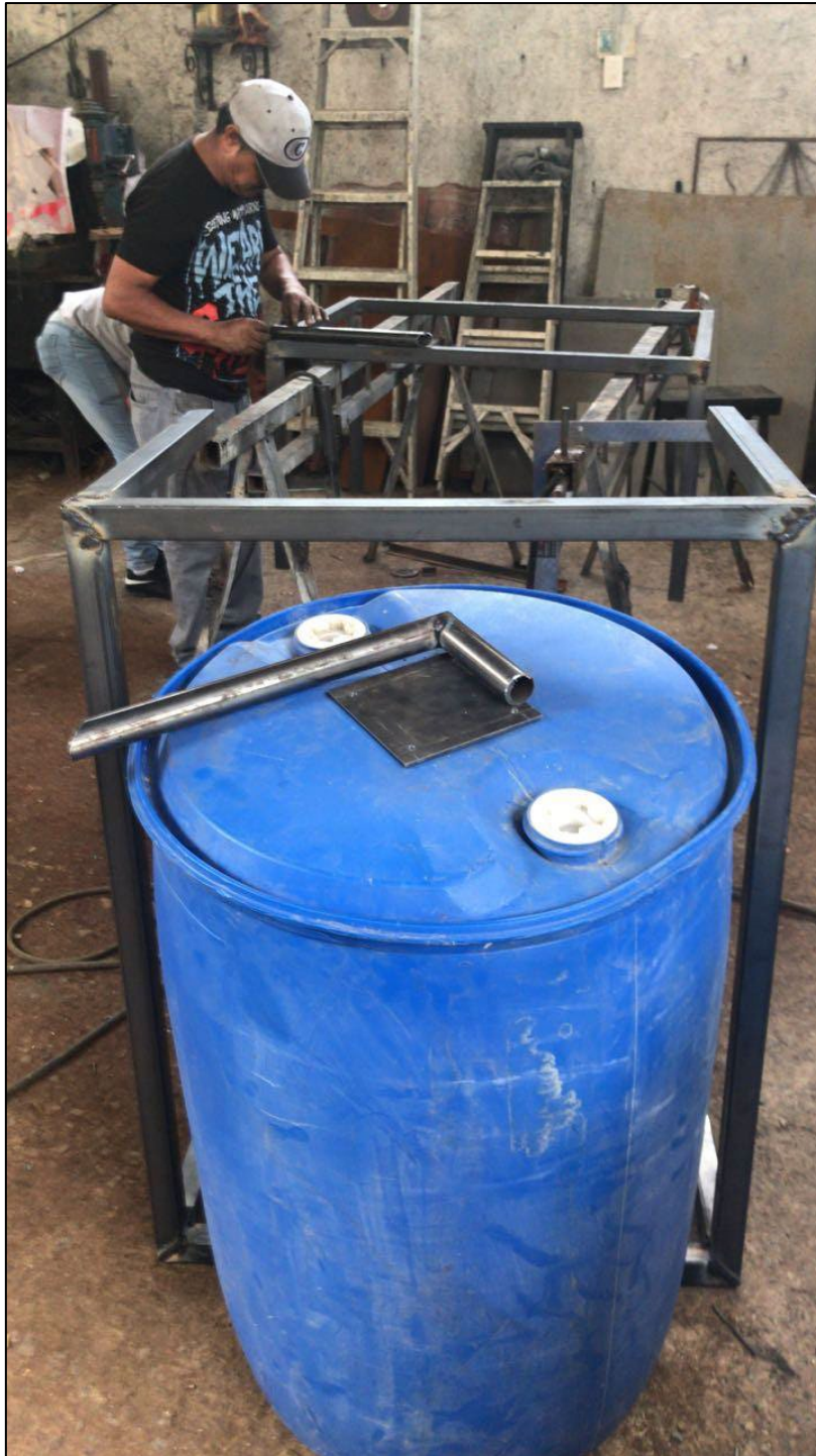
Ilustración 60. Fabricación de los prototipos de 200 L en taller de herrería mecánica. Fotografía de: Marco Antonio Guzmán Munguía.
