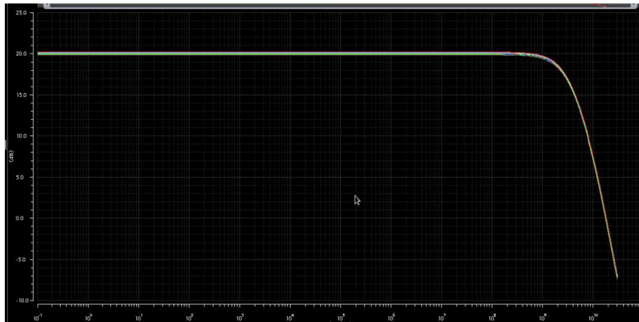
Figura 21. Respuesta en frecuencia amplificador con variacion en Vdd.
