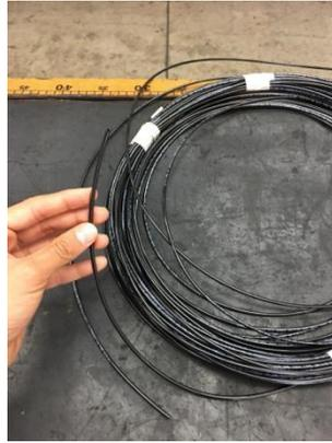
**Imagen 4.3: Manguera de 1/8 diámetro exterior.** El tipo de manguera elegida para llevar a cabo las conexiones entre las válvulas y la pista.
