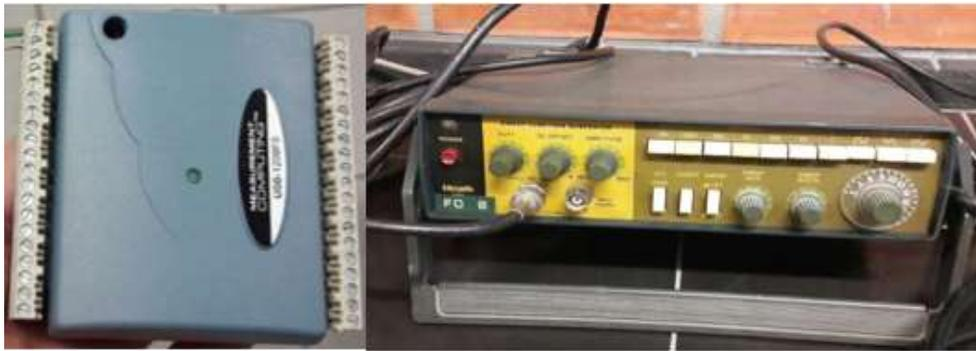
*Ilustración VIII Adquisidor de datos Measurement Computing® (izquierda) y generador de funciones (derecha)*
