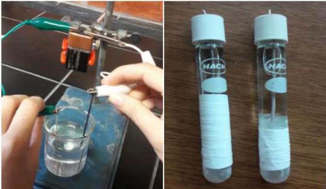
*Ilustración XII Fabricación de electrodos por método electroquímico (izquierda), Electrodos de Ag/AgCl terminados (derecha)*
