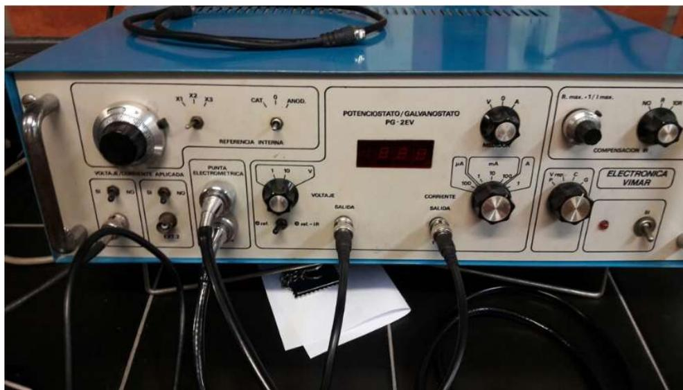
*Ilustración VII Potenciostato-Galvanostato marca Electrónica Vimar*
