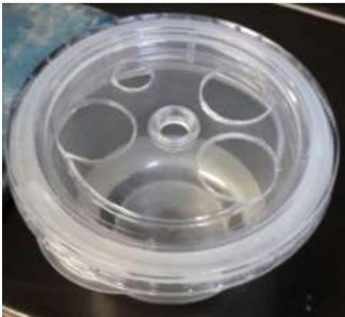
*Ilustración X Celda de tres electrodos terminada*
