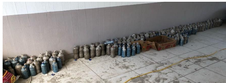
Imagen. 2. Botellas en proceso de fraguado, aproximadamente 28 día para alcanzar su máxima resistencia.
